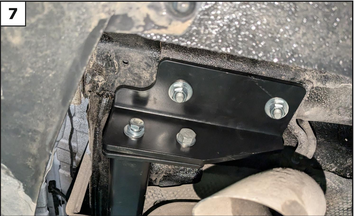
Прогнать резьбовые отверстия балки (1) с помощью метчика М12х1,25. К установленным кронштейнам (4 и 5) закрепить балку (1) с помощью болтов М12х1,25х40 (9), шайб 12 пружинных (16), шайб 12 (15) и гаек М12х1,25 (12).
