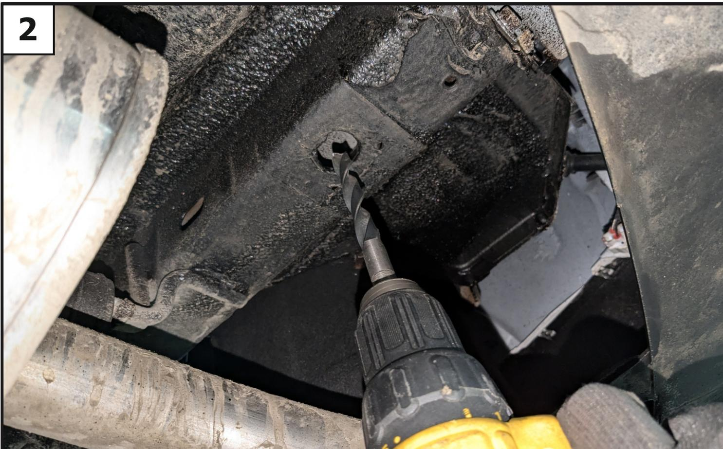
**Для удобства сверления снять глушитель с подвесов. Через отверстие в лонжероне просверлить пол багажника сверлом диаметром 12 мм. С другой стороны аналогично.**
