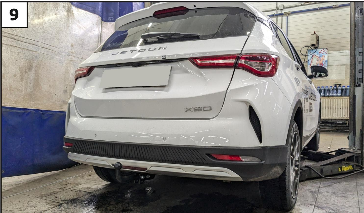
**Установить обшивки багажника в обратной последовательности. Установить кронштейн под розетку (3) и крюк (2) с помощью болтов M12x1,25x70 (10), шайб 12 (15), шайб 12 пружинных (16) и гаек M12x1,25 (12). Затянуть резьбовые соединения. Момент затяжки: M12=81 Нм.**
