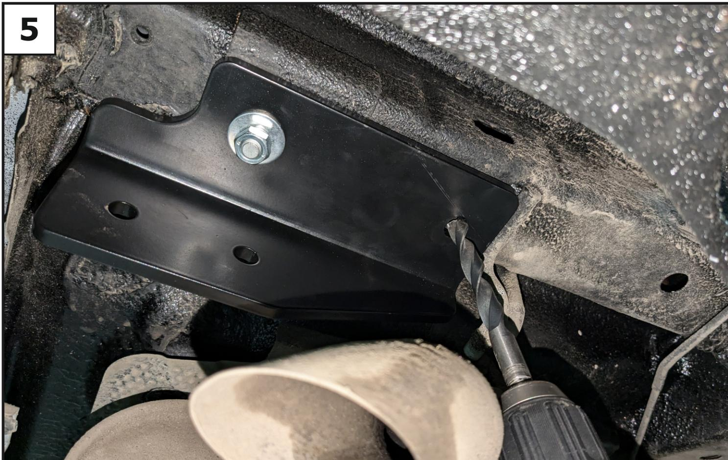
Выставить кронштейны параллельно лонжеронам. Через дальние отверстия в кронштейнах просверлить лонжероны и пол багажника сверлом диаметром 12 мм.
