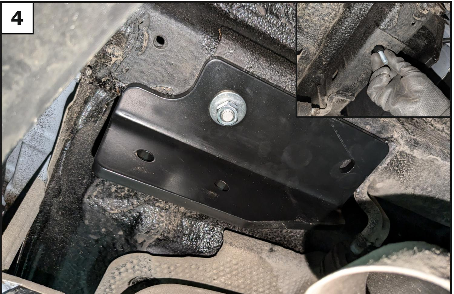
Закрепить правый и левый кронштейны (4 и 5) совместно с втулками (7) с помощью гаек М10 (11), шайб 10 пружинных (13) и шайб 10 увеличенных (14).
