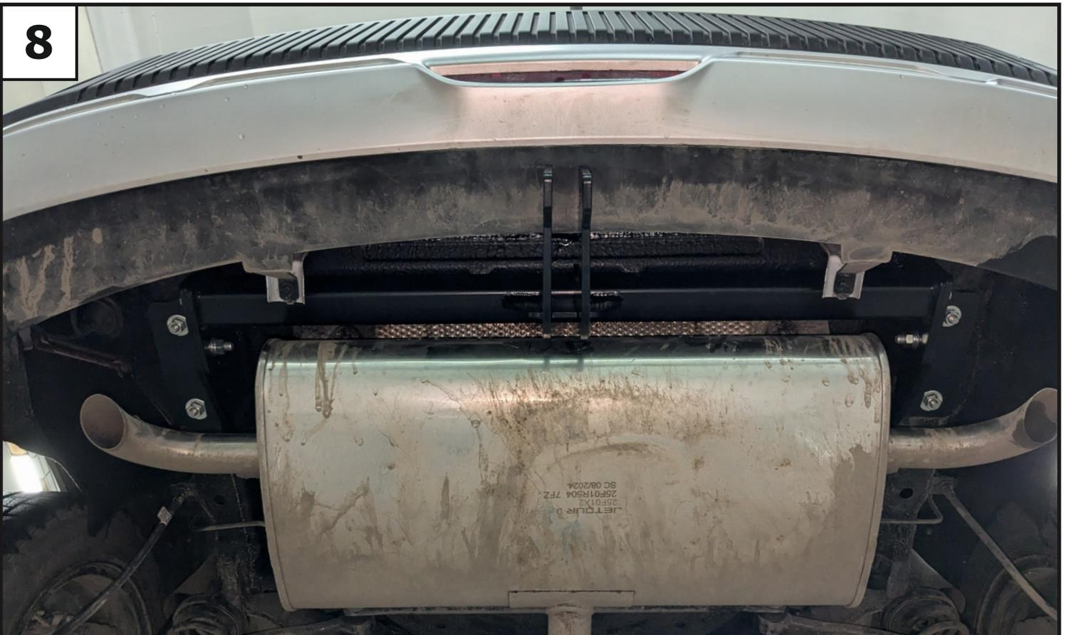
Отрегулировать положение ТСУ относительно центра автомобиля. Затянуть все резьбовые соединения: сначала балку с кронштейнами, затем кронштейны с лонжеронами автомобиля. Моменты затяжки: М10=47 Нм, М12=81 Нм. Установить глушитель на подвесы.
