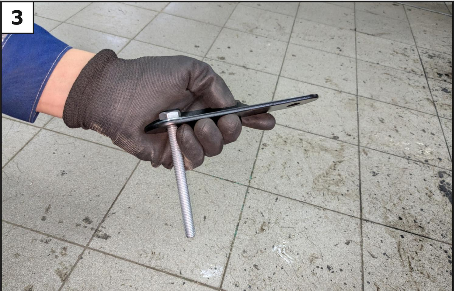
Со стороны багажного отделения в просверленные отверстия установить болты М10х110 (8) с помощью пластин (6) и шайб 10 увеличенных (14).
