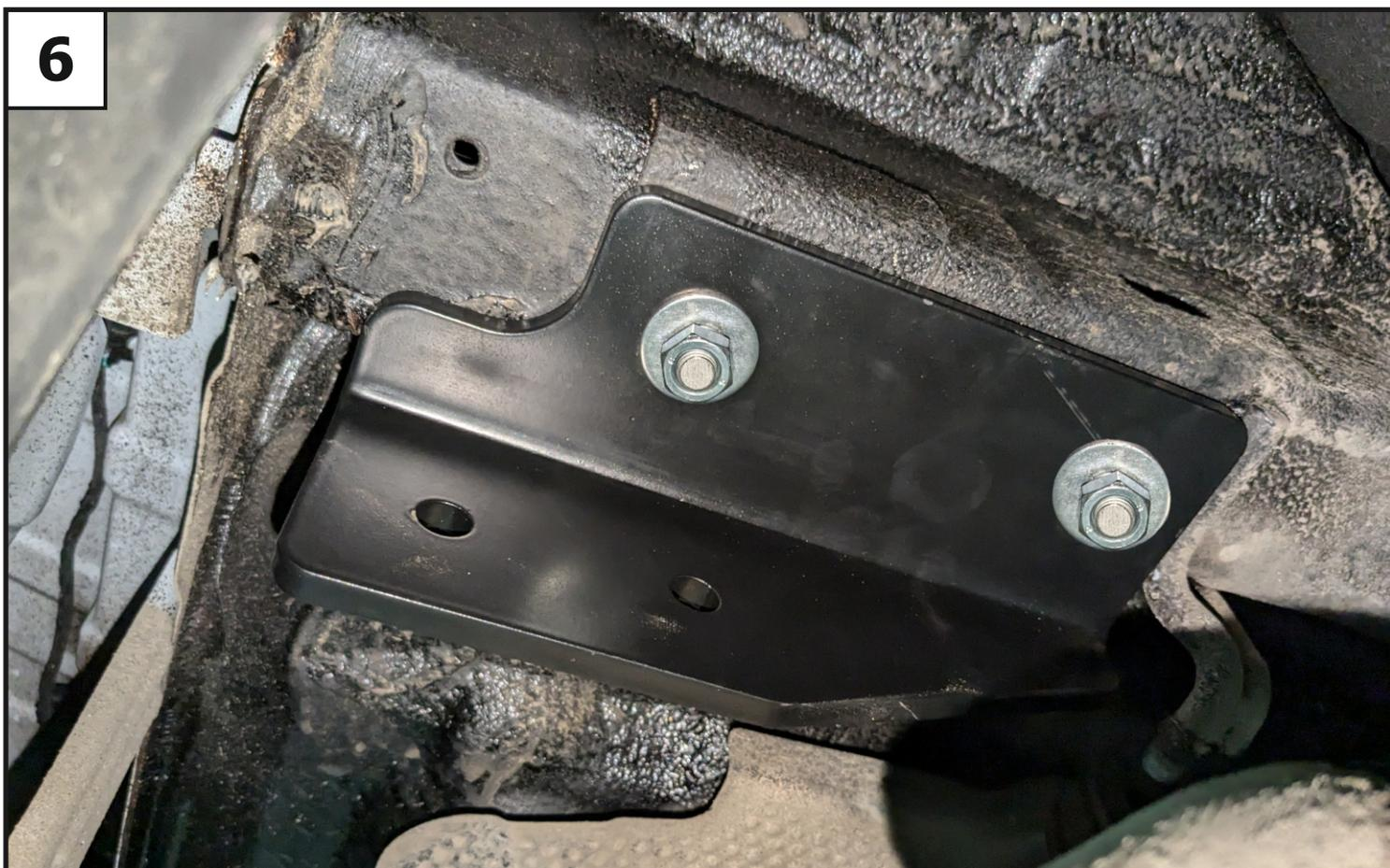
Со стороны багажного отделения рассверлить полученные отверстия до диаметра 20 мм. Закрепить кронштейны (4 и 5) с помощью втулок (7), болтов М10х110 (8), шайб 10 пружинных (13), шайб 10 увеличенных (14) и гаек М10 (11).
