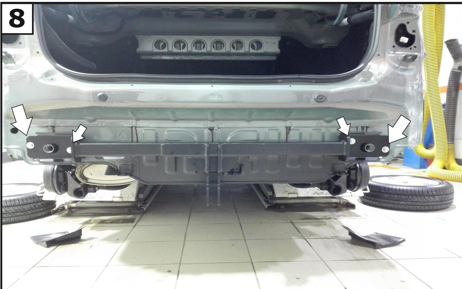
Установить балку (1) используя болты М8х30 (5), шайбы 8 увел. (11), шайбы 8 пружинные (10). При необходимости использовать гайки М8 (8).
