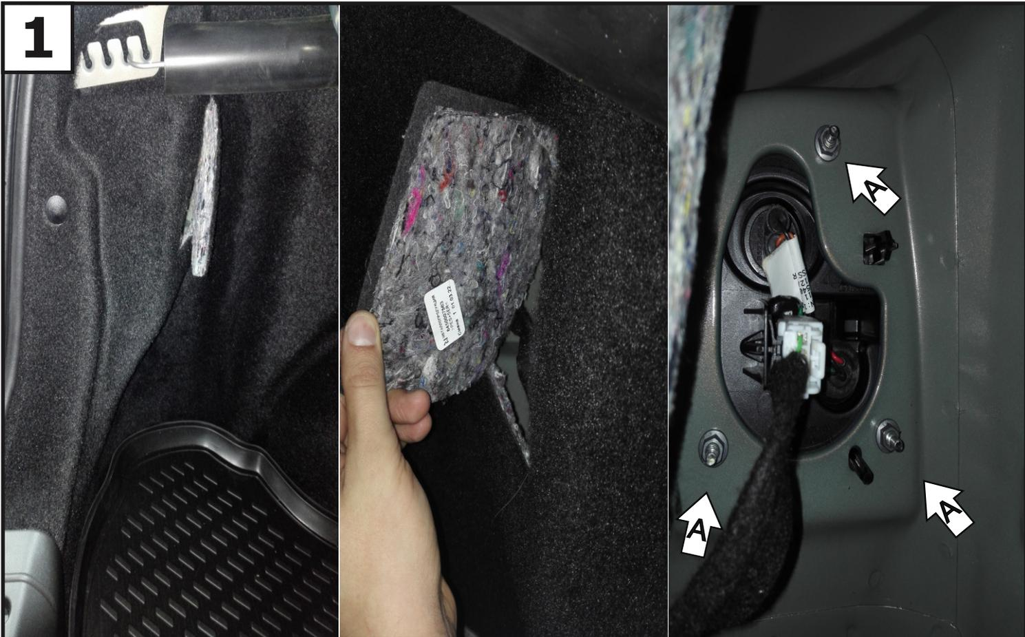
**1** Открутить 3 гайки (А) крепления левого и правого задних фонарей через лючки в обшивке багажного отделения.
