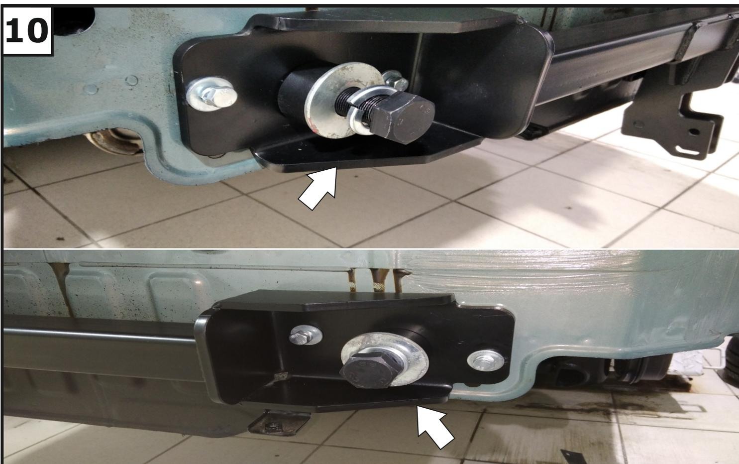
**Закрепить установленную балку (1) с помощью болтов M22x1,5x60 (7), шайб 22 пружинных (14) и шайб 22 увел. (15).**
