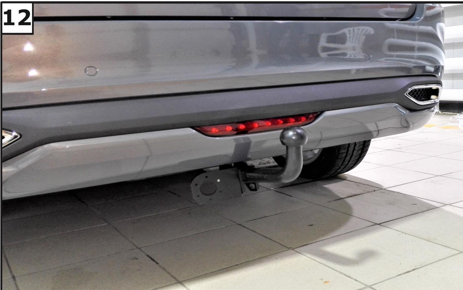
Установить подрозетник (4) и крюк (3) с помощью болтов M12x1,25x70 (6), шайб 12 пружинных (12), шайб 12 (13) и гаек M12x1,25 (9).
