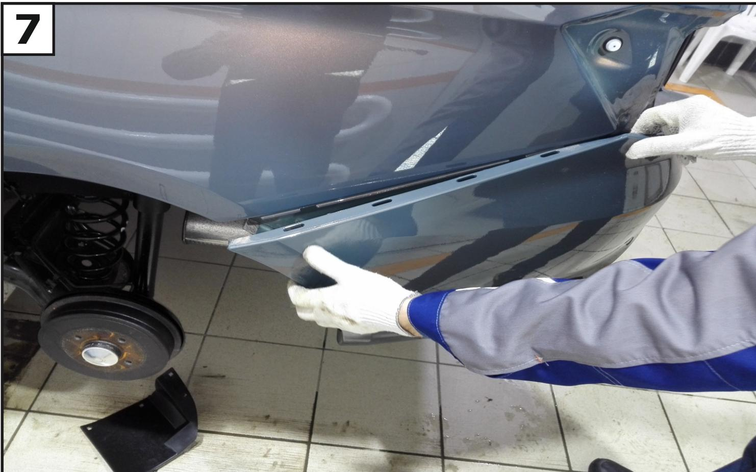
Отщелкнуть защелки крепления бампера с левой и правой стороны. После демонтировать бампер с автомобиля.
