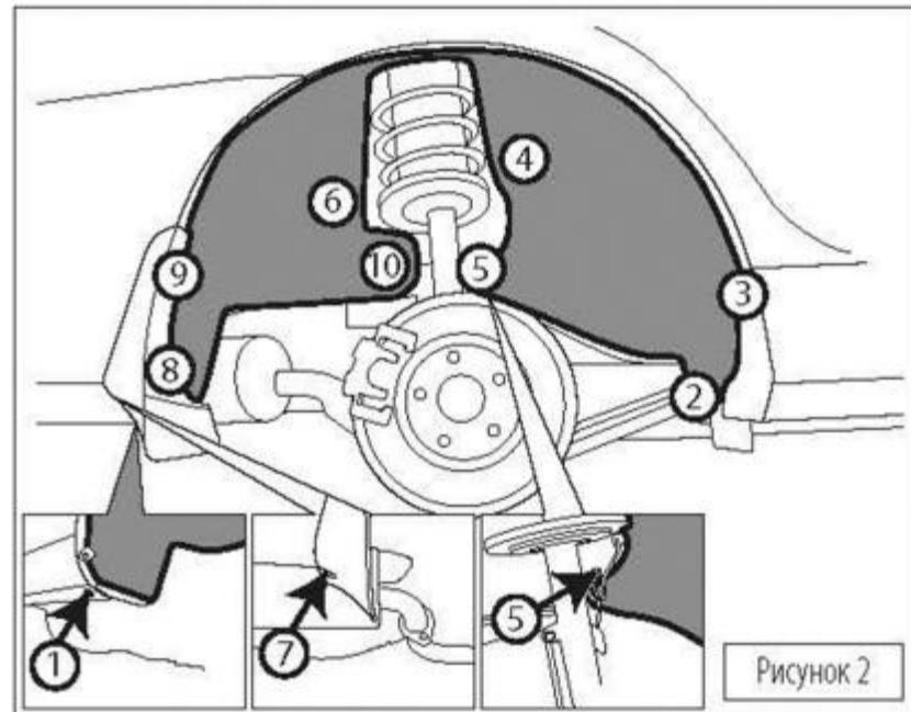
Снять колесо. Демонтировать штатные крепежные элементы в точках, отмеченных черными кругами на рисунке 1. Снять штатный брызговик, произвести демонтаж самореза в точке 9.
