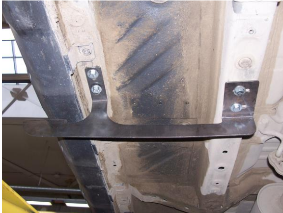
Рис.4 Установка переднего кронштейна
