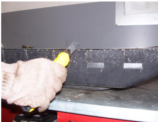
Рис.6 Пазы в пластиковом пыльнике
