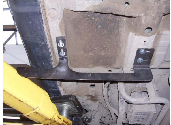
Рис.5 Установка заднего кронштейна
