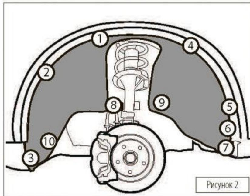
Зафиксировать подкрылок, используя элементы штатного крепежа соблюдая последовательность, указанную на рисунке 2 в кругах белого цвета.
