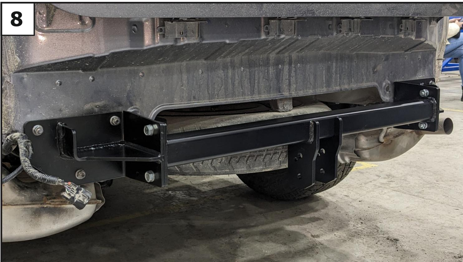
Установить балку (1), закрепив её к кронштейнам с помощью болтов М10х1,25х30 (14), шайб 10 пружинных (28), шайб 10 (29) и гаек М10х1,25 (22). Отрегулировать положение балки относительно центра автомобиля. Затянуть все резьбовые соединения: сначала балку с кронштейнами, затем кронштейны с задней панелью, потом с лонжеронами. Моменты затяжки: М10=47 Нм; М12=81 Нм.
