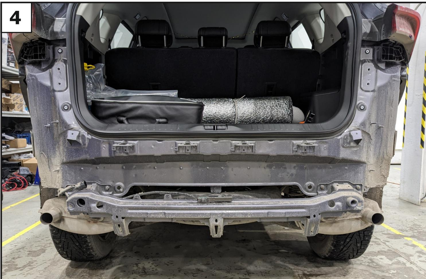
**Снять задний бампер, отключив разъем электропроводки.**
