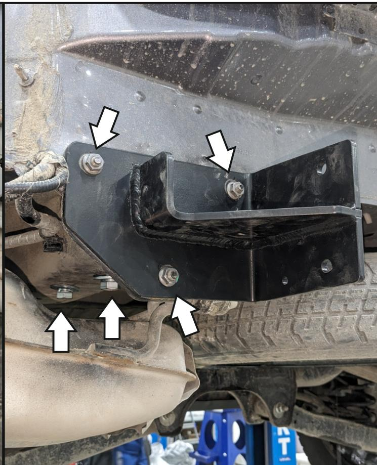
Установить кронштейн левый (2) в лонжерон, закрепив его с помощью штатных гаек, болтов М12х1,25х40 (15), шайб 12 пружинных (30) и шайб 12 увел. (31). Кронштейн правый (3) установить аналогично.
