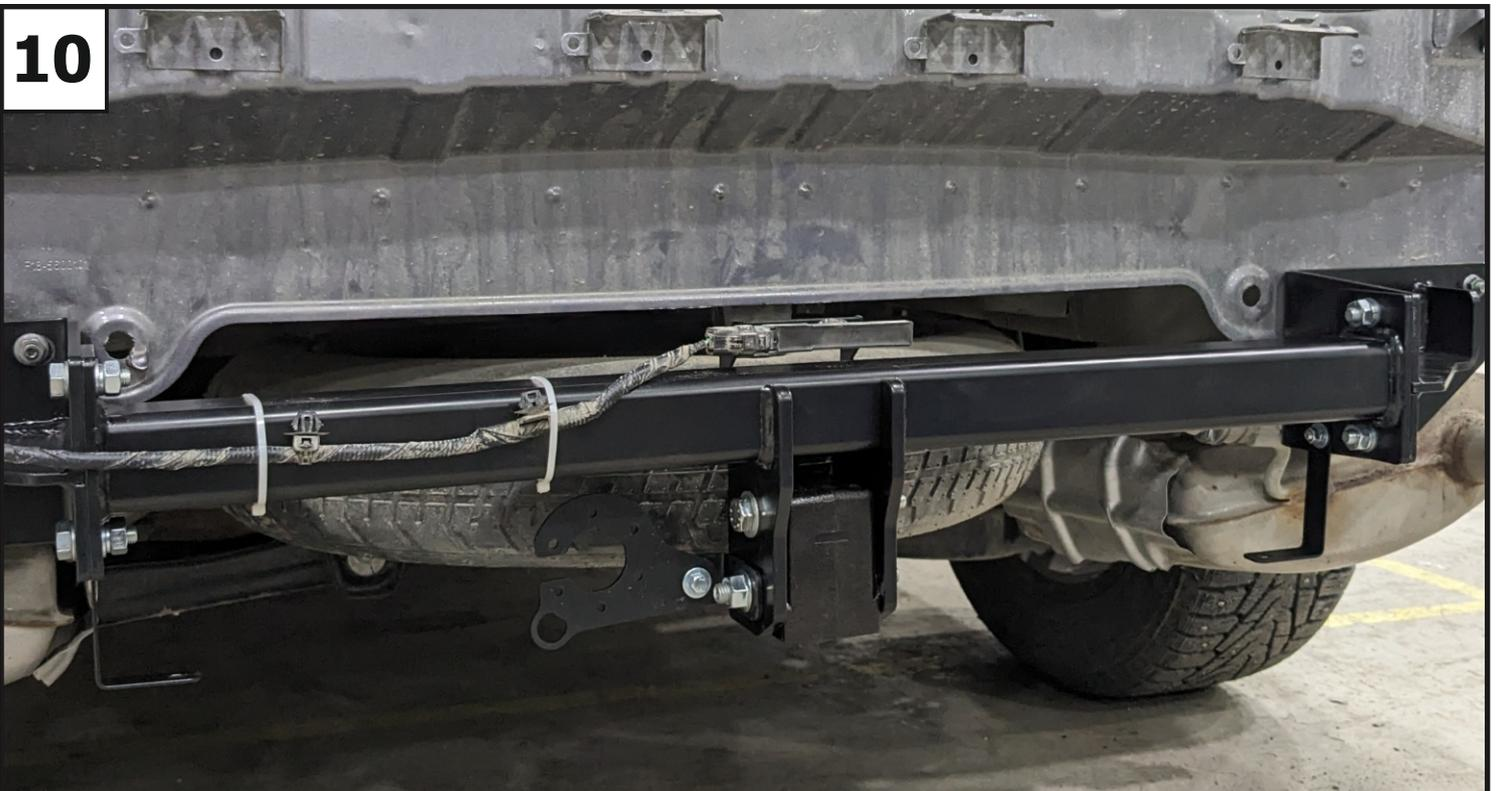
Установить ответную часть быстросъёма и уголок (8) с помощью болта М12х100 (16), шпильки М12х25 (18), шпильки М12х35 (19), шайбы 12 с насечками (32) и гаек М12 с фланцем (23). Установить подрозетник (9) с помощью болта М6х25 (13), гайки М6 самоконт. (21), шайб 6 увеличенных (26) и шайб 6 полиамидных (27). Затянуть все резьбовые соединения: сначала быстросъем к балке, затем подрозетник к уголку. Моменты затяжки: М6=6 Нм; М12=81 Нм.
