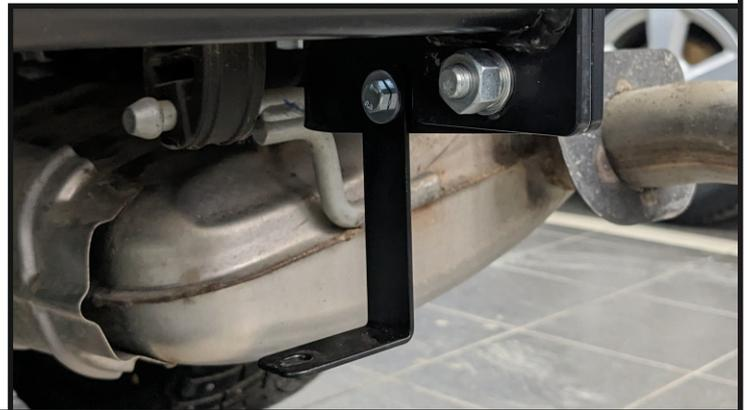
Установить кронштейн антенны (7) и кронштейны бампера (6), закрепив их с помощью болтов М6х20 (12) (кронштейны бампера), болтов М6х25 (13) (кронштейн антенны), шайб 6 пружинных (24), шайб 6 (25), шайб 6 увел. (26) и гаек М6 (20). Затянуть все резьбовые соединения. Моменты затяжки: М6=10 Нм.
