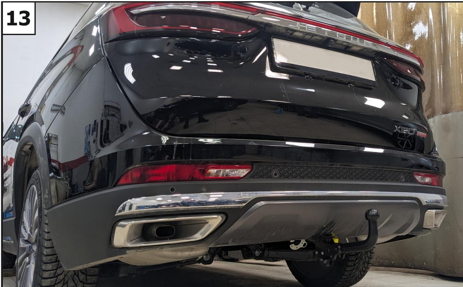
**Установить вставку быстростъёма в ответную часть. Закрепить крюк (11) с помощью винтов M12x45 (17). Затянуть все резьбовые соединения. Моменты затяжки: M6=10 Нм; M12=81 Нм.**
