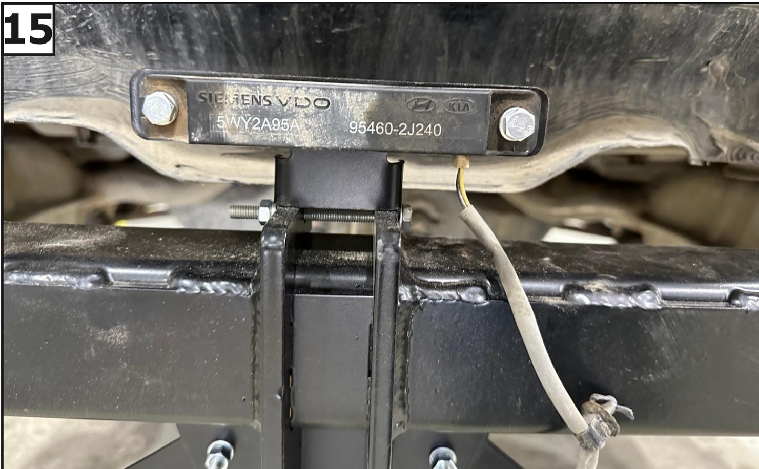
Установить кронштейн антенны (10) на балку с помощью болта М6х70 (14), гайки М6 (21), шайб 6 (25) и шайб 6 пружинных (26). После установить антенну с помощью болтов М6х16 (13), гаек М6 (21), шайб 6 (25) и шайб 6 пружинных (26)
