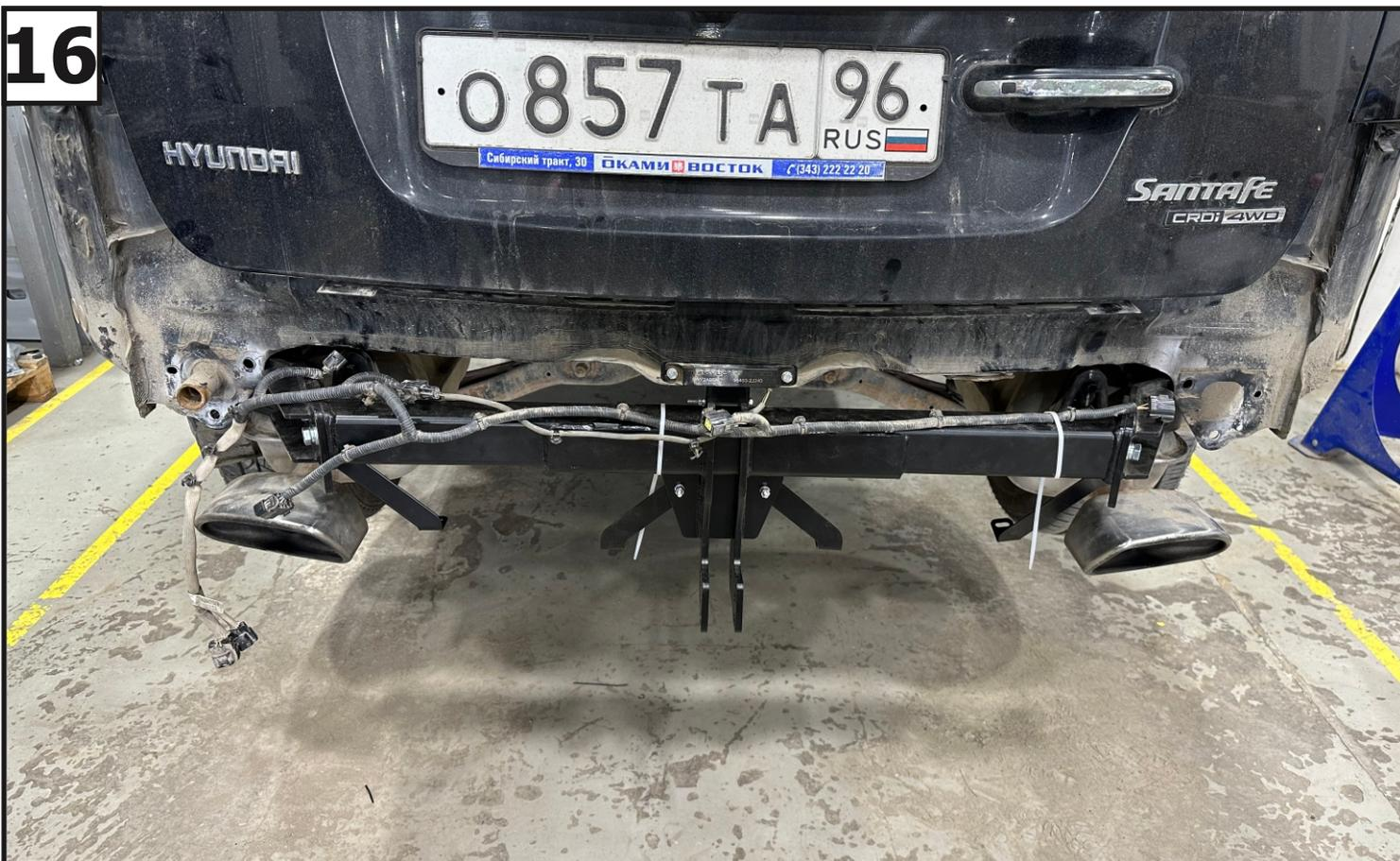
Закрепить электрическую проводку на балке с помощью хомутов-стяжек.
