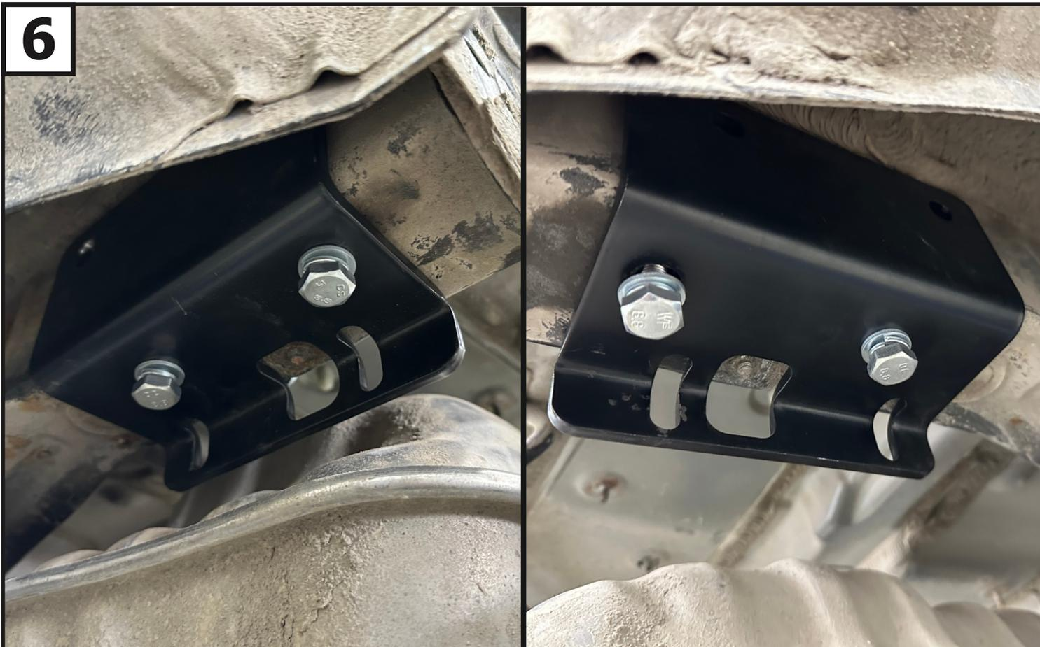
**Установить усиление левое (4) и усиление правое (5) к лонжерону с помощью болтов M10x1,25x30 (16), шайб 10 (27) и шайб 10 пружинных (28).**
