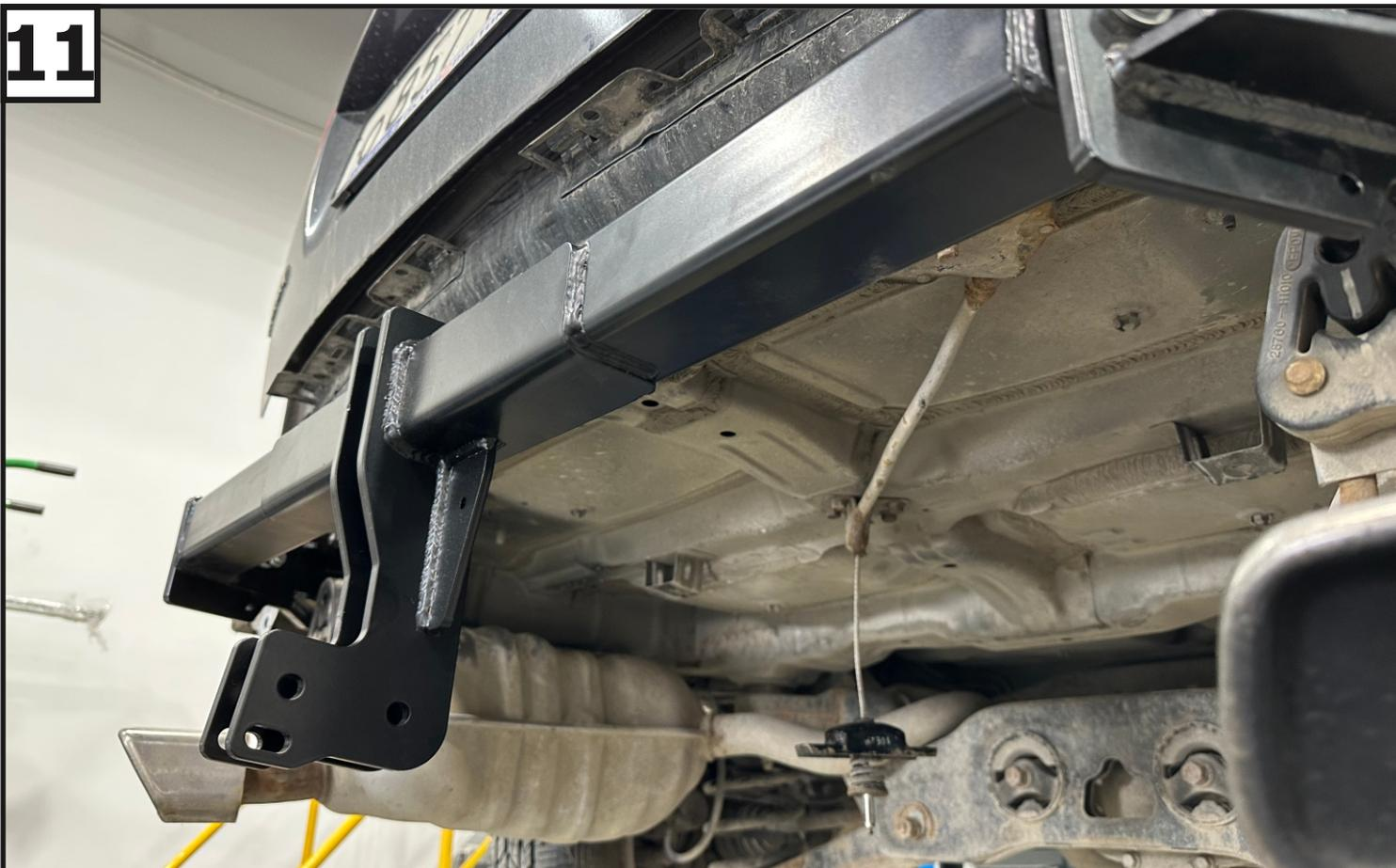
К установленным кронштейнам закрепить балку (1) с помощью болтов М12х1,25х40 (18), гаек М12х1,25 (23), шайб 12 (29) и шайб 12 пружинных (31).
