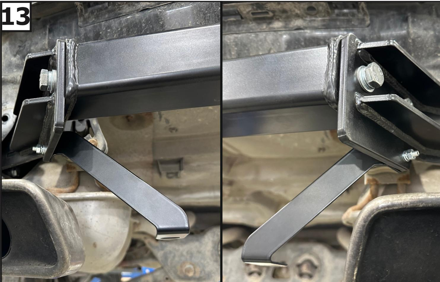
Установить кронштейн бампера левый (6) и кронштейн бампера правый (7) на кронштейны с помощью болтов М6х25 (14), гаек М6 (21), шайб 6 (25) и шайб 6 пружинных (26).
