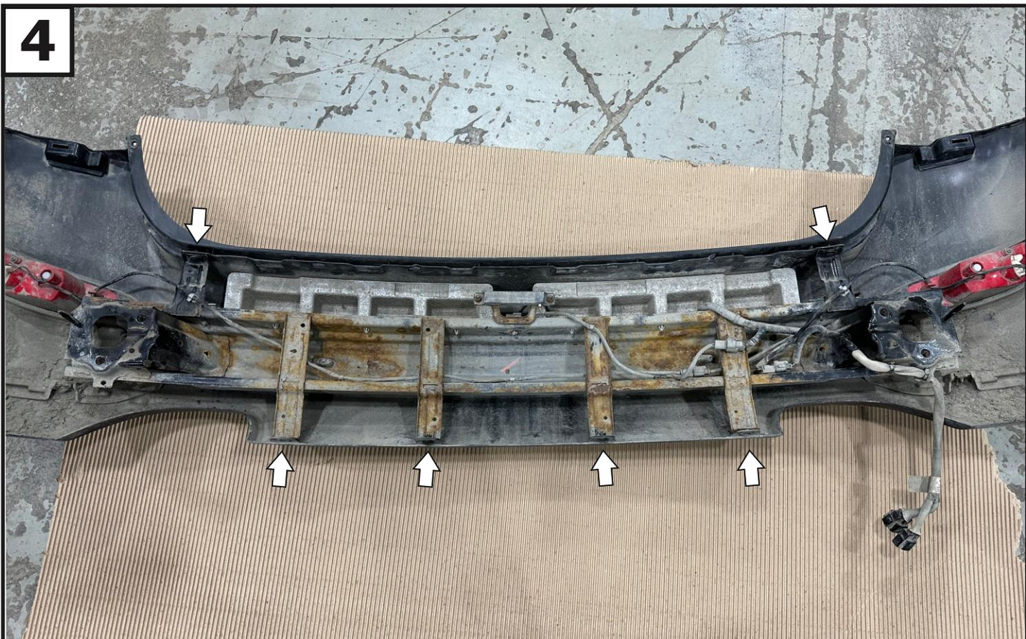
**Со снятого бампера демонтировать усилитель и электрическую проводку.**
