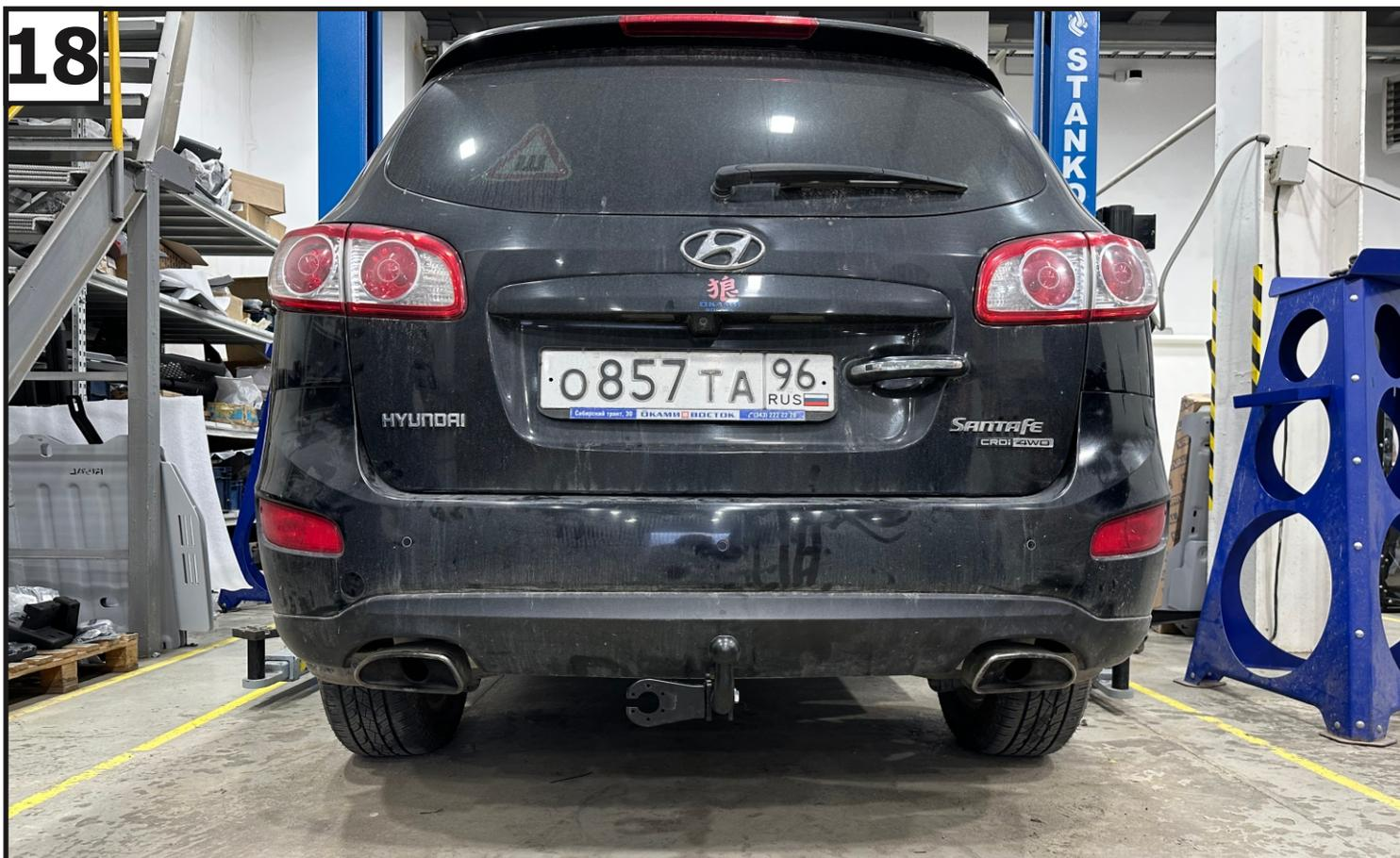
Установить бампер в обратной последовательности. После установить крюк (12) и кронштейн под розетку (11) с помощью болтов М12х1,25х70 (19), гаек М12х1,25 (23), шайб 12 (29) и шайб 12 пружинных (31).
