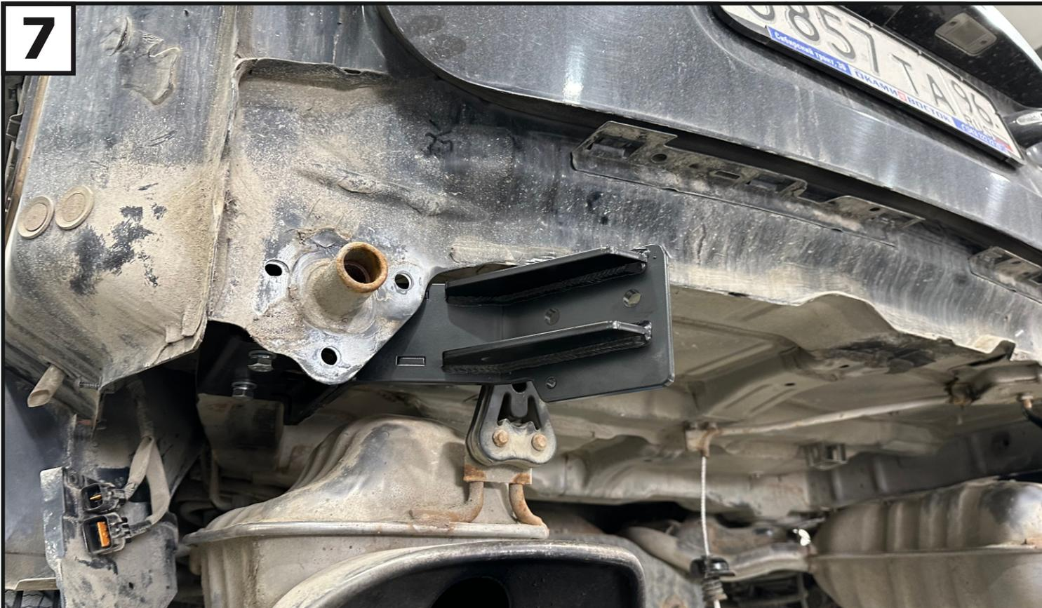
**Закрепить кронштейн левый (2) и кронштейн правый (3) к лонжеронам и усилениям с помощью болтов M10x1,25x35 (17), болтов 12x120, гаек M10x1,25 (22), гаек M12 (24), шайб 10 (27), шайб 10 пружинных (28), шайб 12 (29), шайб 12 увел. (30) и шайб 12 пружинных (31).**
