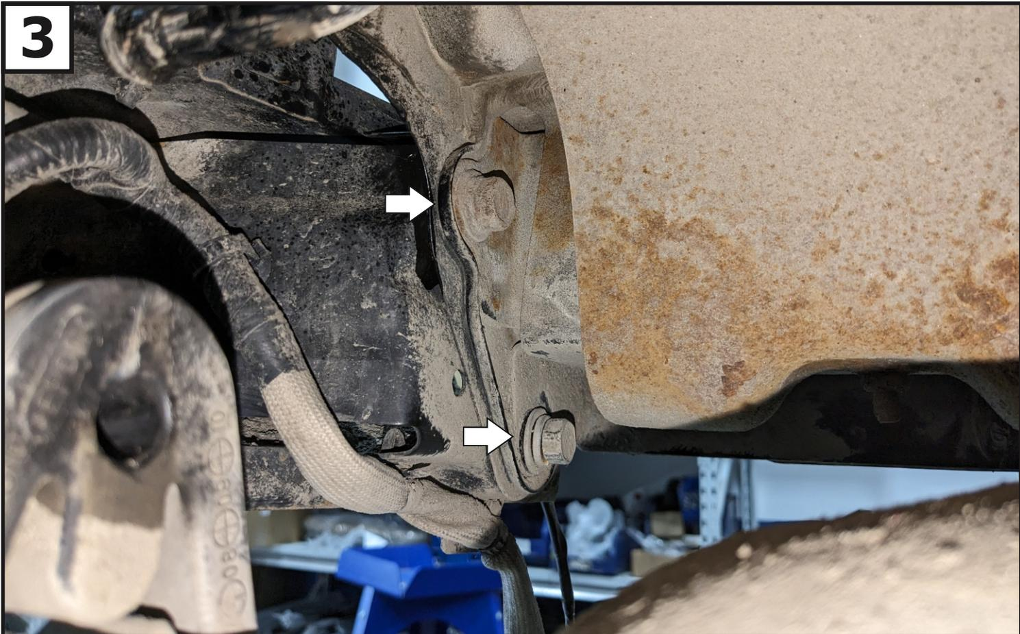
**Выкрутить винты крепления усилителя с левой и правой стороны автомобиля. После вместе с усилителем демонтировать бампер.**
