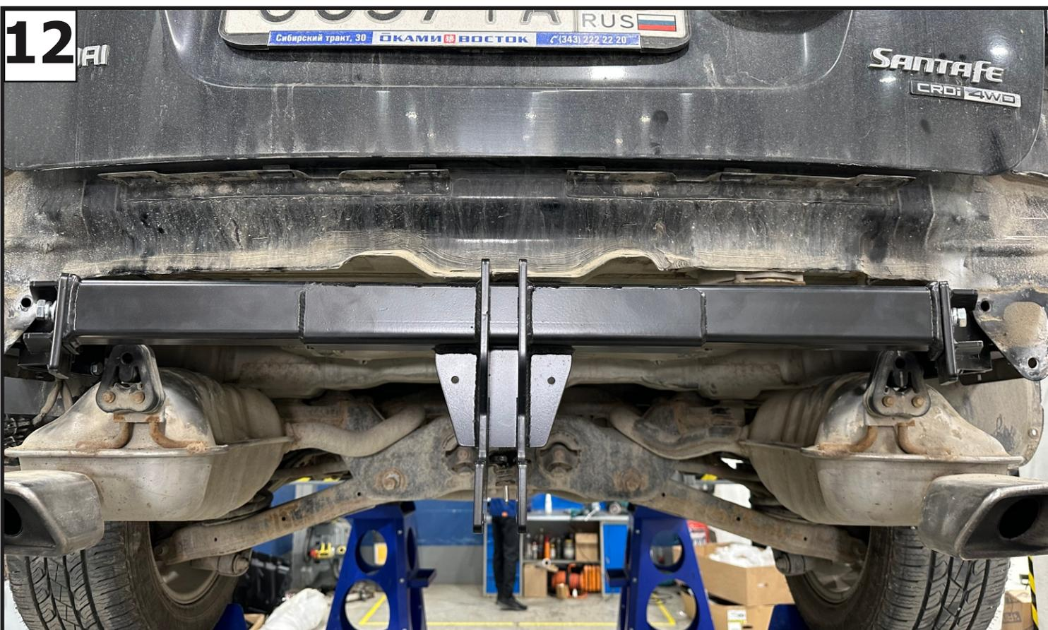
Затянуть все резьбовые соединения, сначала затянуть балку с кронштейнами, затем кронштейны к лонжеронам и усилителям. Моменты затяжки: М10=47 Нм, М12=81 Нм.
