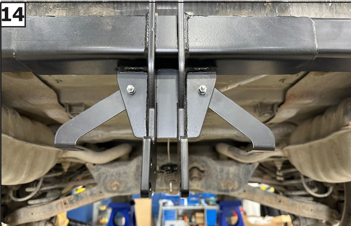
Установить кронштейн бампера 2 левый (8) и кронштейн бампера 2 правый (9) на балку с помощью болтов М6х25 (14), гаек М6 (21), шайб 6 (25) и шайб 6 пружинных (26).
