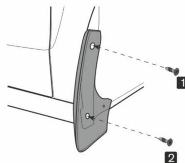
Используя шуруповерт с насадкой T20 установите, ранее демонтированные, штатные саморезы в точках 1 и 2.
