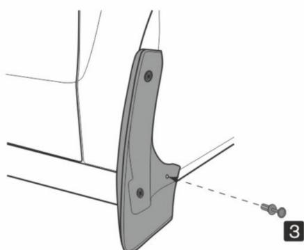
Используя шуруповерт со сверлом Ø 8 мм просверлите отверстие в точке 3. Установите пластиковый фиксатор из комплекта поставки.
