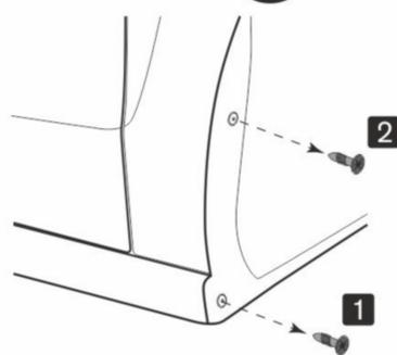
Используя шуруповерт с насадкой T20 произведите демонтаж штатных саморезов в точках 1 и 2.
