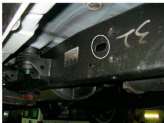
Рис. 5 Место крепления среднего кронштейна
