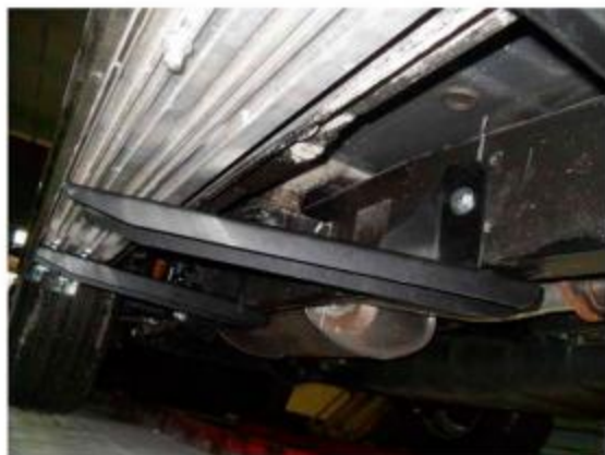
Рис. 8 Крепление среднего кронштейна
