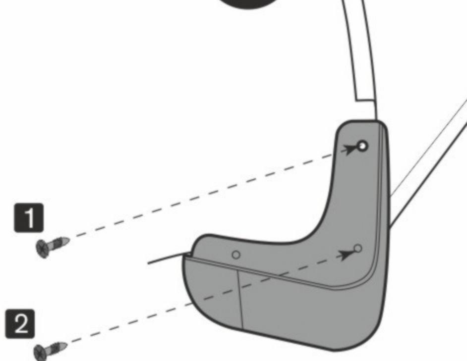
Используя шуруповерт с насадкой T20, установите штатный саморез в точке 1. В точке 2, используя шуруповерт со сверлом Ø 4 мм, просверлите отверстие и установите штатный саморез.
