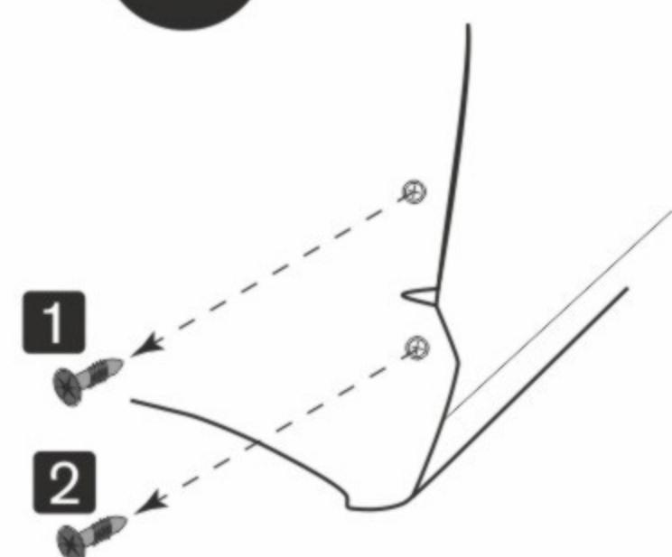
Используя шуруповерт, произведите демонтаж штатных саморезов в точках 1 и 2.
