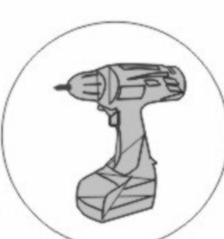
Используя шуруповерт со сверлом Ø 8 мм, просверлите отверстие в точке 3. Установите пластиковый фиксатор из комплекта поставки.
