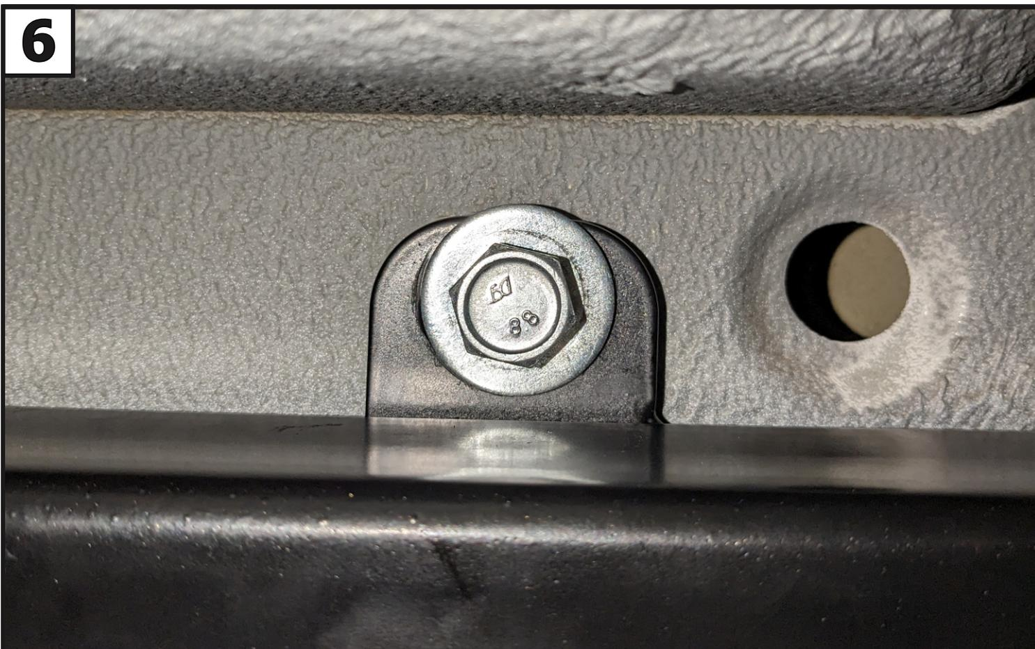
Закрепить балку (1) через проушины к задней панели с помощью болтов М10х1,25х35 (5), шайб 10 пружинных (9) и шайб 10 увеличенных (10).
