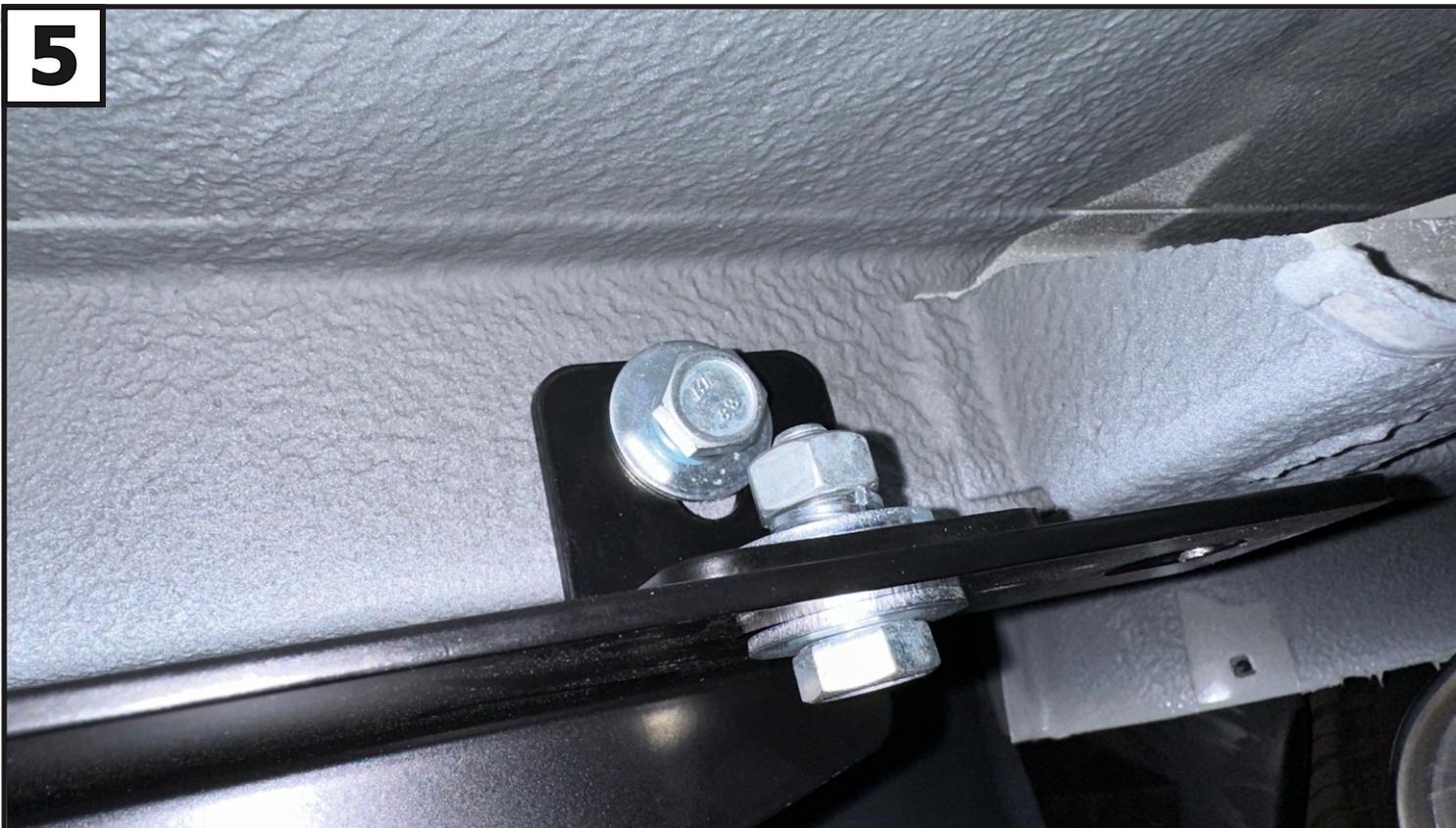
Закрепить балку к левому лонжерону с помощью уголка (2), болта М10х1,25х35 (5), шайбы 10 пружинных (9) и шайб 10 увеличенных (10). Уголок закрепить к балке с помощью болта М10х1,25х35 (5), гайки М10х1,25 (7), шайбы 10 пружинной (9) и шайб 10 увеличенных (10): для Lada Granta SW/ Kalina SW - отверстие А; для Lada Granta SE/LB - отверстие D .
