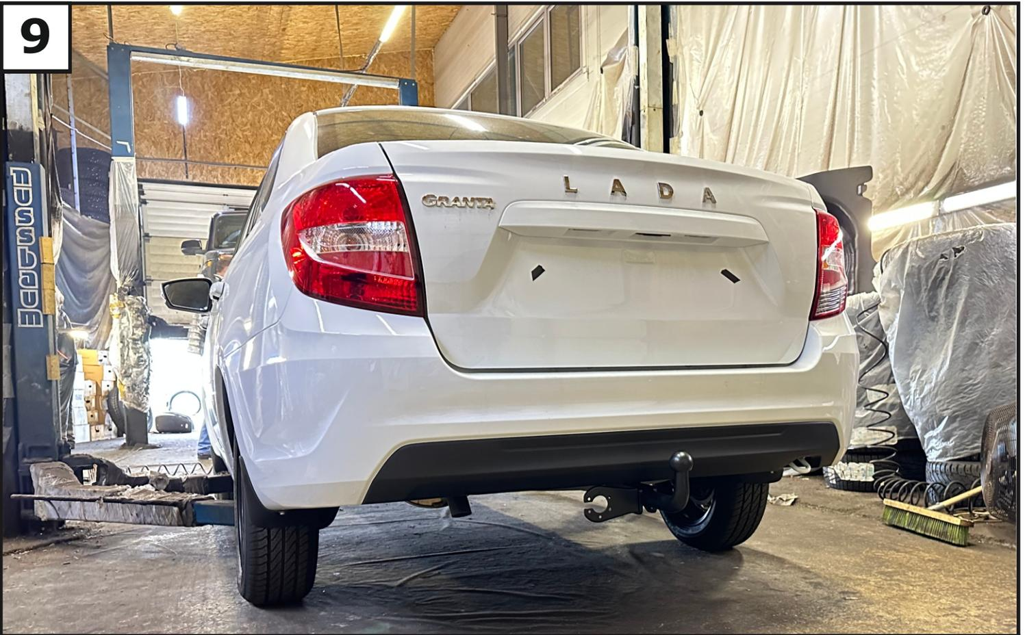
**Затянуть резьбовые соединения. Моменты затяжки: M12=81Нм.**
