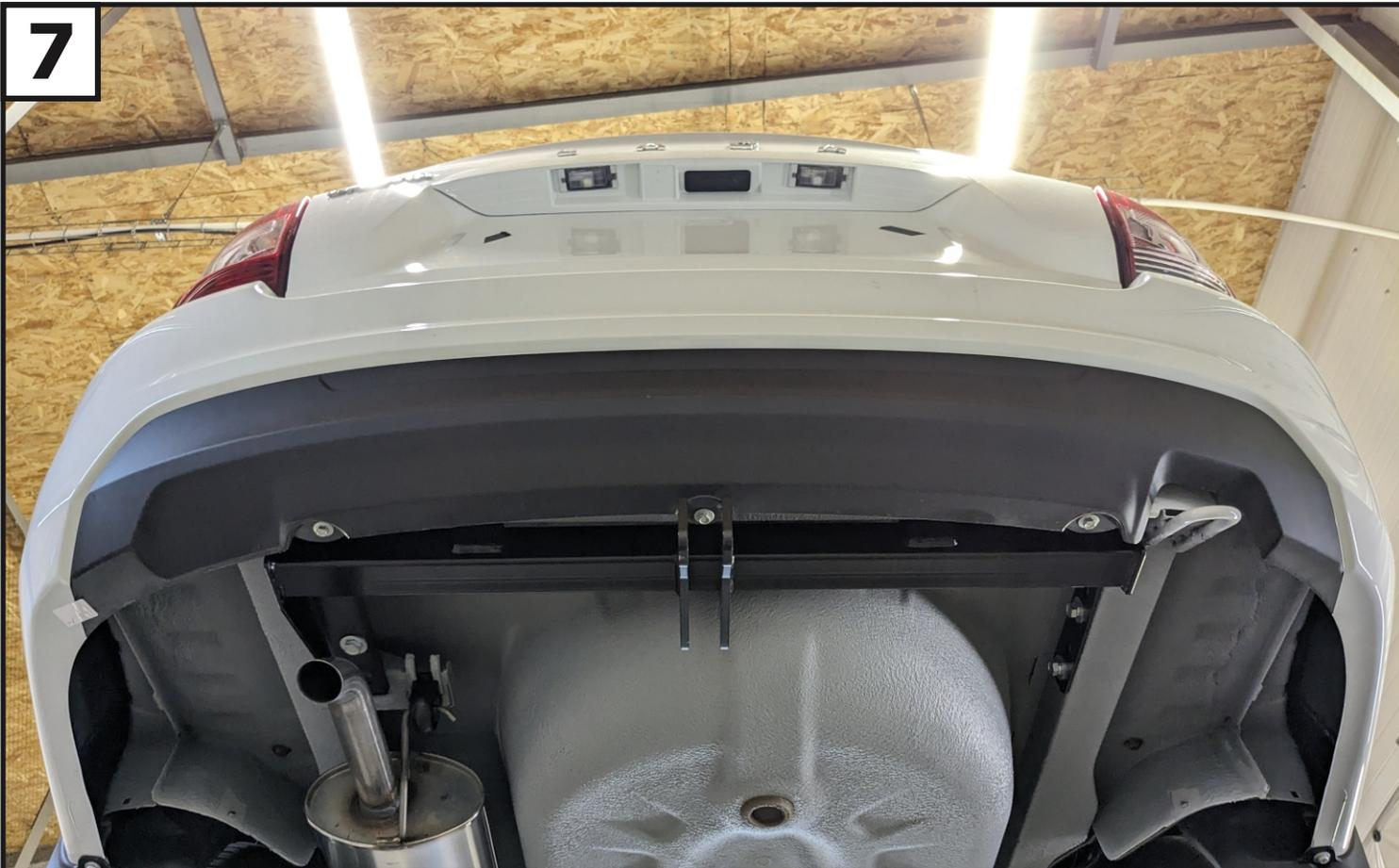
**Выставить балку по центру автомобиля. Затянуть резьбовые соединения: сначала балку к задней панели, затем балку к лонжеронам. Момент затяжки: M10=47 Нм.**
