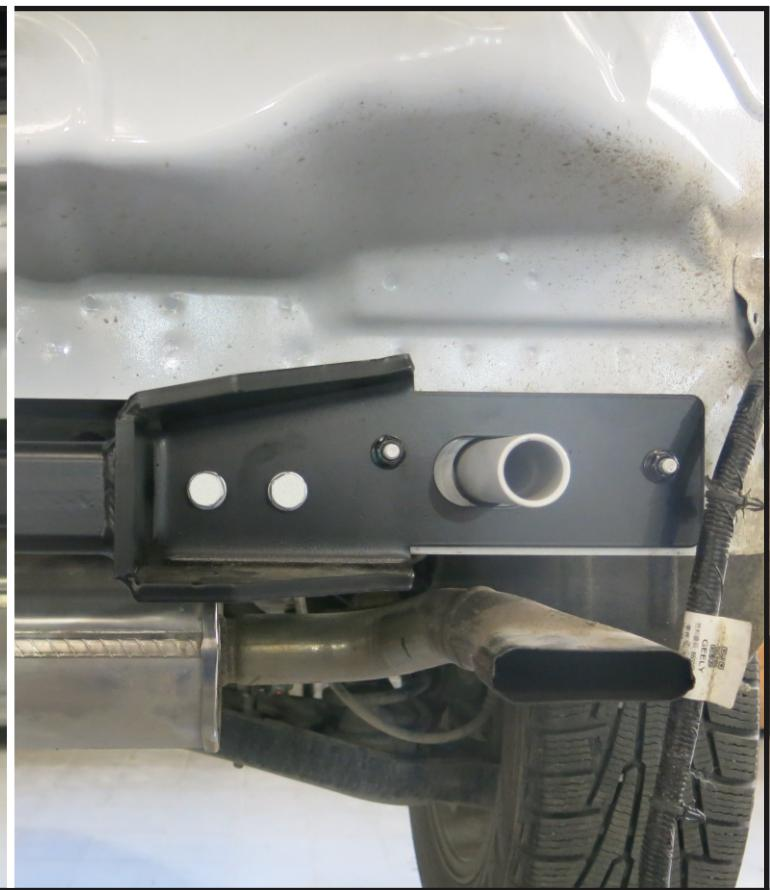
Установить балку (1) закрепив ее к задней панели автомобиля с помощью штатных гаек крепления усиления бампера. Затем закрепить балку к установленным кронштейнам с помощью болтов M10x1,25x35 (19), шайб 10 (28) и шайб 10 пружинных (30).
