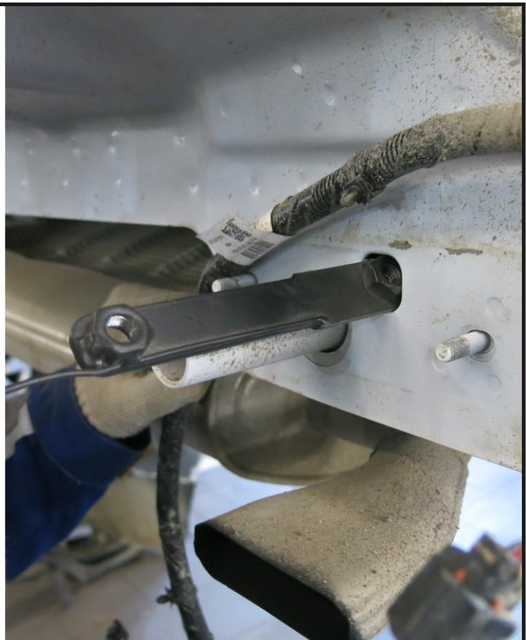
**Установить в лонжероны закладные (4),(5), через штатные отверстия в задней панели автомобиля.**
