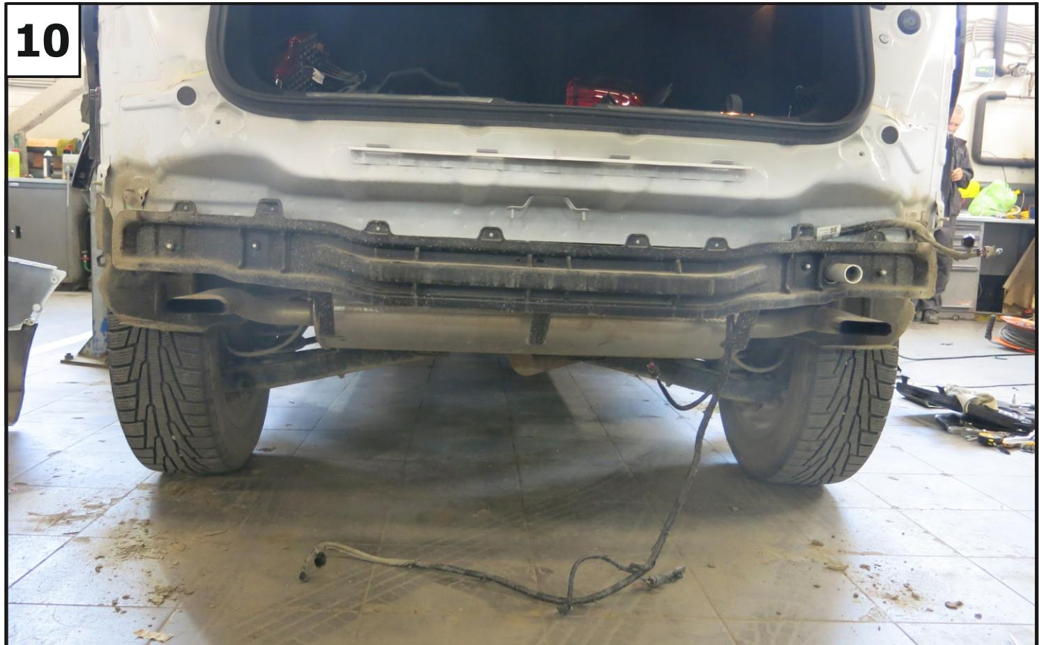
**Демонтировать проводку и антенну с усилителя бампера.**
