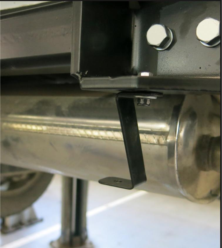
**Установить левый (11) и правый (12) кронштейны бампера с помощью болтов M6x25 (15), шайб 6 (22), шайб 6 пружинных (24) и гаек M6 (20). Установить кронштейн антенны (13) по середине балки с помощью болта M6x90 (14), шайб 6 (22), шайбы 6 пружинная (24) и гайки M6 (20). После установить задний бампер в обратной последовательности.**
