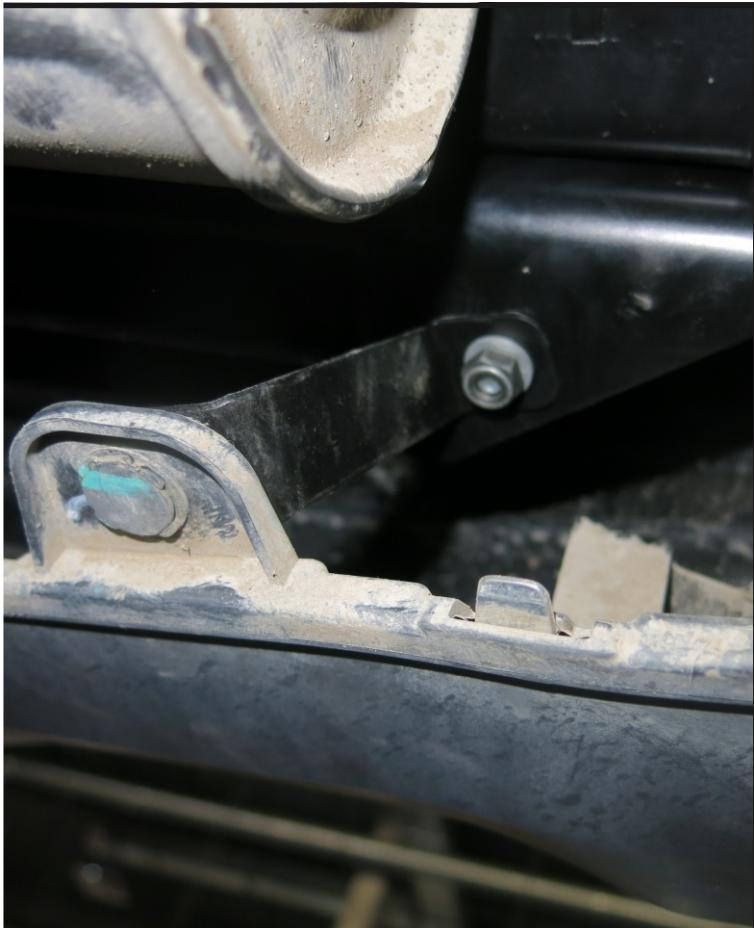
**Закрепить бампер с помощью штатных клипс и кронштейнов бампера (11),(12).
