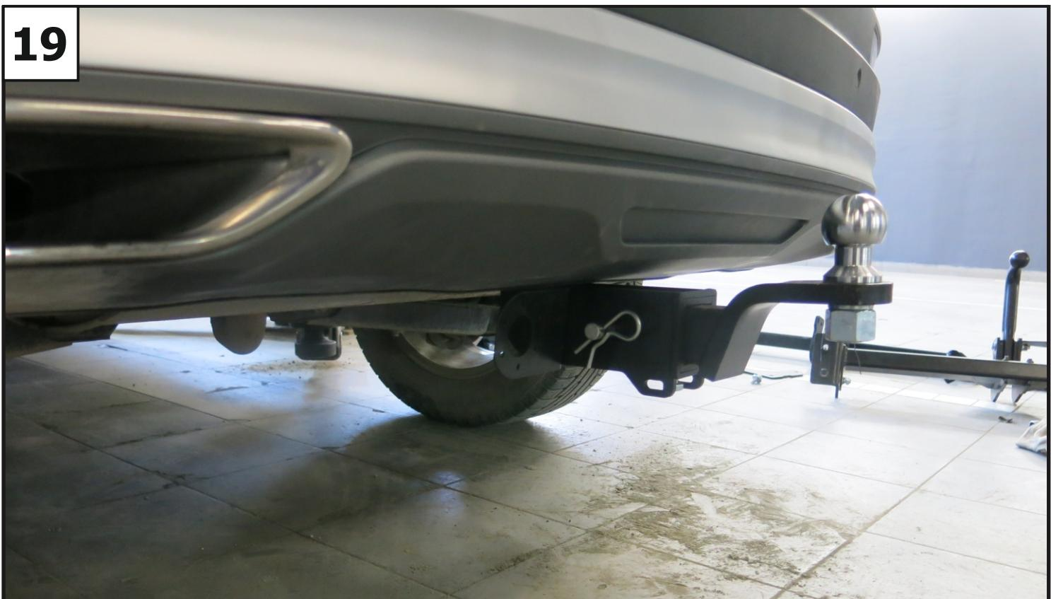
**Установить переходник (6), закрепив с помощью штифта (8) и шплинта (9).
