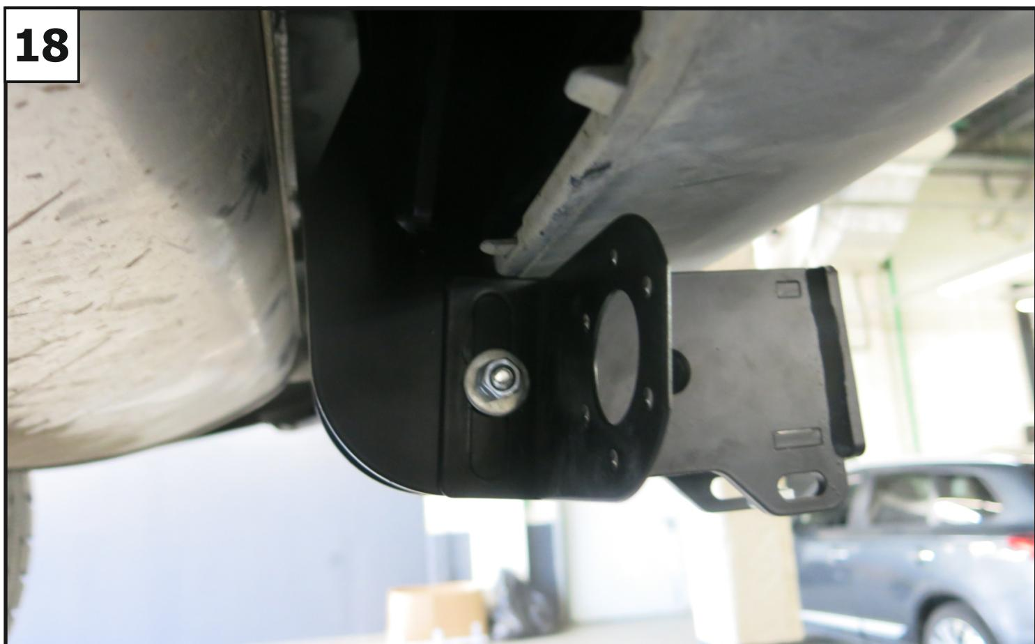
**Установить кронштейн под розетку (10) с помощью болтов M8x80 (16), шайбы 8 (25), шайбы 8 увел. (26), шайбы 8 пружинных (27) и гайки M8 (21). Момент затяжки: M8=25 Нм.**
