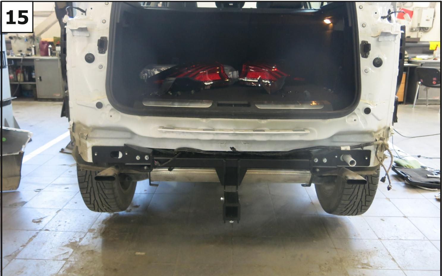
**Затянуть все резьбовые соединения - сначала балки к задней панели, затем балки к кронштейнам и потом кронштейнов к лонжеронам. Моменты затяжки: M10=47 Нм, M8= 25 Нм.**
