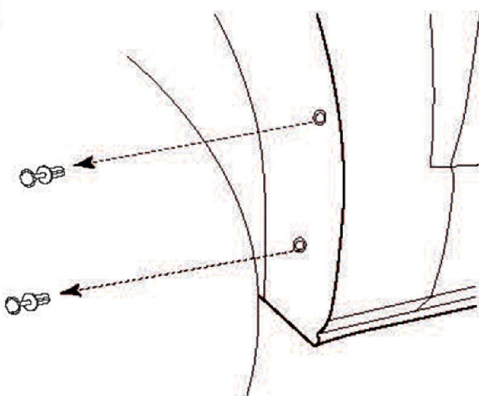
Произведите демонтаж 2-х штатных пластиковых фиксаторов и в дальнейшем их не используйте.
