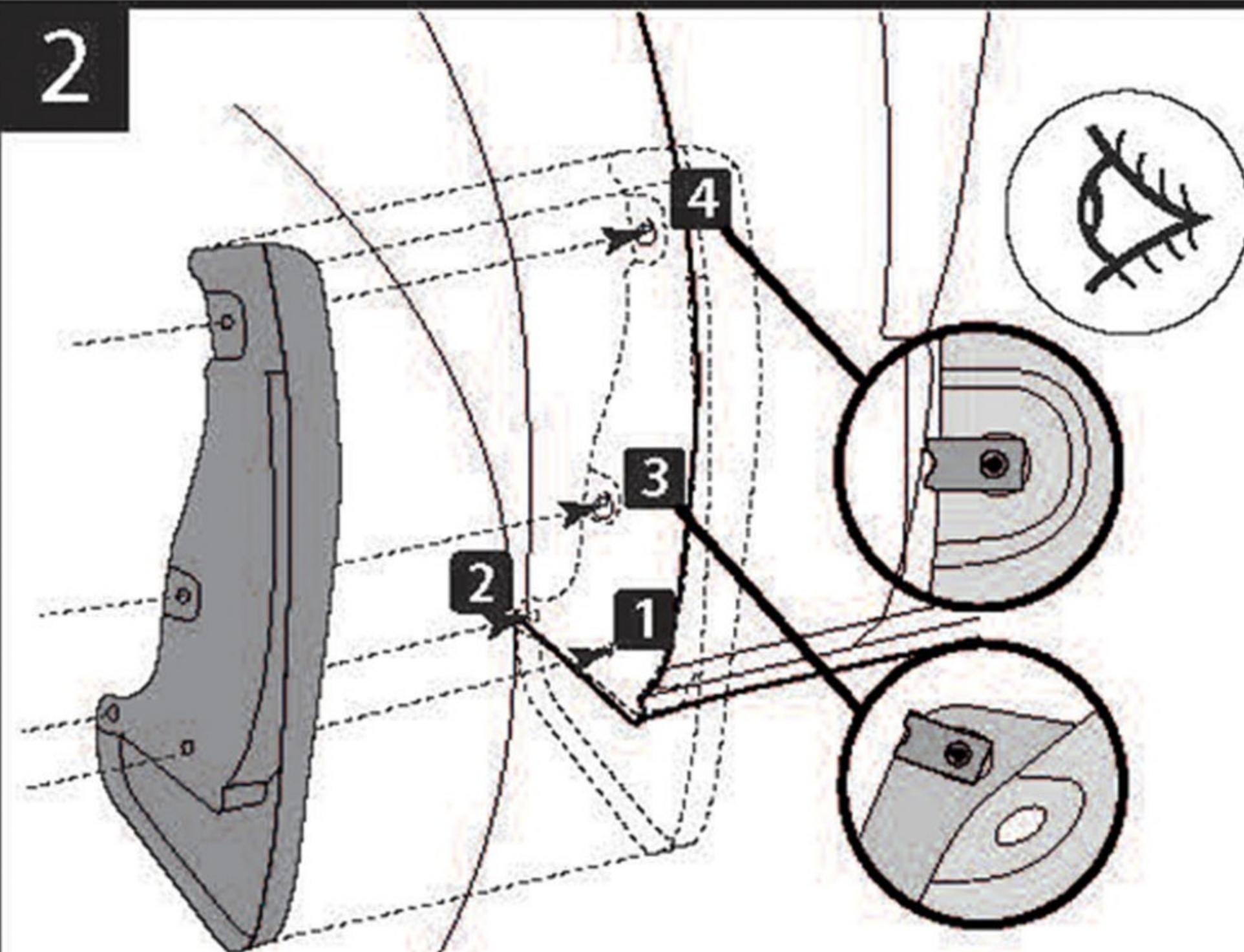
Проведите визуальную примерку изделия, приложив к планируемому месту монтажа. В точках 1 и 2 отметьте места под сверление. В точках 3 и 4 установите гайки-скобы из комплекта поставки. Отогните пластиковую накладку для точки 3.
