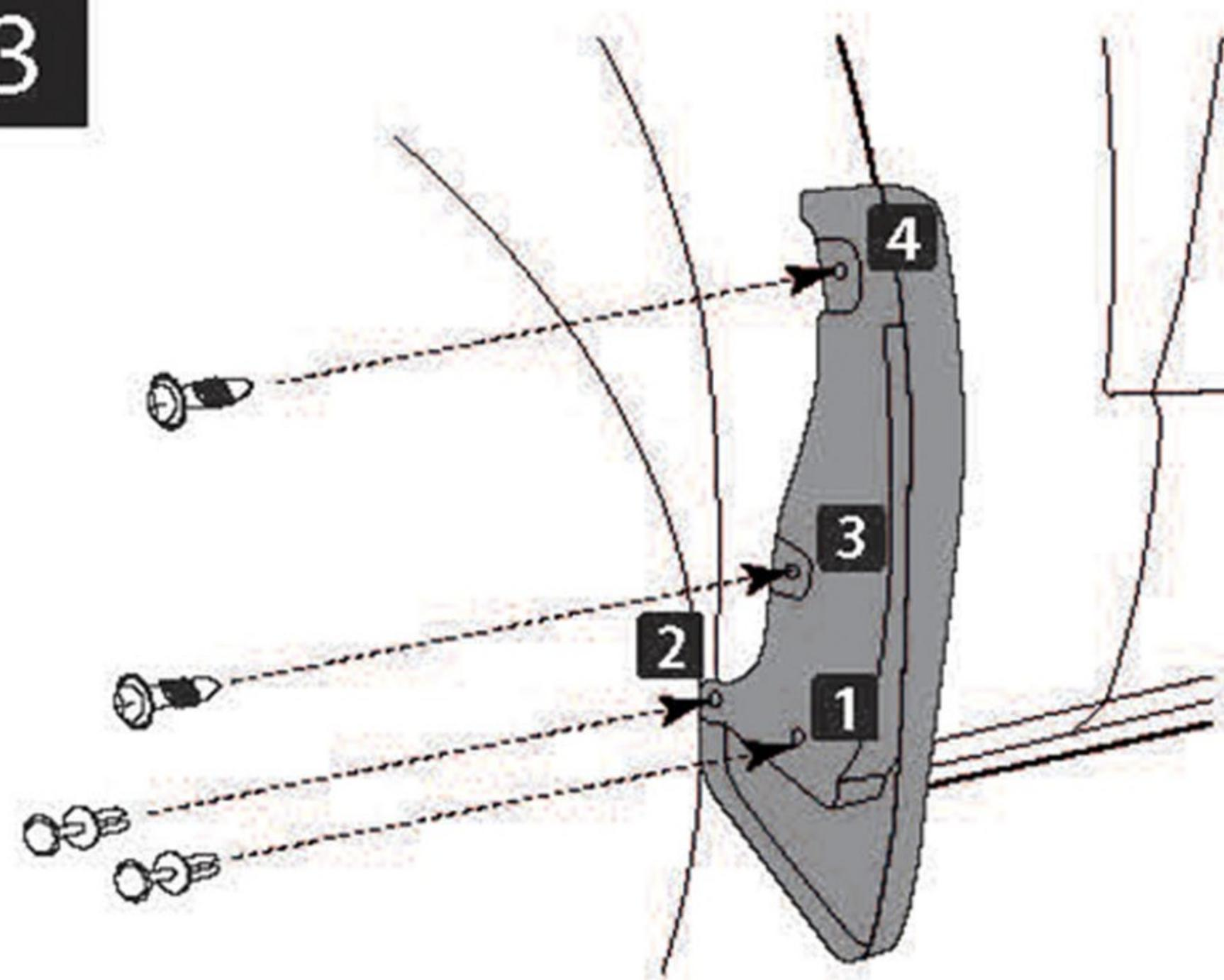
В точках 1 и 2 просверлите отверстия сверлом Ø8 мм. и установите пластиковые фиксаторы из комплекта поставки. В точках 3 и 4 установите в скобы саморезы из комплекта поставки.
