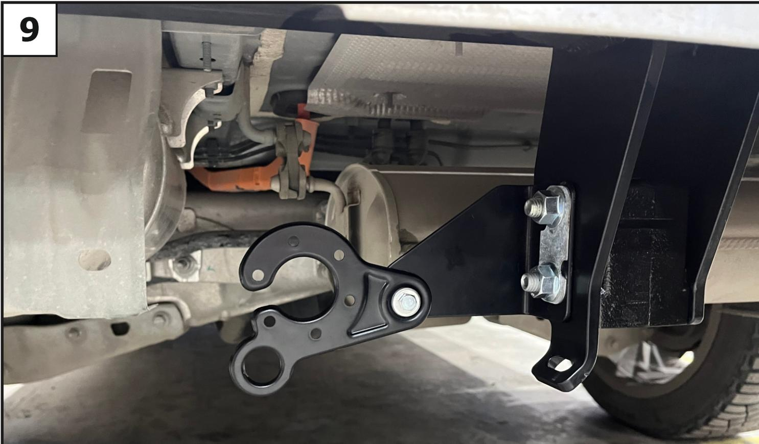
Установить кронштейн под розетку (3), закрепив с помощью болта М6х25 (7), шайб 6 увеличенных (15), шайб 6 полиамидных (16) и гайки М6 (12). Затянуть все резьбовые соединения: сначала ответную часть быстросъема с балкой, затем кронштейн под розетку с кронштейном. Моменты затяжки: М6=10 Нм; М12=81 Нм.
