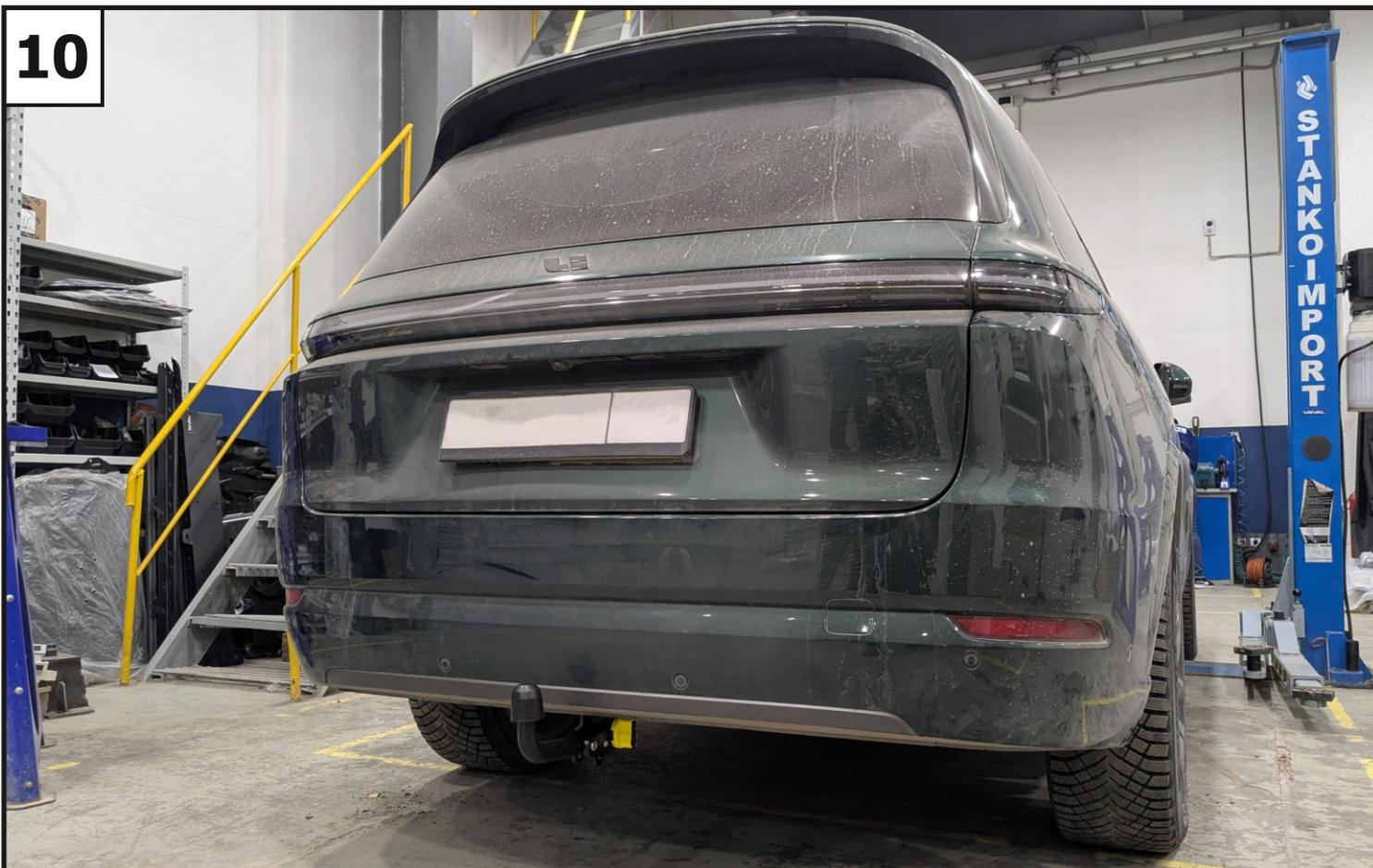
Установить бампер и пыльник в обратной последовательности. Установить вставку быстросъема в ответную часть. Закрепить крюк (5) с помощью винтов М12х45 (10). Затянуть все резьбовые соединения. Момент затяжки: М12=81 Нм.
