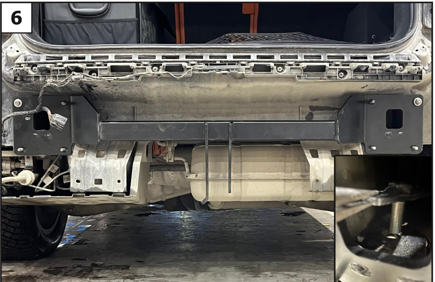
Установить балку (1), закрепив с помощью закладных M12x1,25 (6), шайб 12 пружинных (18), шайб 12 увеличенных (19) и гаек M12x1,25 (14).
