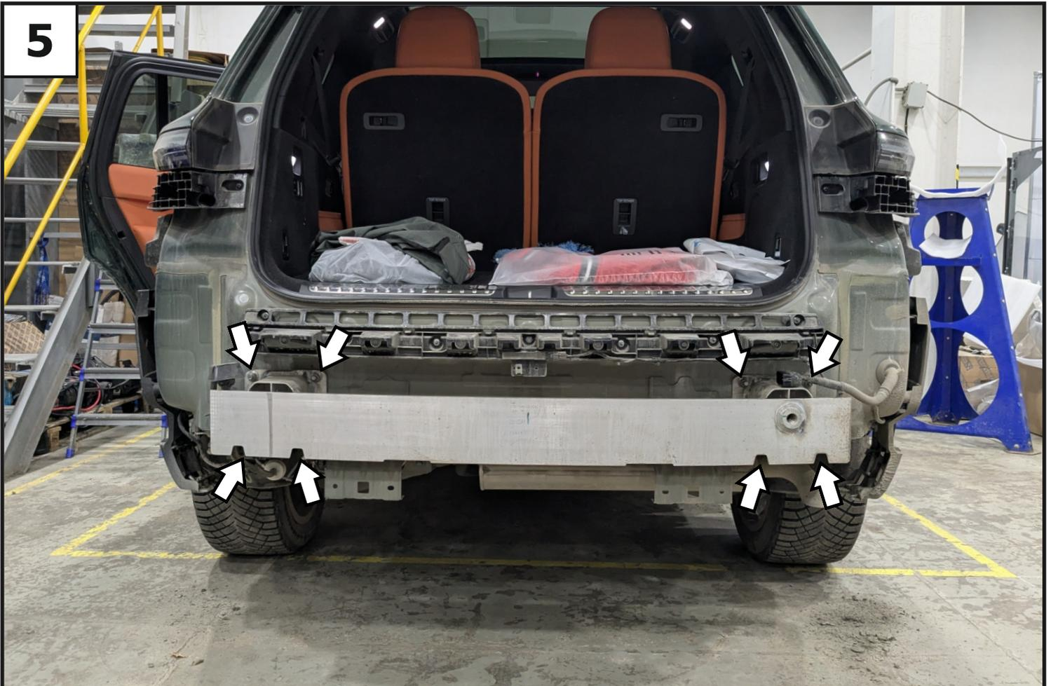
Открутить гайки крепления усилителя и демонтировать усилитель.
