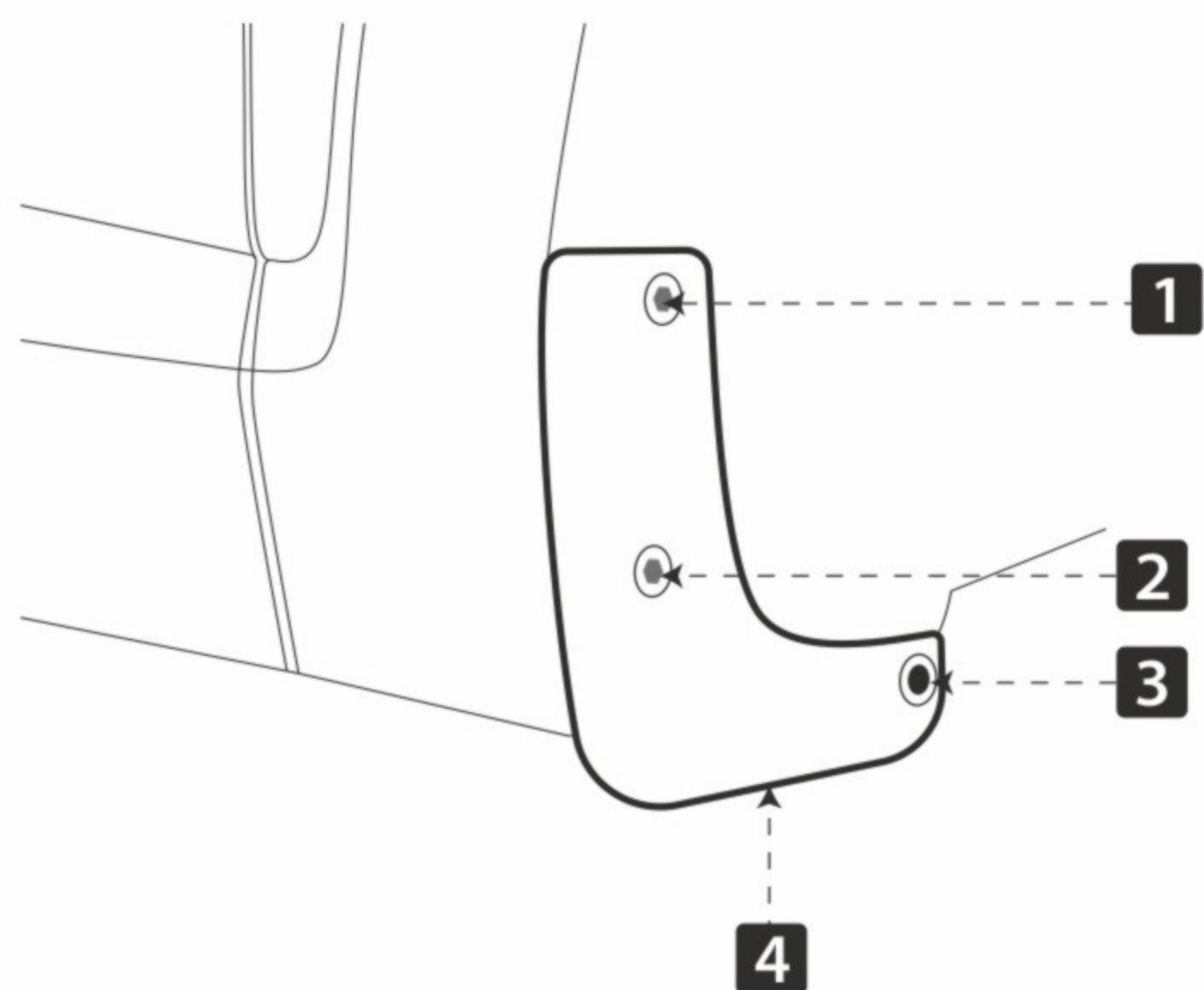
Используя шуруповерт, открутите два штатных самореза в точках 1 и 2, в точках 3 и 4 демонтируйте штатный пластиковый фиксатор.
