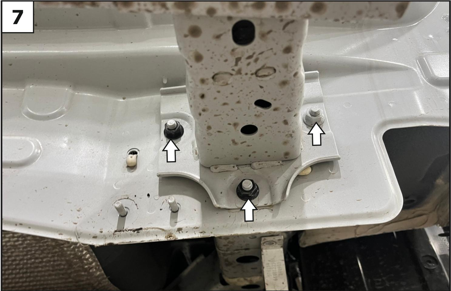
Открутить гайки усилителя бампера. С другой стороны аналогично. Затем демонтировать усилитель.
