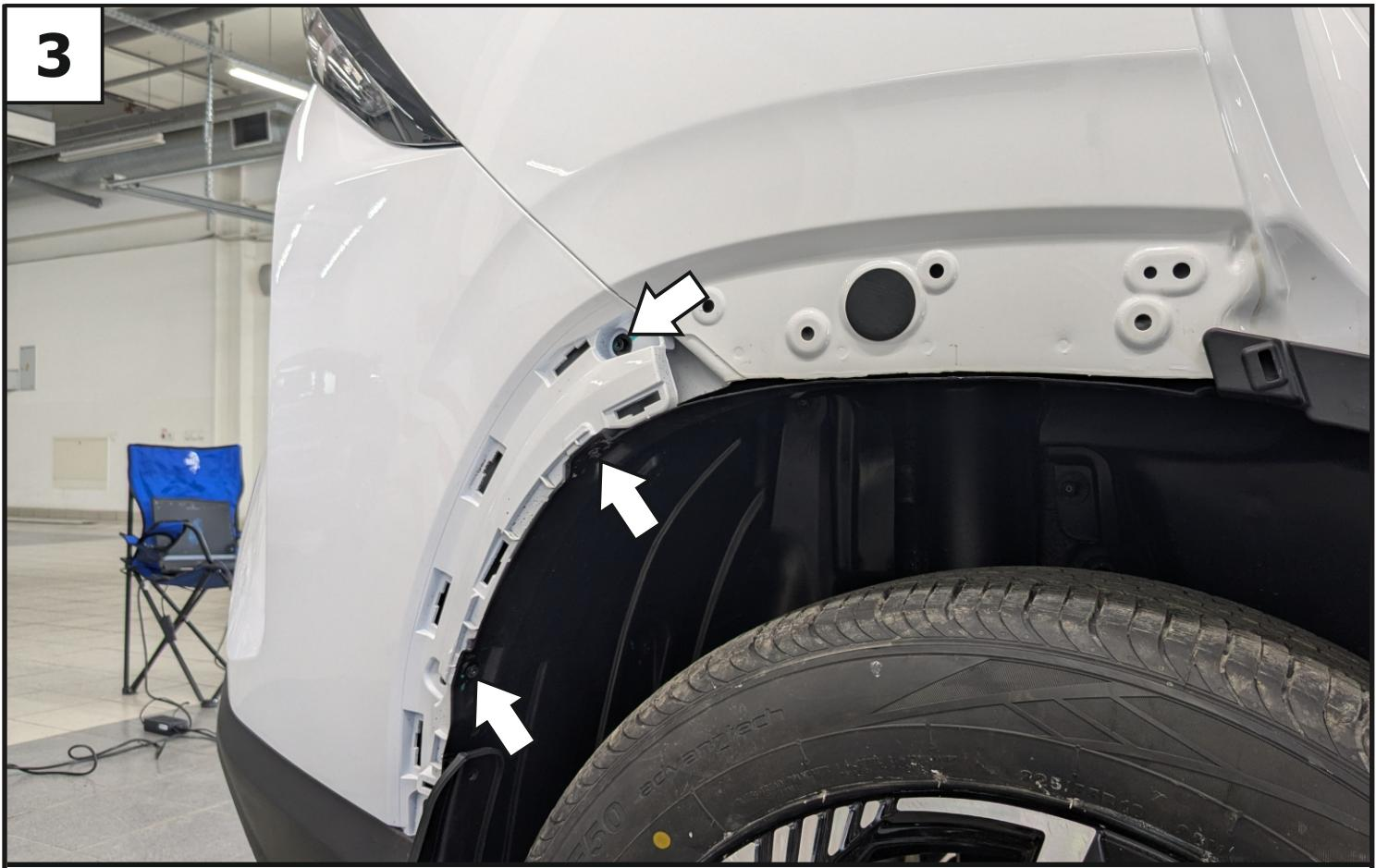
Выкрутить болты крепления подкрылка и болт крепления бампера. С другой стороны аналогично.
