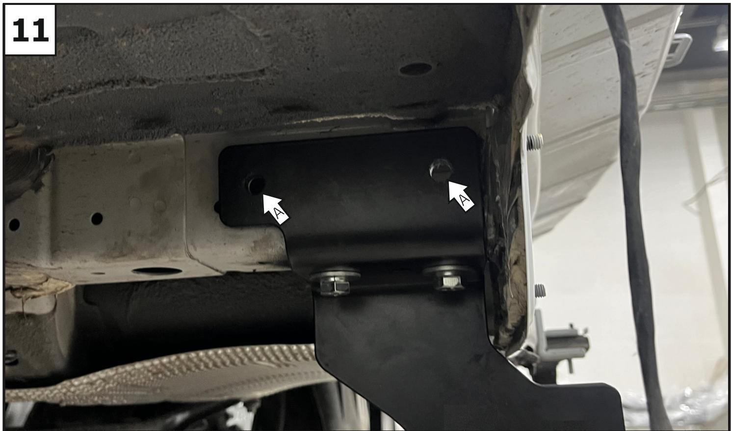
К просверленным отверстиям в левом и правом лонжеронах закрепить левый (2) и правый (3) кронштейны с помощью закладных 1 M10x1,25 (6), гаек M10x1,25 (15), шайб 10 увелич. (19) и шайб 10 пружинных. (18). Затем через отверстия А в кронштейнах (2 и 3) посверлить отверстия в лонжеронах диаметром 12мм.
