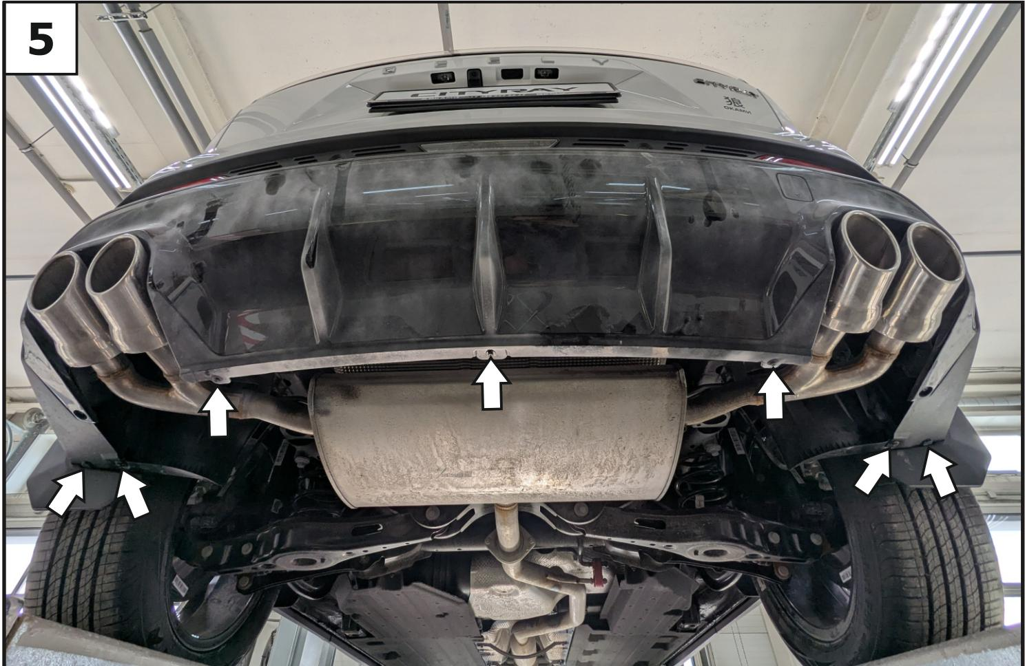
Выкрутить нижние болты крепления бампера, затем демонтировать бампер.
