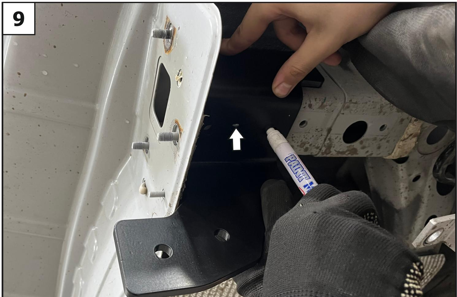
Выполнить разметку отверстий, совместив паз на кронштейне с пазом на лонжероне.
