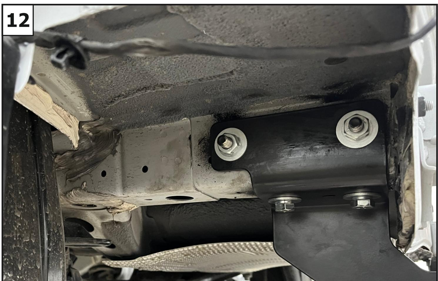
Через посверленные отверстия закрепить кронштейны (2 и 3) с помощью закладных 2 (7), гаек M10x1,25 (15), шайб 10 увелич. (19) и шайб 10 пружинных. (18).
