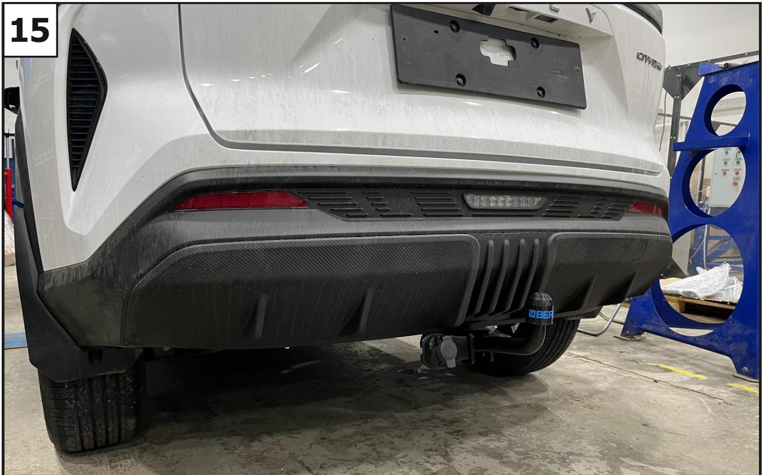
Установить кронштейн под розетку (8) и крюк (9), с помощью проставок (10), болтов M12x1,25x90 (13), шайб 12 пружинных (21), шайб 12 (20) и гаек M12x1,25 (16).
