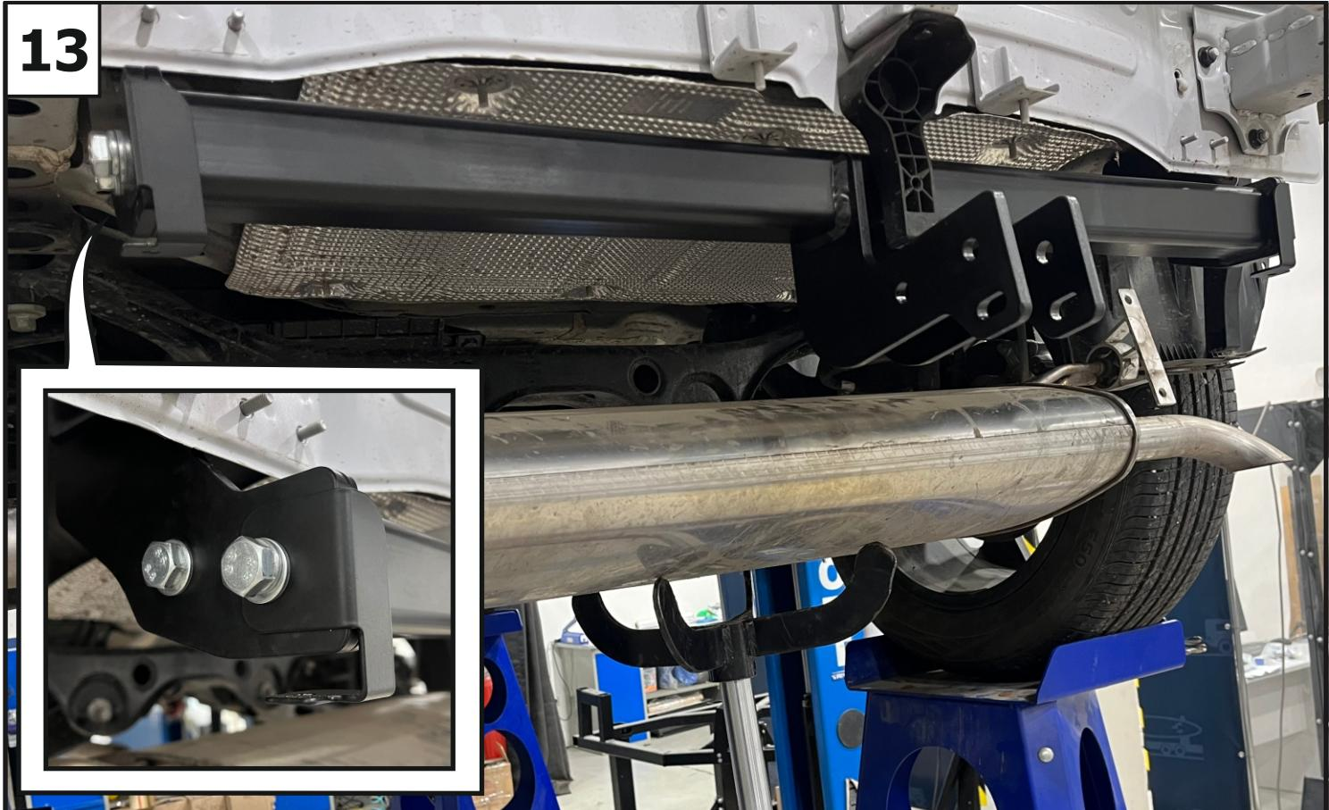
Установить балку (1) и кронштейны бампера (4, 5) к ранее установленным кронштейнам (2, 3) с помощью болтов M12x1,25x40 (12), гаек M12x1,25 (16), шайб 12 (20) и шайб 12 пружинных (21).
