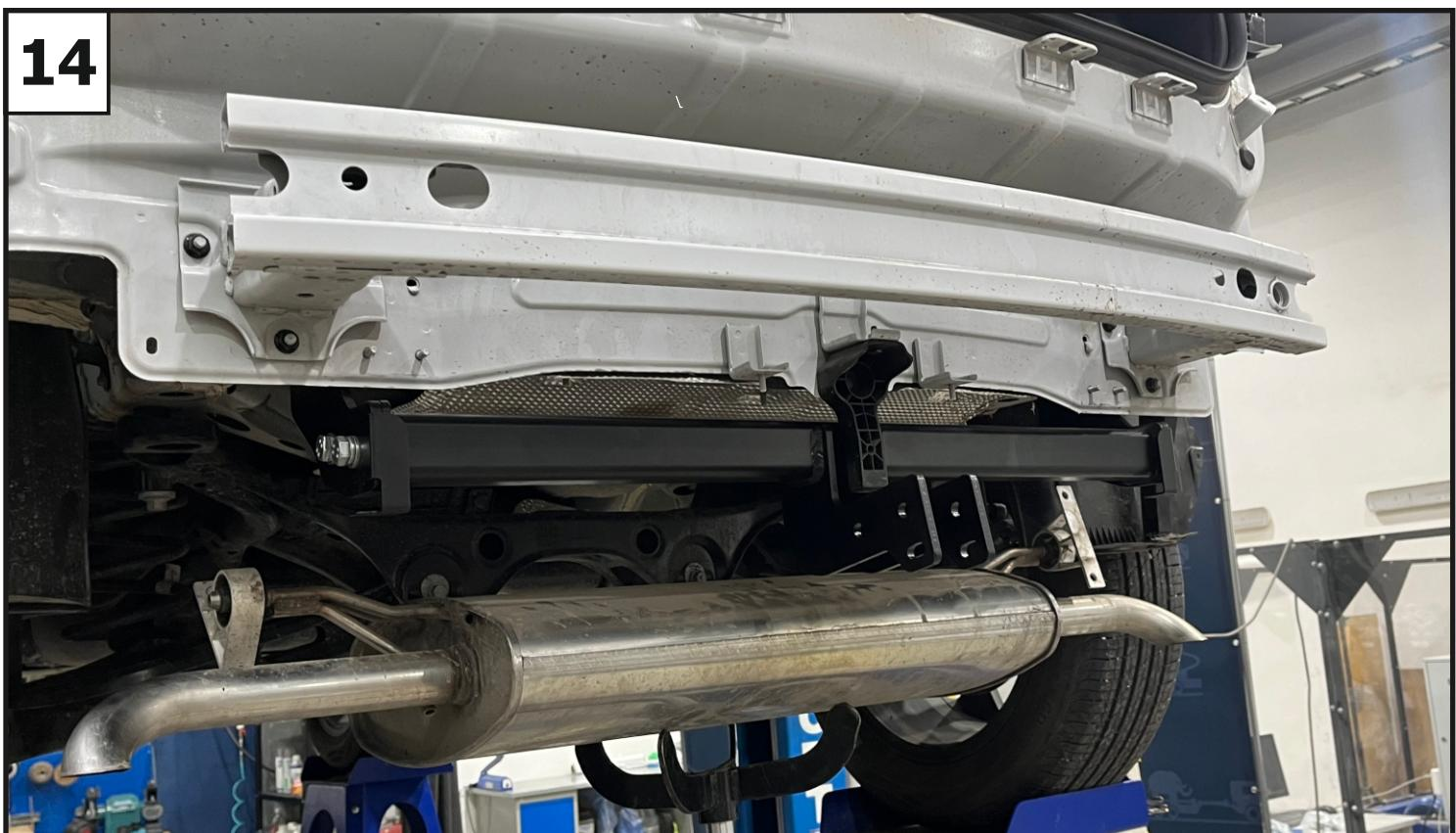
Затянуть все резьбовые соединения: сначала балку с кронштейнами, затем кронштейны к лонжеронам. Моменты затяжки: M10=47 Нм; M12=81 Нм. Установить усилитель и глушитель. Установить бампер в обратной последовательности дополнительно закрепив к кронштейнам бампера (4, 5) с помощью гаек M6 (14), болтов M6x16 (11) и шайб 6 увелич. (17) .
