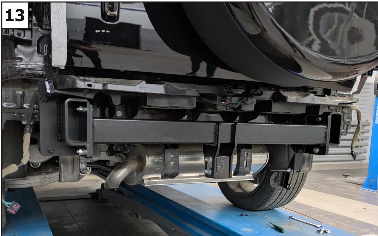
Затянуть все резьбовые соединения. Сначала балку (1) с кронштейнами (2, 3), затем кронштейны (2, 3) с задней панелью, а потом с лонжеронами. Моменты затяжки:  $M6=6$  Нм,  $M10=47$  Нм,  $M12=81$  Нм.
