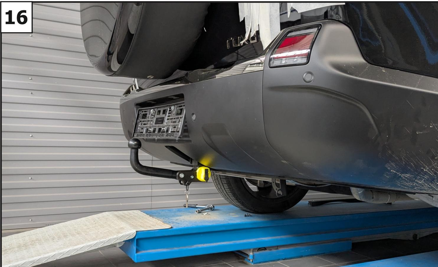
Установить бампер в обратной последовательности. Установить вставку быстросъема (7) в ответную часть (8). Закрепить крюк (9) с помощью винтов M12x45 (16). Затянуть все резьбовые соединения. Момент затяжки: M12=81 Нм.
