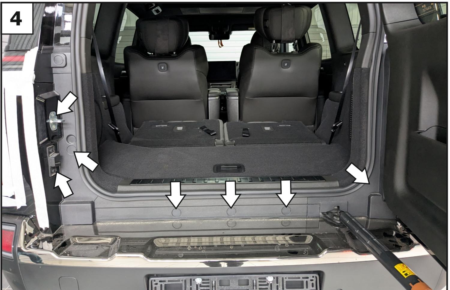
**Снять заглушки и накладку, а также демонтировать петлю замка и направляющую двери багажника.**
