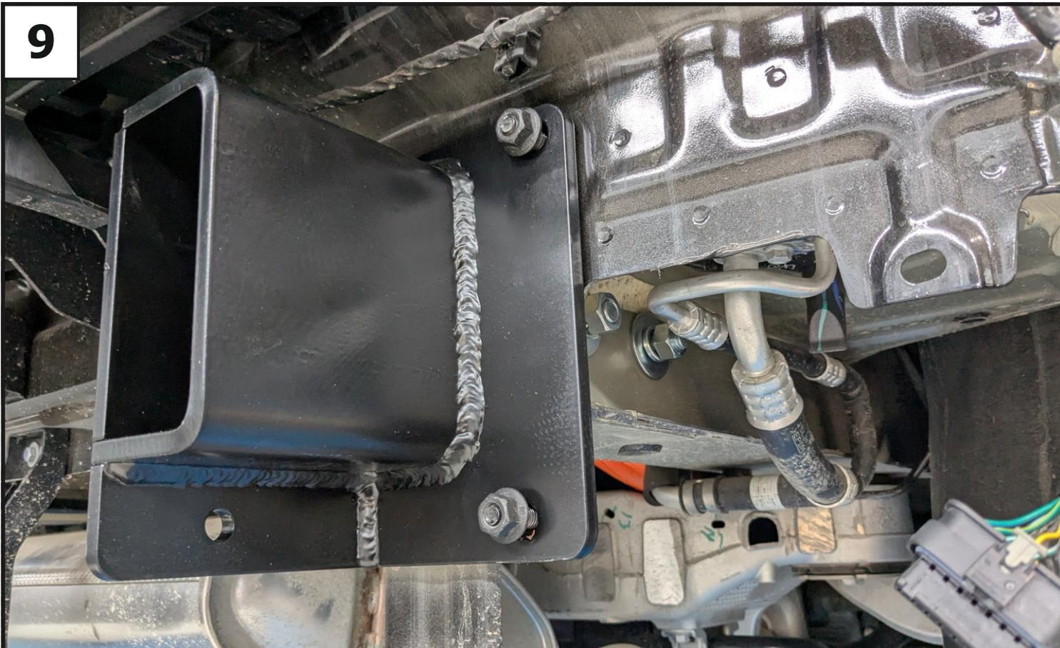
Установить кронштейн правый (3) закрепив с помощью штатных гаек крепления усилителя, болтов М12х130 (13), шайб 12 увел. (24), шайб 12 пружинных (22) и гаек М12 (18). Кронштейн левый (2) установить аналогично.
