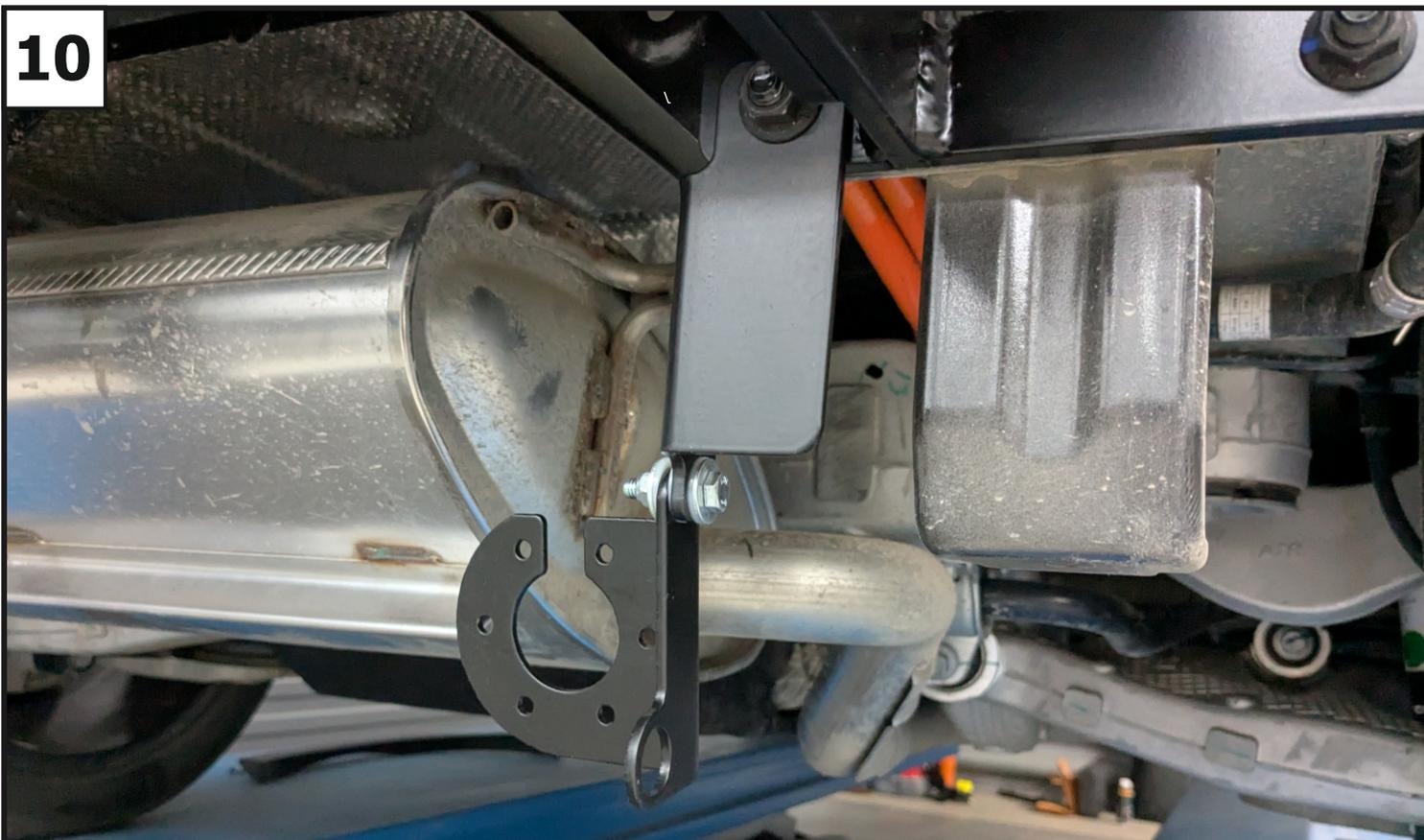
Установить кронштейн (5), закрепив его к кронштейну правому (3) с помощью штатной гайки крепления усилителя. Закрепить кронштейн под розетку (6) к кронштейну (5) с помощью болта М6х25 (10), шайб 6 увел. (20), шайб 6 полиам. (21), гайки М6 самоконтр. (17).
