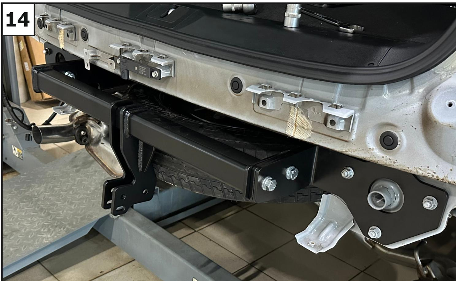
Прогнать резьбовые отверстия балки при помощи метчика М12х1,25. Установить балку (1), закрепив ее с помощью болтов М12х1,25х50 (11), гаек М12х1,25 (13), шайб 12 пружинных (16) и шайб 12 (17).
