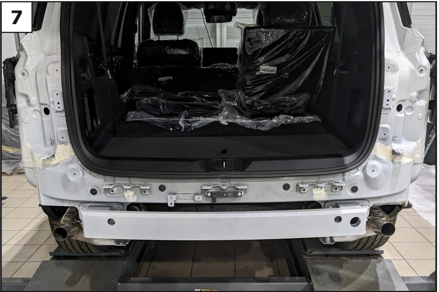
**Снять задний бампер, отключив разъемы электропроводки.**
