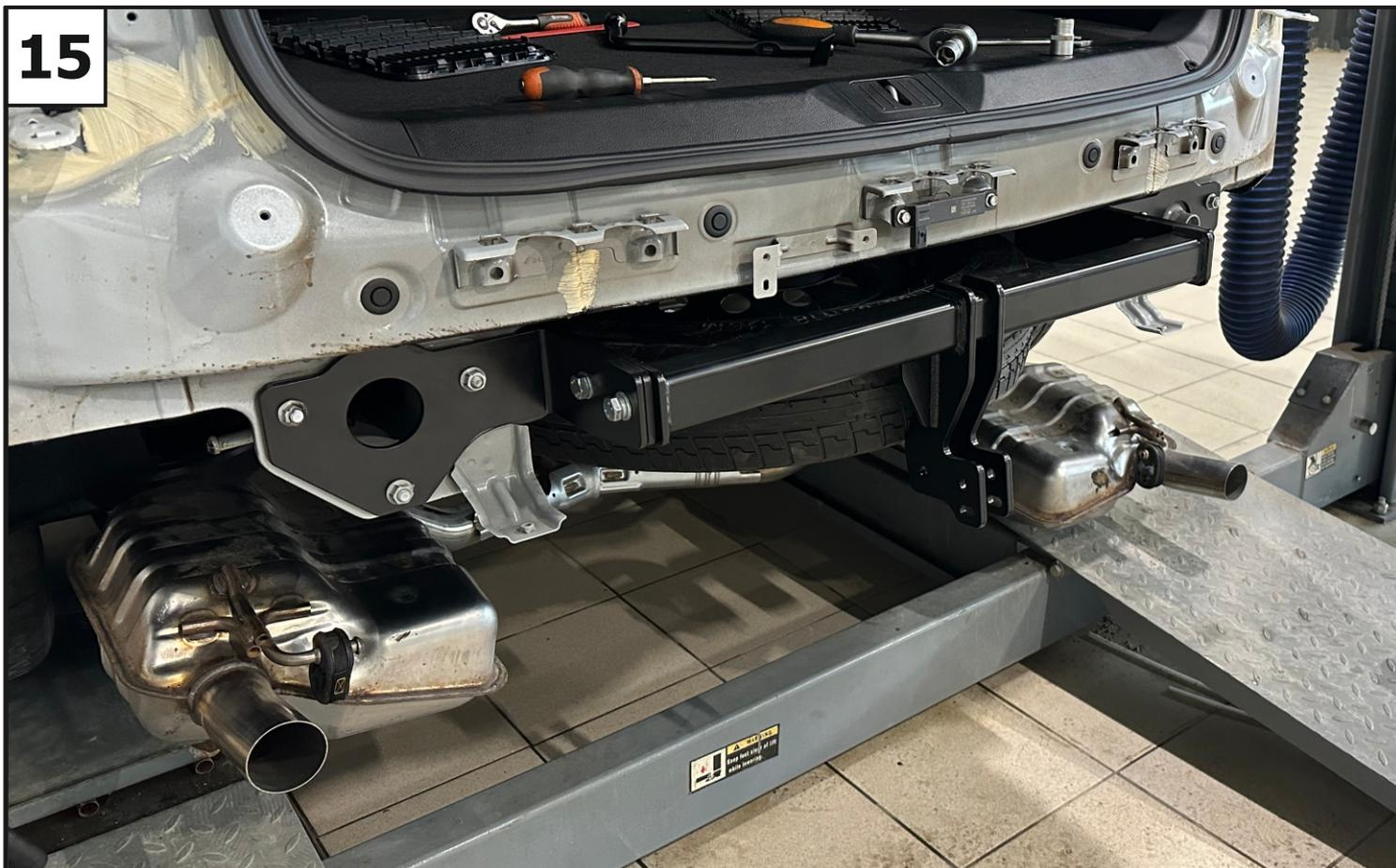
**Затянуть все резьбовые соединения: сначала балку с кронштейнами, затем кронштейны с задней панелью, потом с лонжеронами. Моменты затяжки: M10=47 Нм; M12=81 Нм.**
