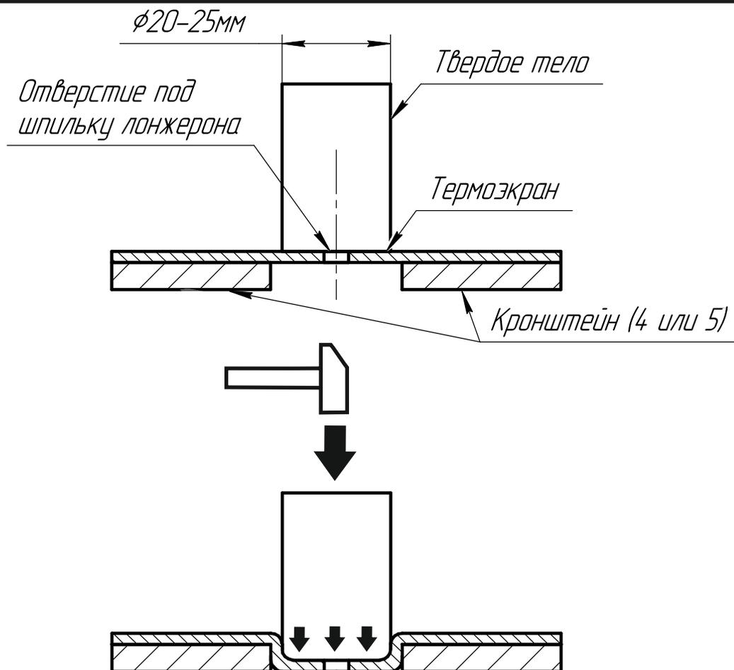
**Выполнить технологическую подштамповку термоэкранов согласно схеме. Просверлить отверстия Ø30 мм под крепежные элементы кронштейнов.**
