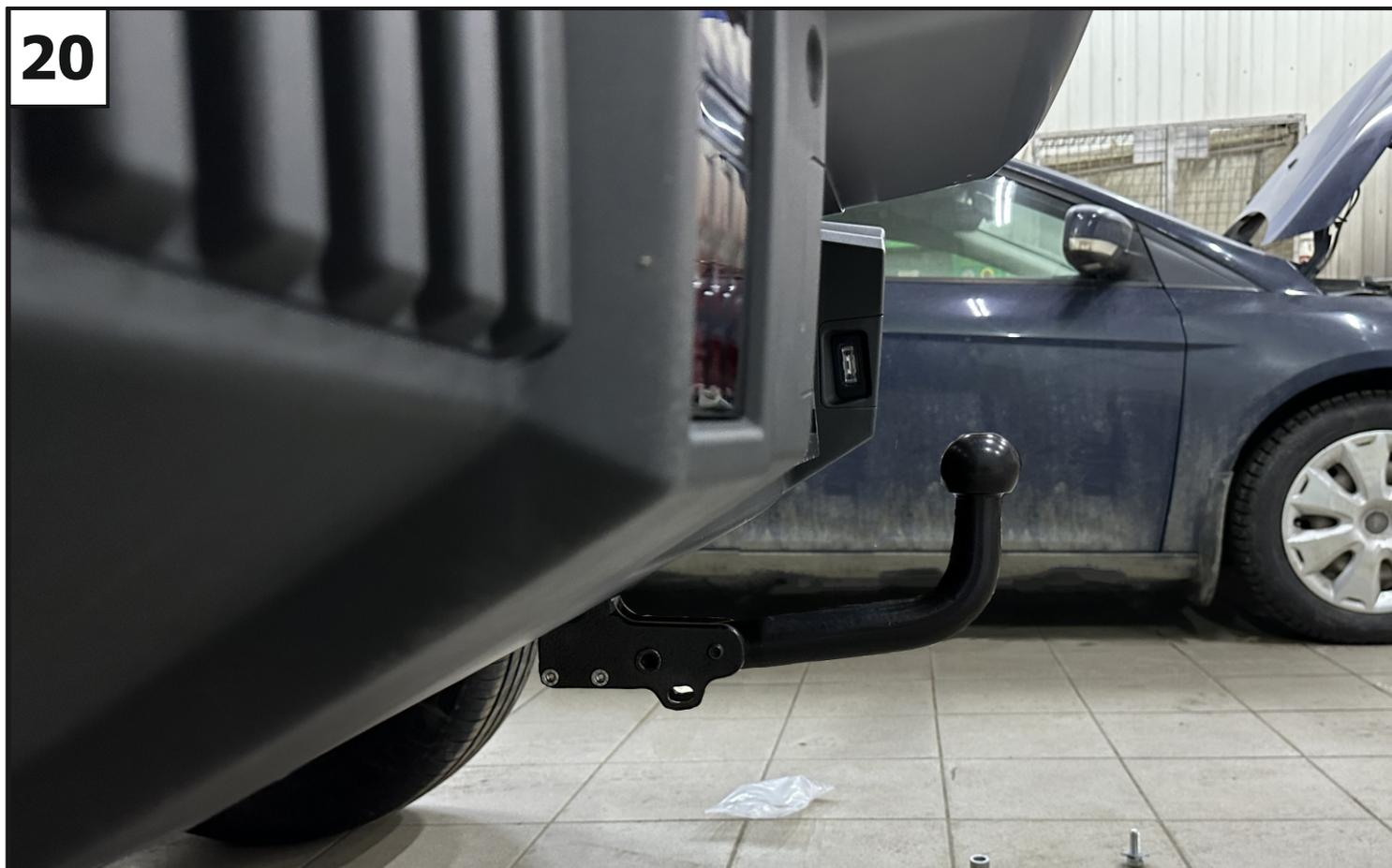
Установить вставку быстросъема в ответную часть. Закрепить крюк (10) с помощью винтов М12х45 (16). Затянуть все резьбовые соединения. Момент затяжки: М12=81 Нм.
