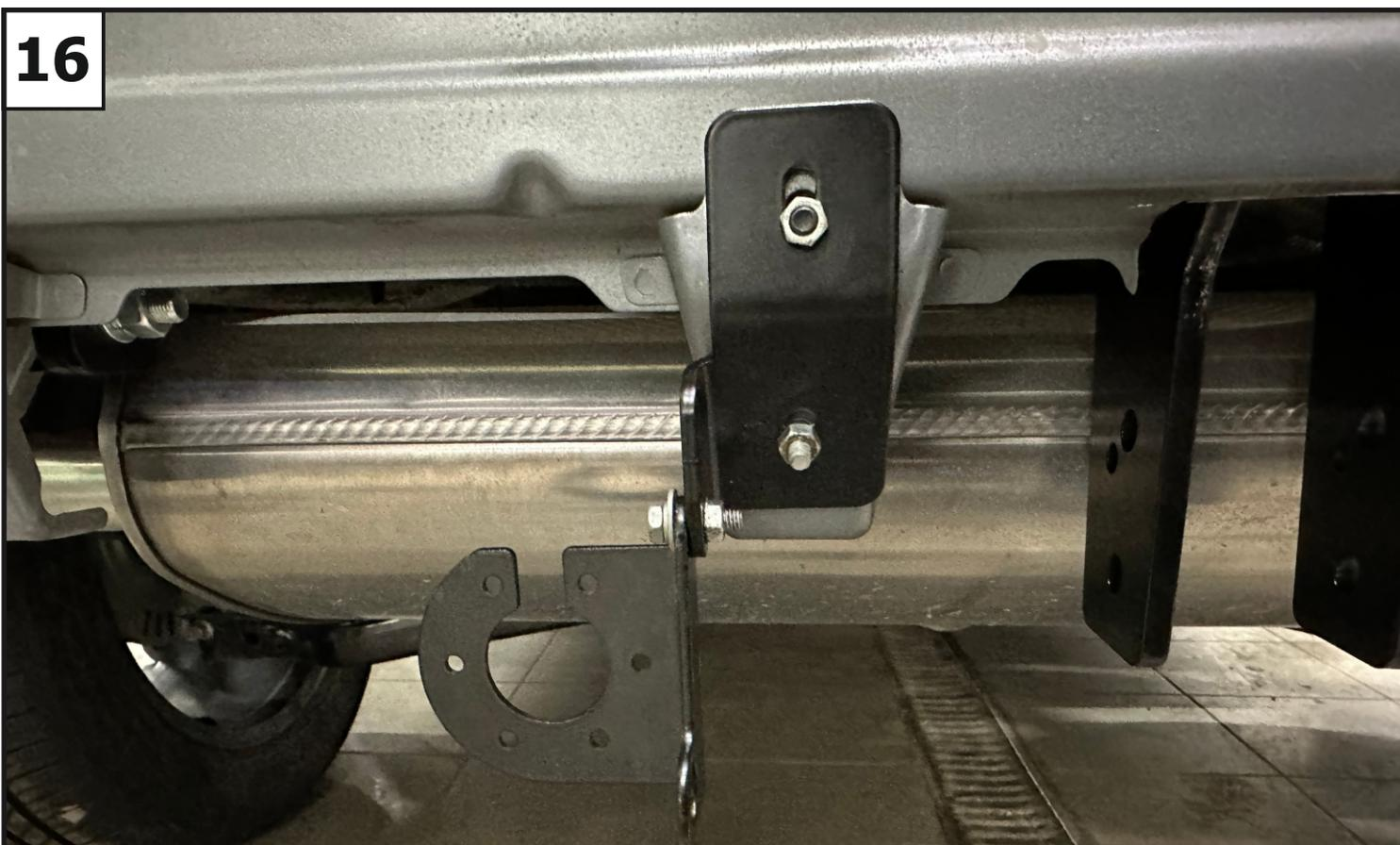
Установить кронштейн под розетку (8), закрепив его к усилителю бампера с помощью крепления подрозетника (7), болтов М6х25 (12), шайб 6 пружинных (23), шайб 6 увел. (24), шайб 6 полиам. (25), гаек М6 (19) и гайки М6 самоконтр. (20). Затянуть все резьбовые соединения. Момент затяжки: М6=6 Нм.
