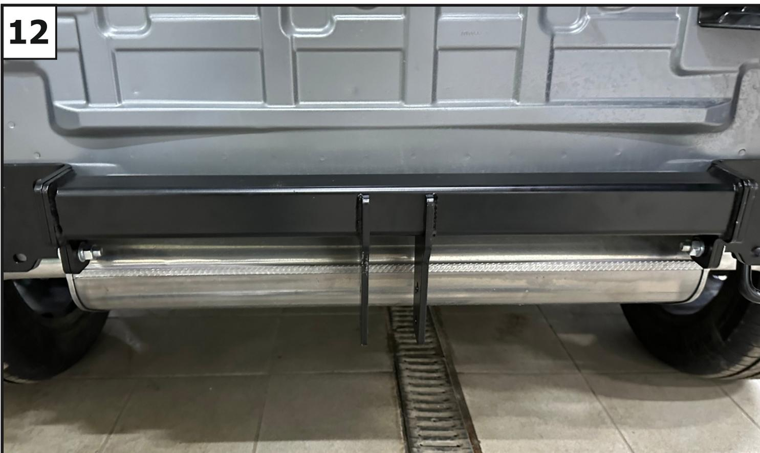
Прогнать резьбовые отверстия балки при помощи метчика М12х1,25. Установить балку (1), закрепив её с помощью болтов М12х1,25х40 (14), гаек М12х1,25 (21), шайб 12 пружинных (28) и шайб 12 (29). Затянуть резьбовые соединения: балку с кронштейнами. Момент затяжки: М12=81 Нм.
