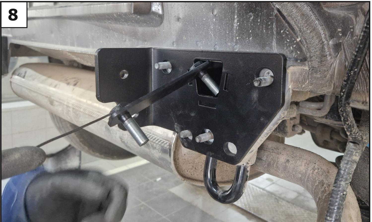
**Установить закладную М12х1,25 (11) в лонжерон авто через кронштейн правый (3), закрепив её с помощью гаек М12х1,25 (21), шайб 12 пружинных (28), шайб 12 у вел. (30) и шайбы 12-Ø60 мм (6). Установить буксировочную петлю в обратном порядке.**
