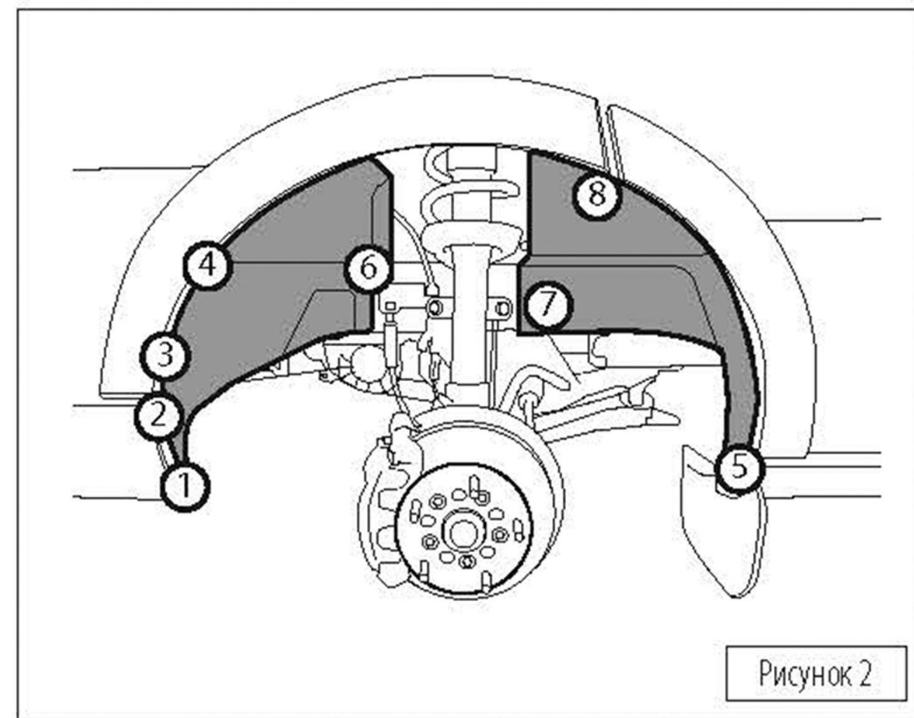
Снять колесо. Демонтировать штатные крепежные элементы в точках 1-5, отмеченных черными кругами на рисунке 1. Отогнуть брызговик.
