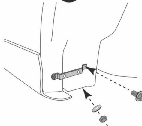
Установить кронштейн в точке сверления подкрылка на винт, гайку и шайбу из комплекта.
