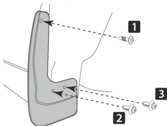
Установить брызговик. В точке 1 установить штатный саморез. В точках 2 и 3 установить клипсы с резьбой из комплекта поставки.
