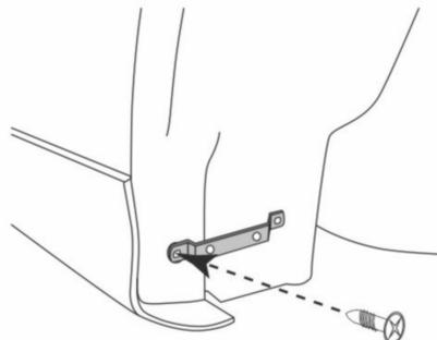
Установить кронштейн из комплекта поставки, зафиксировать штатным саморезом.
