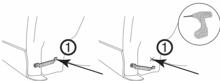
Приложить брызговик, отрегулировать положение кронштейна так, чтобы отверстия на кронштейне и брызговике совпали. Через овальный паз кронштейна отметить точку крепления в подкрылке. Просверлить отверстие Ø6мм.
