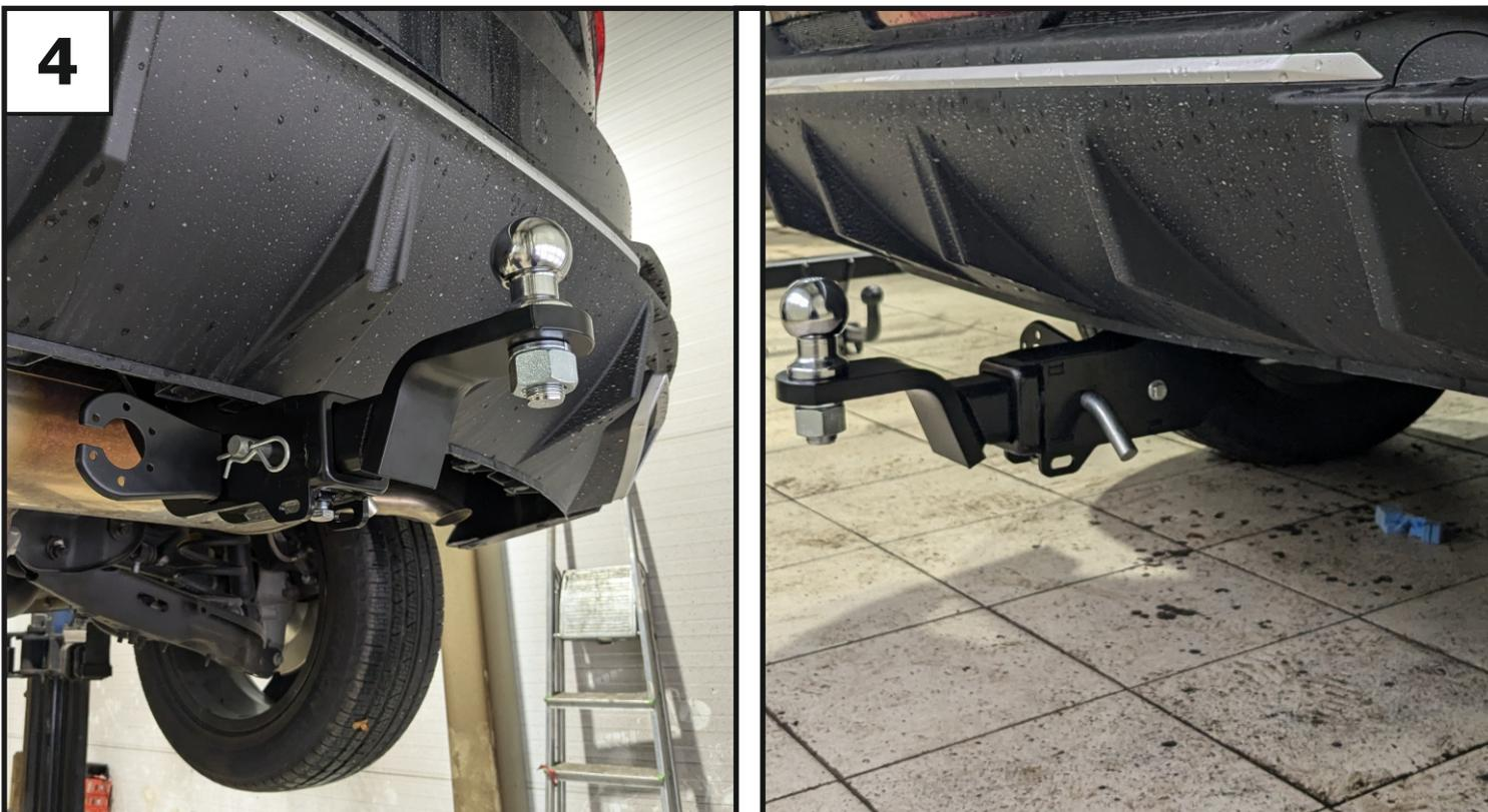
Установить кронштейн под розетку (9) с помощью болта М8х80 (10), шайбы 8 пружинной (16), шайбы 8 (17), шайбы 8 увел. (18) и гайки М8 (14). Установить переходник (5), закрепив с помощью штифта (7) и шплинта (8). Зафиксировать переходник болтом М10х20 (11) - фиксацию использовать без нагрузки. Установить на переходник шар (6), закрепив гайкой М24 (25) с шайбой 24 пруж. (24). Затянуть резьбовые соединения. Моменты затяжки: М8=25 Нм; 24=95 Нм.
