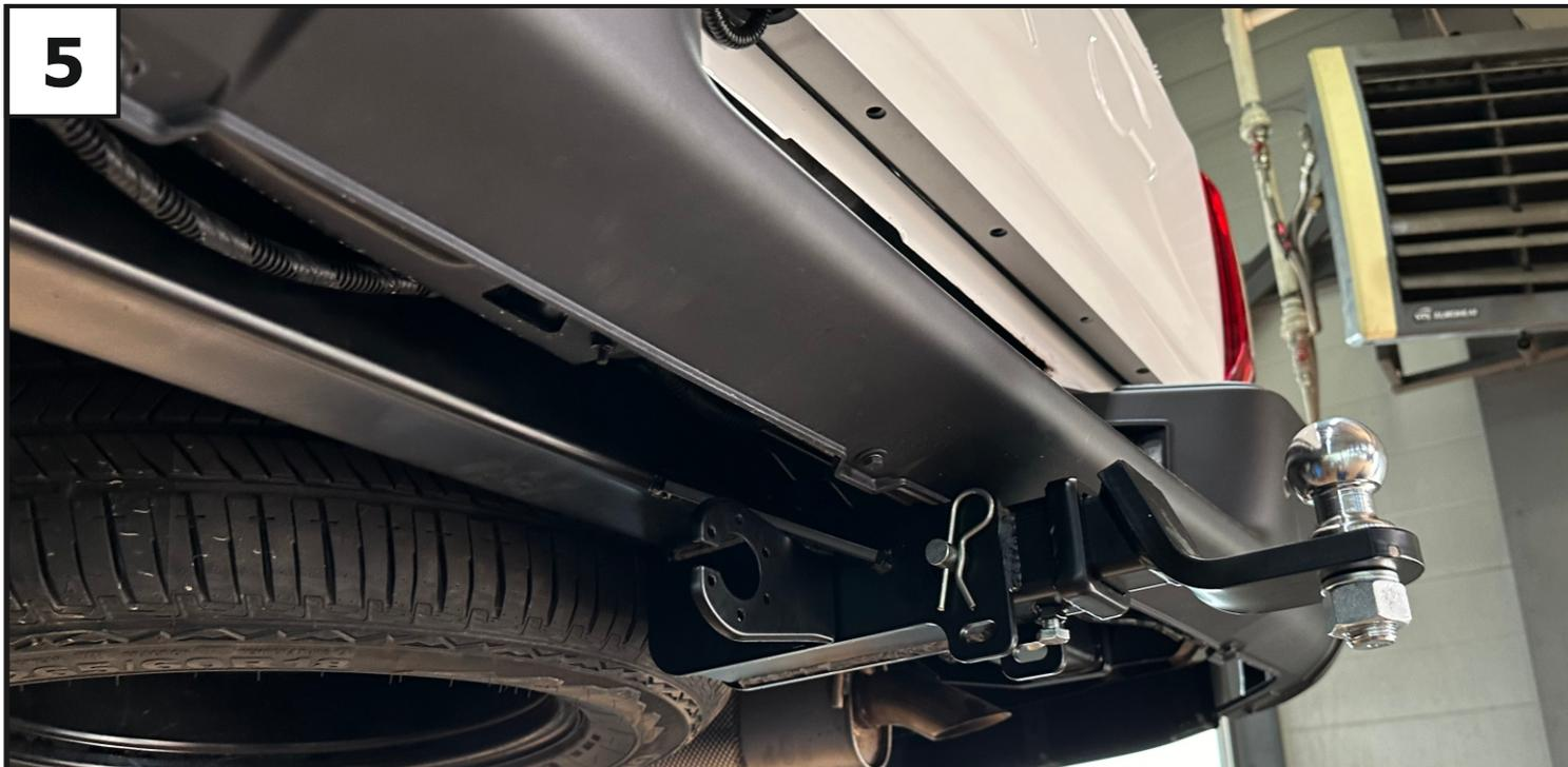
**Установить кронштейн под розетку (9) с помощью болта M8x100 (10), шайбы 8 пружинной (15), шайбы 8 (16), шайбы 8 увел. (17) и гайки M8 (13). Затянуть резьбовое соединение. Момент затяжки: M8=25 Нм.**
