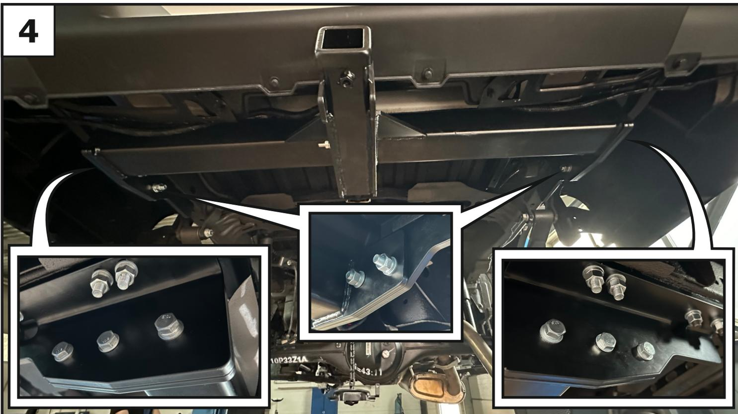
Прогнать резьбовые отверстия балки (1) с помощью метчика М12х1,25. Установить балку (1), закрепив её к кронштейнам с помощью болтов М12х1,25х40 (12), шайб 12 пружинных (18), шайб 12 (19) и гаек М12х1,25 (14). Затянуть все резьбовые соединения: сначала балку с кронштейнами, затем кронштейны с лонжеронами. Моменты затяжки: М12=81 Нм.
