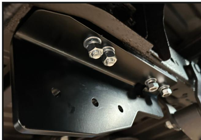
К установленным закладным и болтам закрепить левый и правый кронштейны (2 и 3) с помощью гаек М12х1,25 (14), шайб 12 пружинных (18), шайб 12 (19) и шайб 12 увел. (20).
