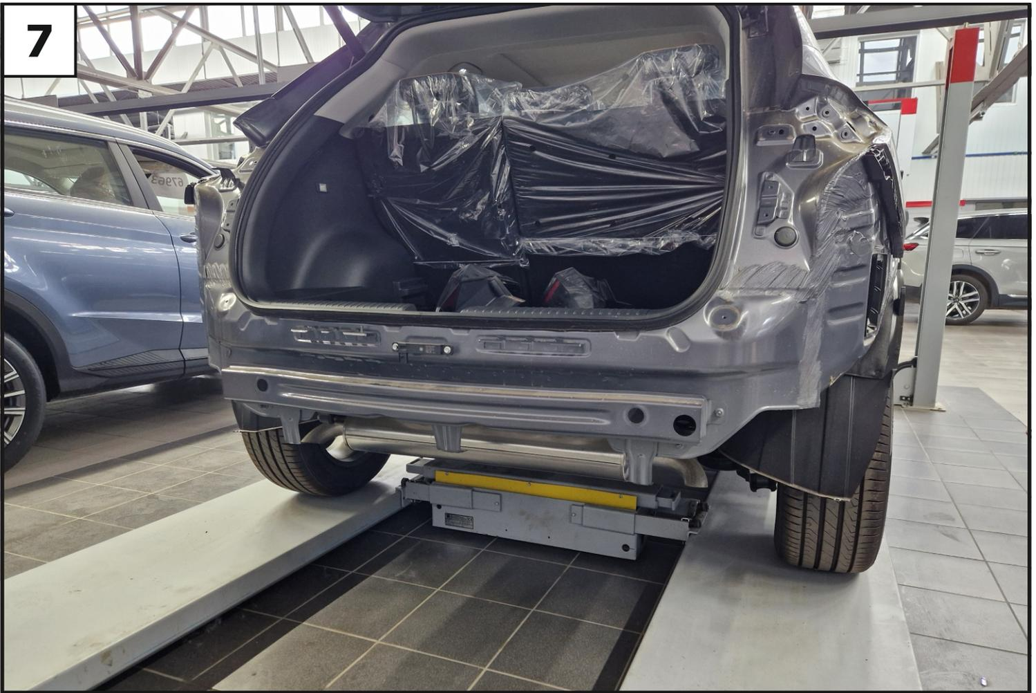
Снять задний бампер, отключив разъемы электропроводки.
