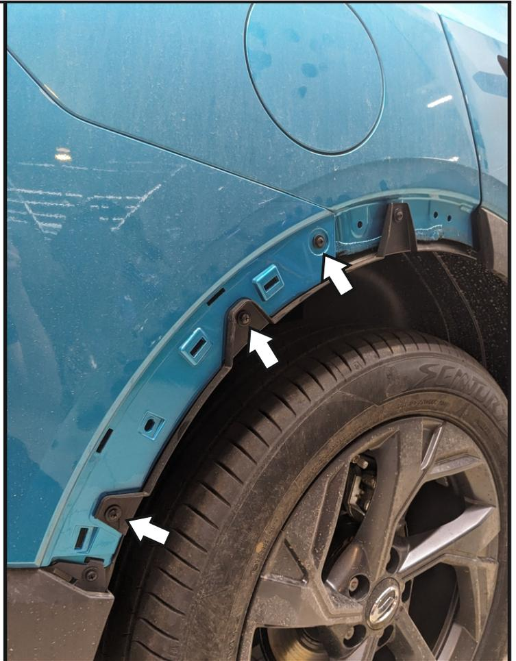
**Демонтировать боковые накладку, выкрутить винт крепления бампера и винты крепления подкрылка.**
