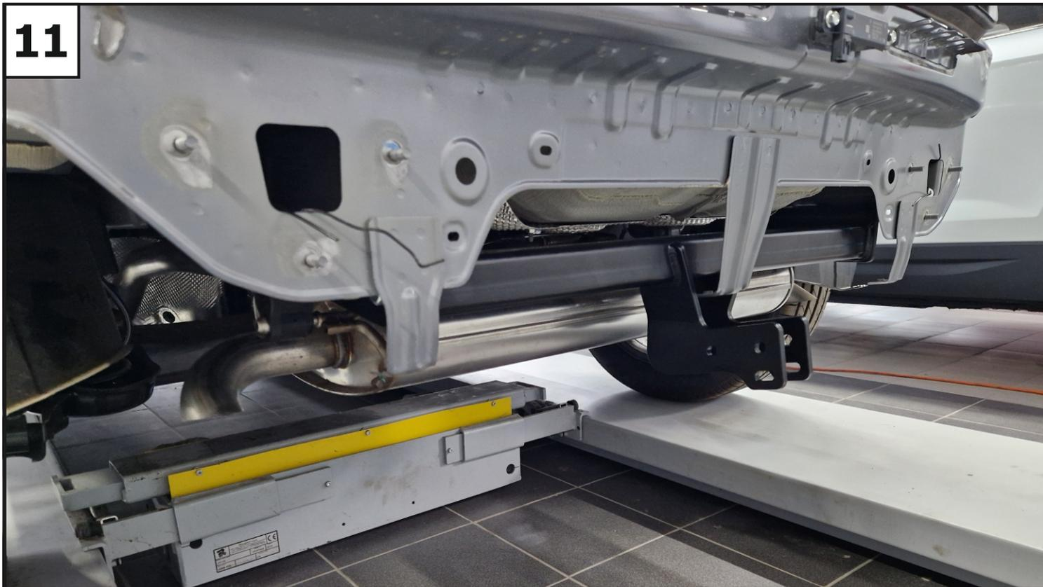
Прогнать резьбовые отверстия балки (1) с помощью метчика М12х1,25. Установить балку (1), закрепив её к кронштейнам с помощью болтов М12х1,25х40 (9), гаек М12х1,25 (11), шайб 12 пружинных (12) и шайб 12 (13). Затянуть все резьбовые соединения: сначала балку с кронштейнами, затем кронштейны с лонжеронами. Моменты затяжки: М12=81 Нм.
