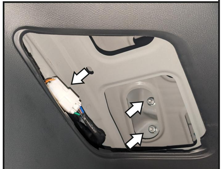
Отключить разъемы электропроводки и выкрутить гайки крепления задних фонарей.
