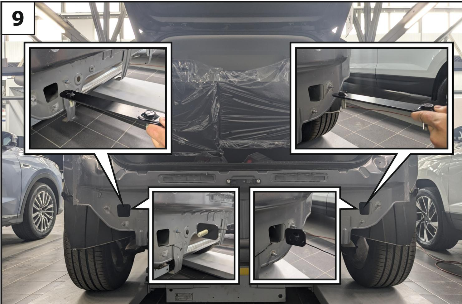
Установить закладные (4 и 5) в лонжероны через отверстия в задней панели автомобиля.
