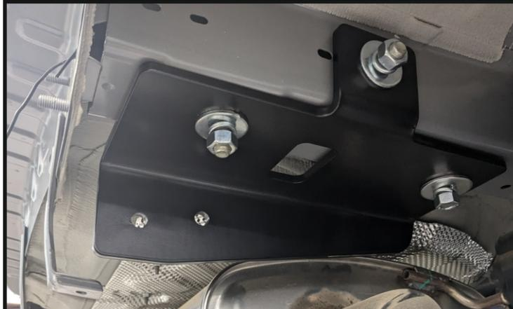
Снять глушитель с левого подвеса для возможности установки левого кронштейна (2). Установить левый и правый кронштейны (2 и 3), закрепив их к установленным закладным с помощью гаек М12х1,25 (11), шайб 12 пружин. (12) и шайб 12 увел. (14).
