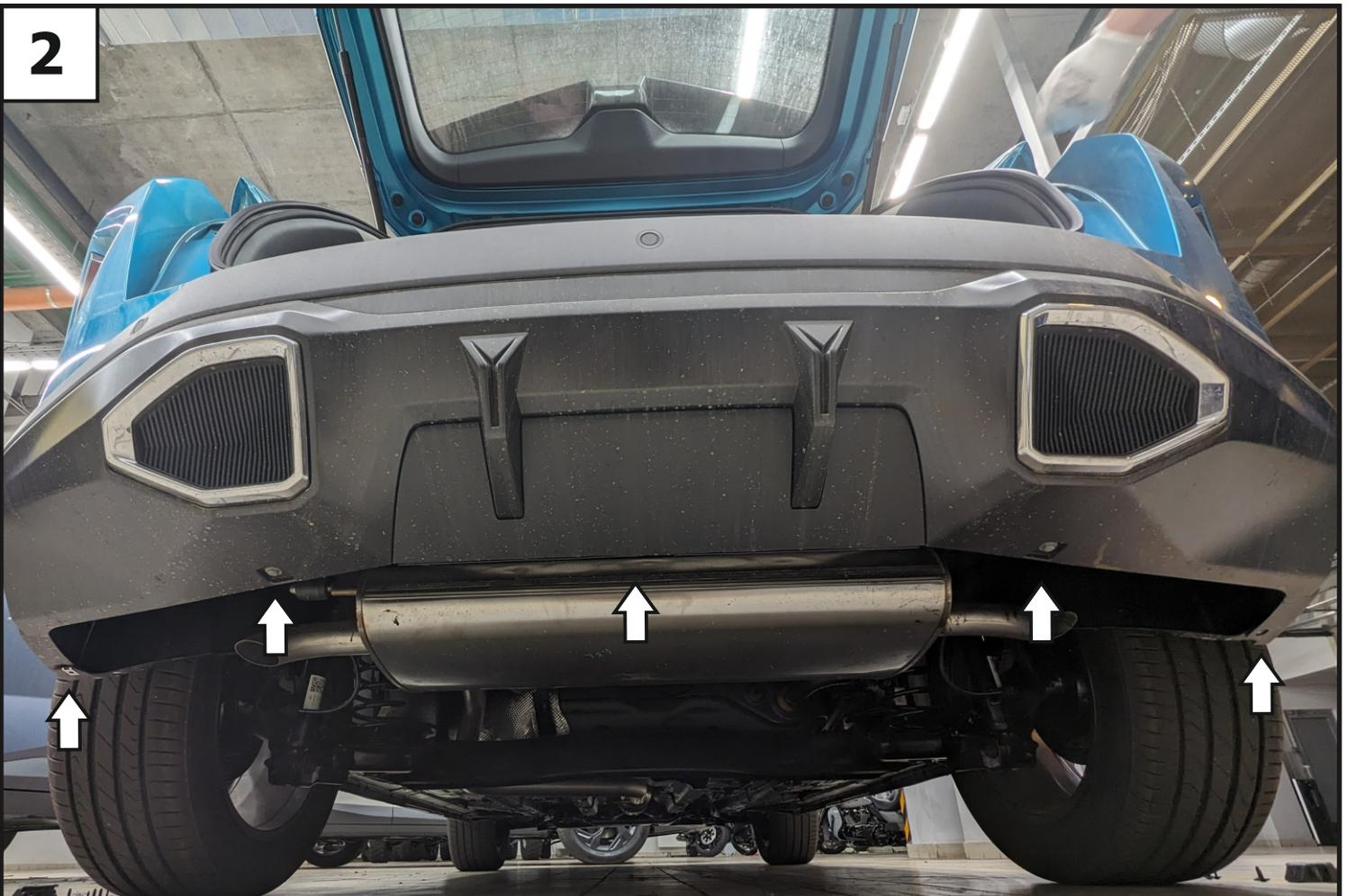
**Выкрутить нижние болты и винты крепления бампера.**
