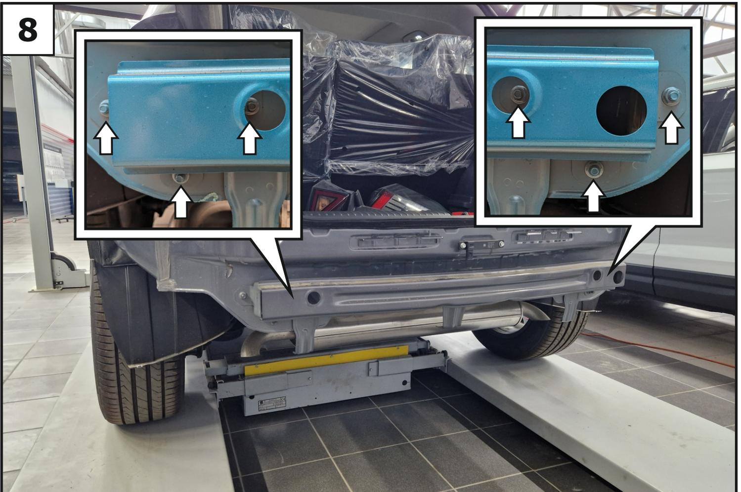
Демонтировать усилитель бампера, открутив штатные гайки.
