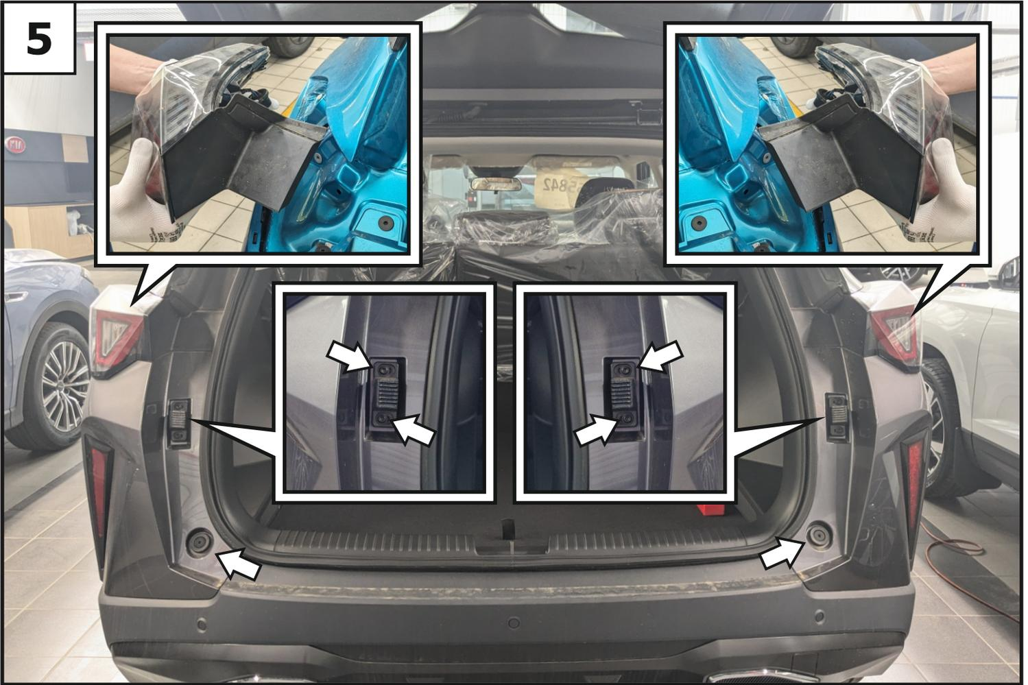
**Выкрутить винты крепления бампера. Демонтировать задние фонари.**
