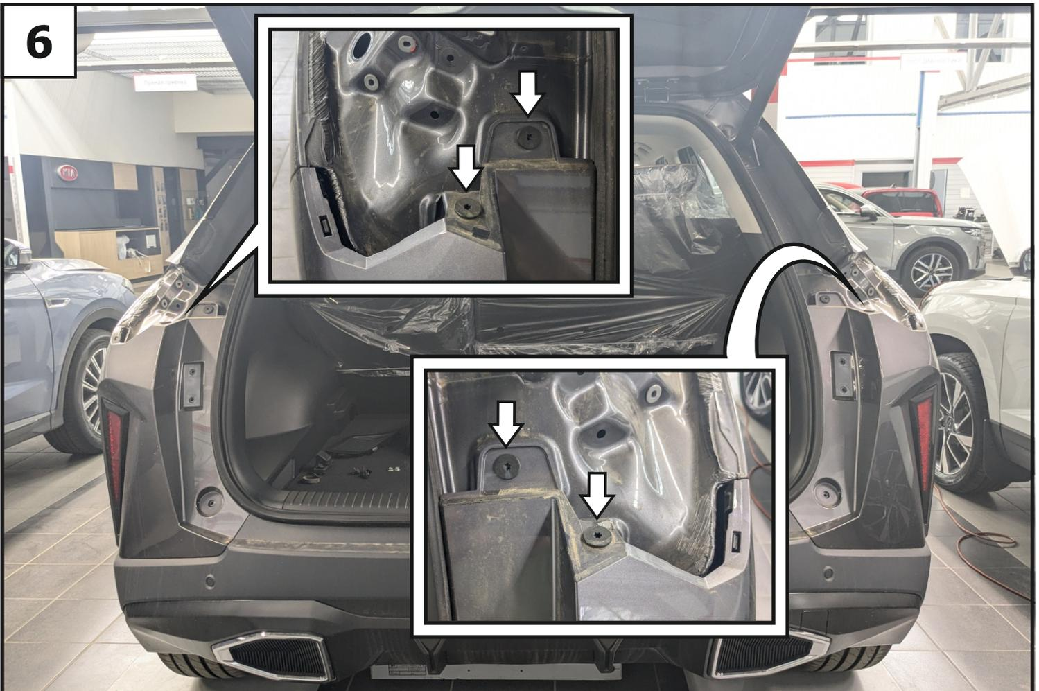
**Выкрутить расположенные под задними фонарями винты крепления бампера.**
