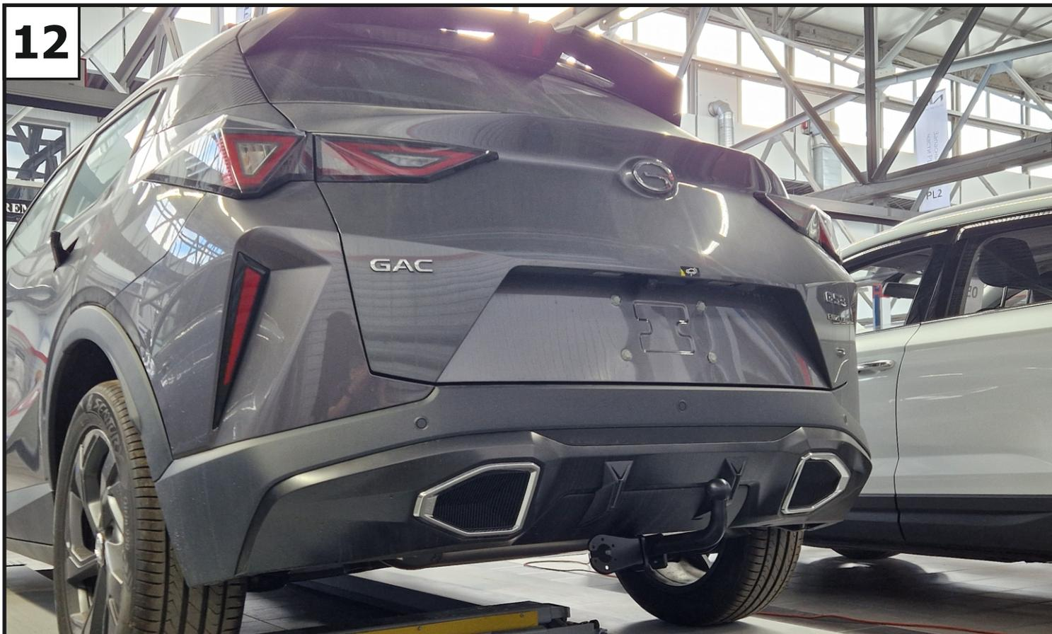
Установить глушитель на левый подвес. Установить усилитель и бампер в обратном порядке. Закрепить кронштейн под розетку (7), крюк (8) и проставки (6) помощью болтов М12х1,25х90 (10), гаек М12х1,25 (11), шайб 12 пружинных (12) и шайб 12 (13). Затянуть резьбовые соединения. Моменты затяжки: М12=81 Нм.
