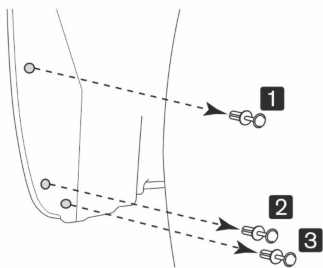
Произведите демонтаж штатных пластиковых фиксаторов.
