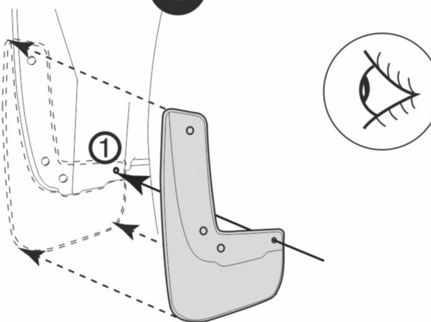
Проведите визуальную примерку изделия, приложив к планируемому месту монтажа. Согласно отверстию 1 на брызговике, отметьте точку для сверления в подкрыльке.
