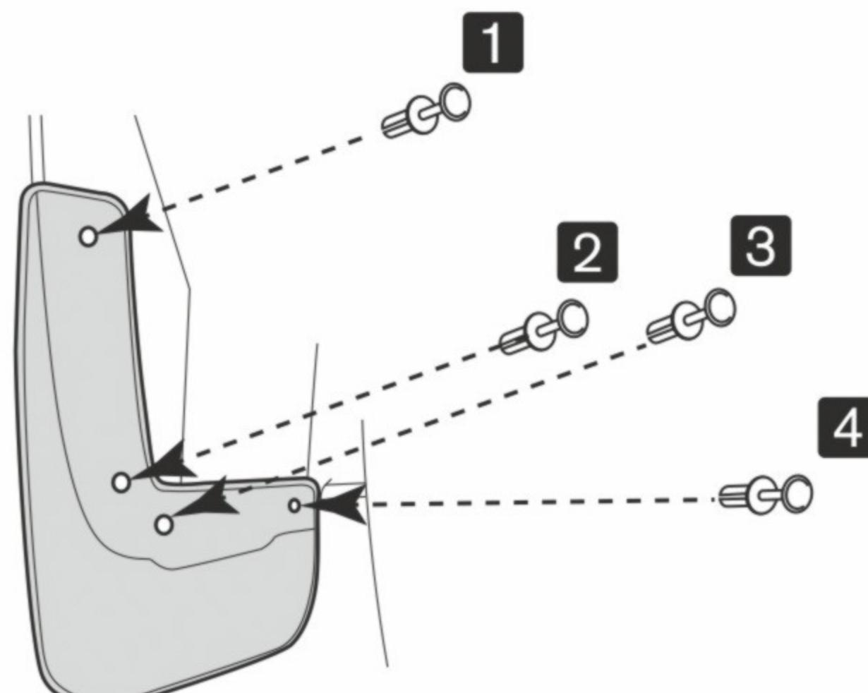
Установите ранее демонтированные штатные пластиковые фиксаторы в точках 1-3, в точке 4 установите пластиковый фиксатор из комплекта поставки.
