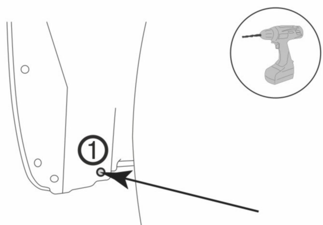
Используя сверло Ø 8 мм, просверлите отверстие в подкрыльке в отмеченной точке.
