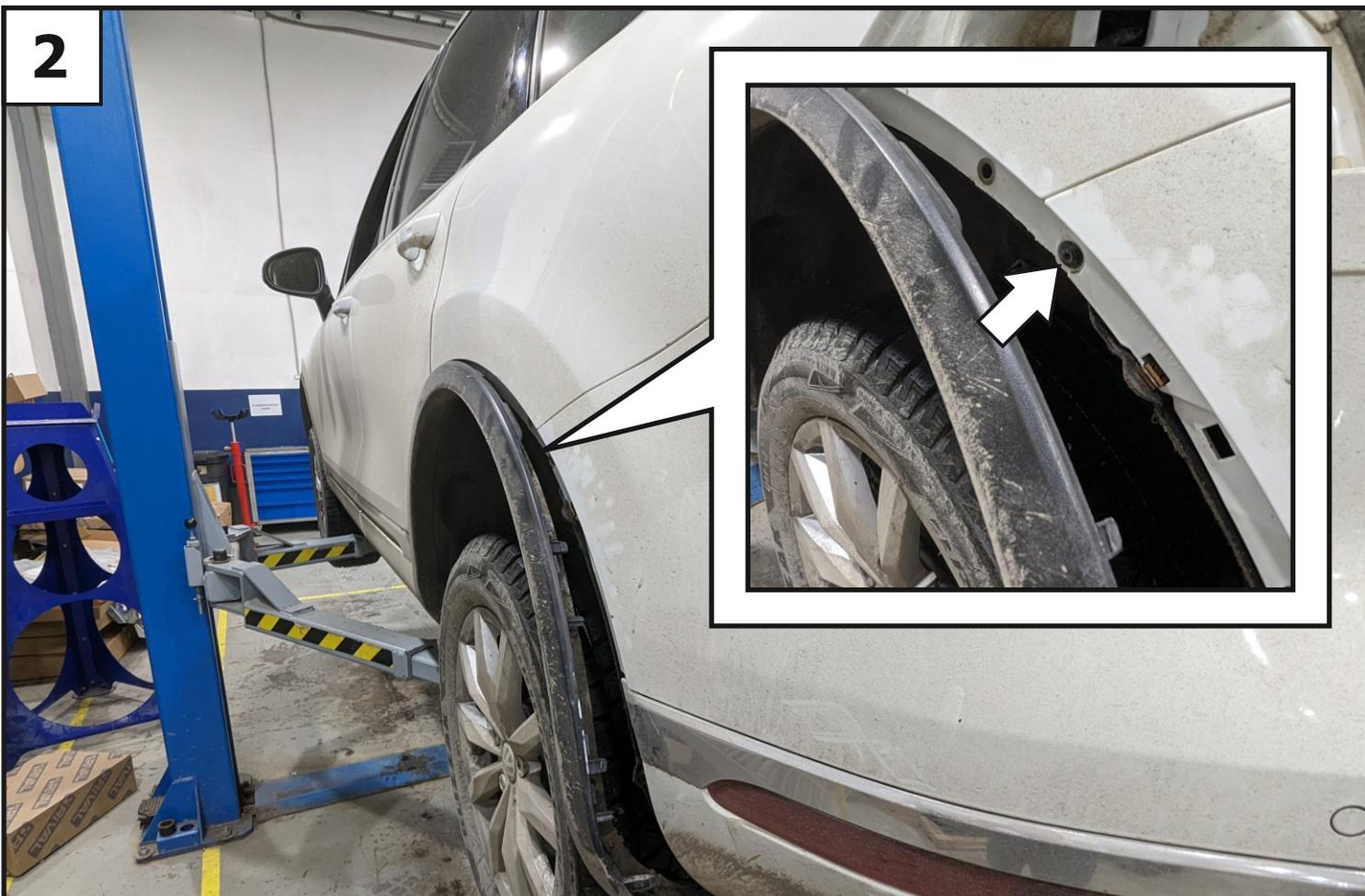
Снять боковую накладку и открутить расположенный под ней винт крепления бампера. С другой стороны аналогично.
