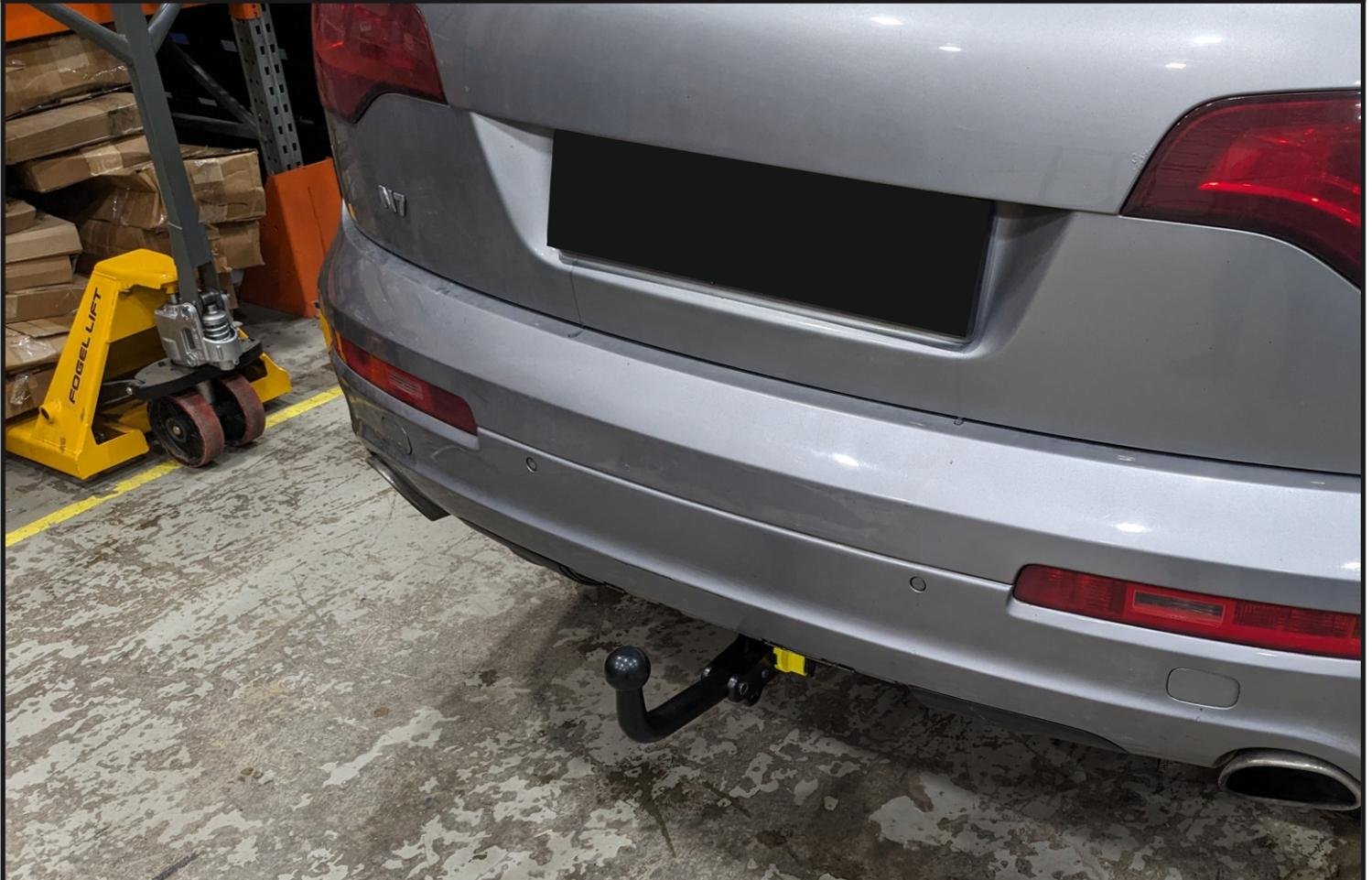
Установить бампер в обратном порядке. Установить вставку быстросъема в ответную часть. Закрепить крюк с помощью винтов M12x45 (8). Затянуть все резьбовые соединения. Момент затяжки: M12=81 Нм.
