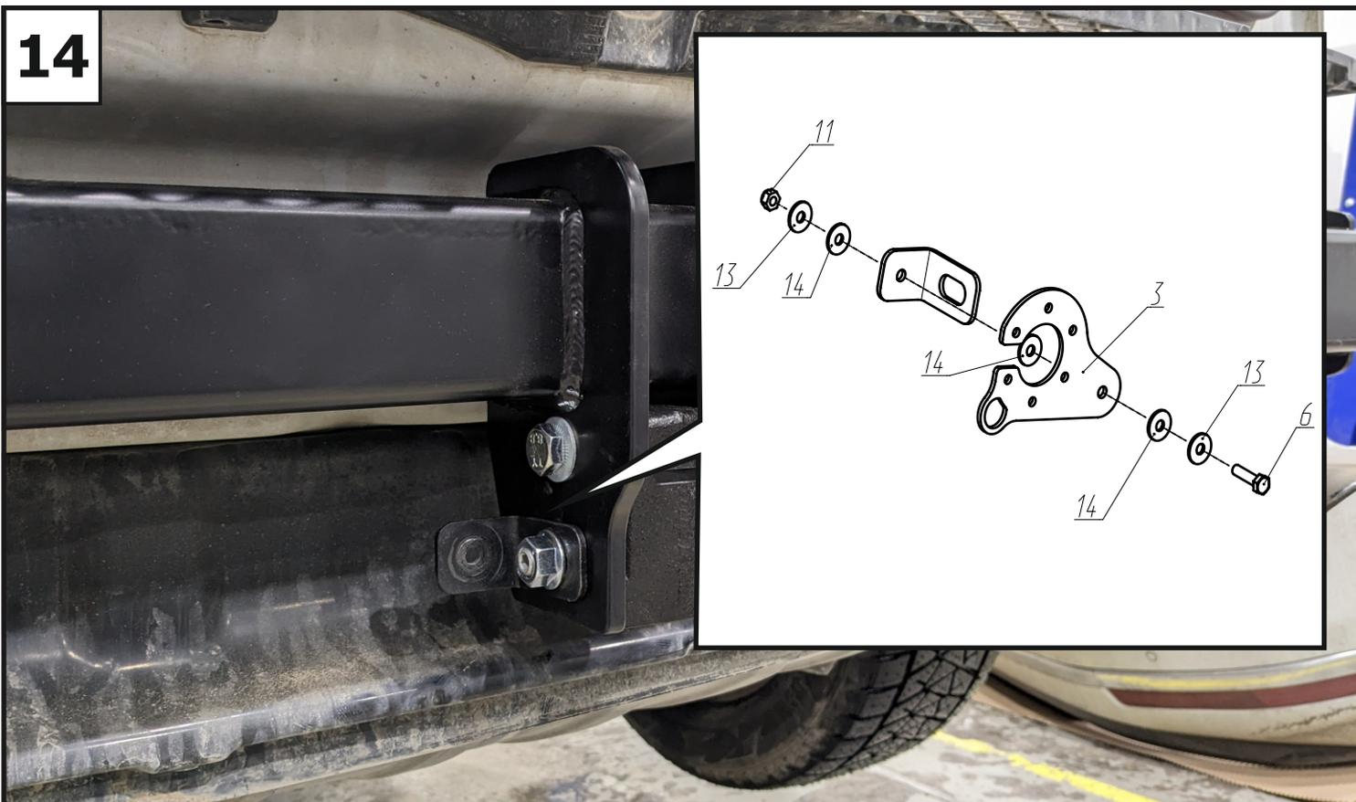
Установить подрозетник (3) с помощью болта М6х25 (6), гайки М6 (11), шайб 6 увеличенных (13) и шайб 6 полиамидных (14). Затянуть все резьбовые соединения: сначала быстростъем к балке, затем подрозетник к уголку. Моменты затяжки: М6=10 Нм; М12=81 Нм.
