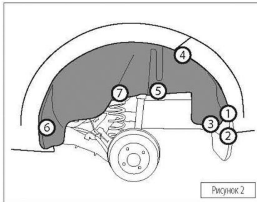
Зафиксировать подкрылок, используя элементы штатного крепежа соблюдая последовательность, указанную на рисунке 2 в кругах белого цвета. В точке 6 установить саморез из комплекта поставки, в точке 7 пластиковый фиксатор из комплекта поставки.
