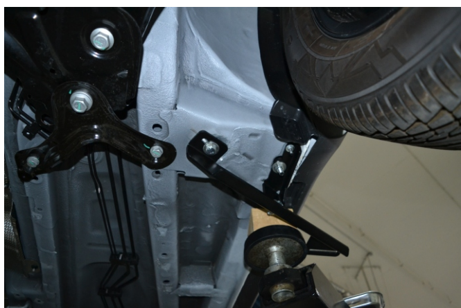
Рис. 3 - Установка передних кронштейнов
