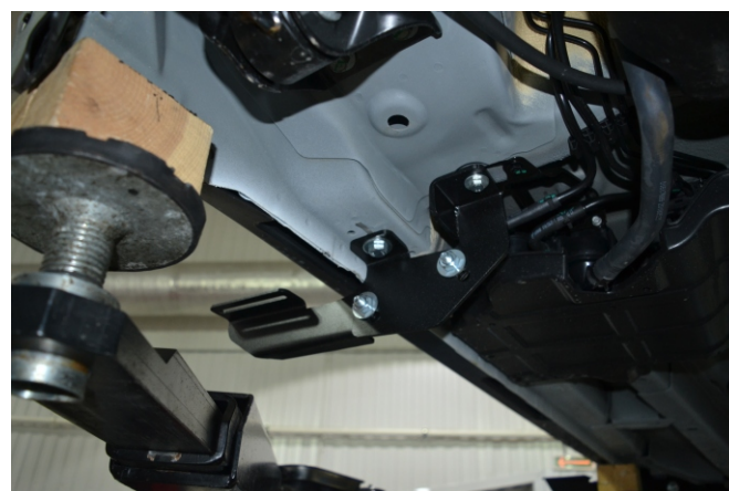
Рис. 4 - Установка задних кронштейнов
