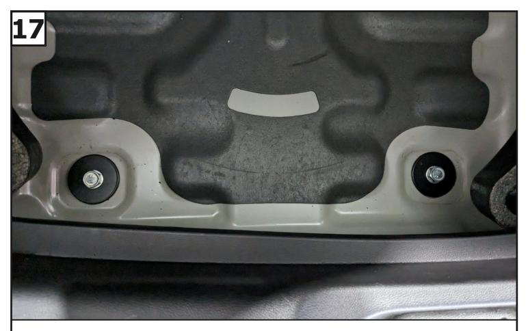
Закрепить балку к нише запасного колеса с помощью проставок балки (6), шайб (8), болтов M12x1,25x50 (13), шайб 12 (19), шайб 12 пружинных (18) и гаек M12x1,25 (15).
