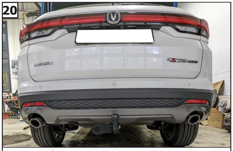
Затянуть все резьбовые соединения. Моменты затяжки: М12=81 Нм.
