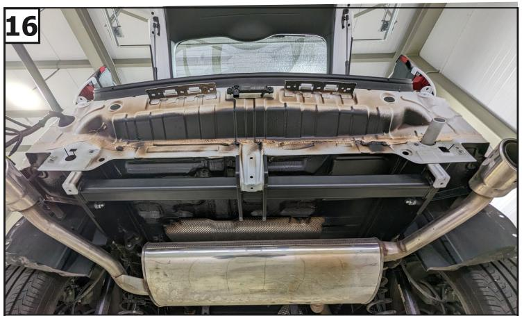
Перед установкой балки (1) прогнать её резьбовые отверстия при помощи метчика M12x1,25. Затем установить балку (1), закрепив ее к кронштейнам с помощью болтов M12x1,25x40 (12), гаек M12x1,25 (15), шайб 12 пружинных (18) и шайб 12 (19).
