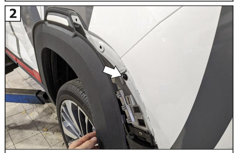
Снять боковую накладку и выкрутить винт крепления бампера. С другой стороны аналогично.
