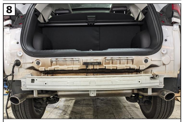
Отсоединить крепления проводки бампера от усилителя.
