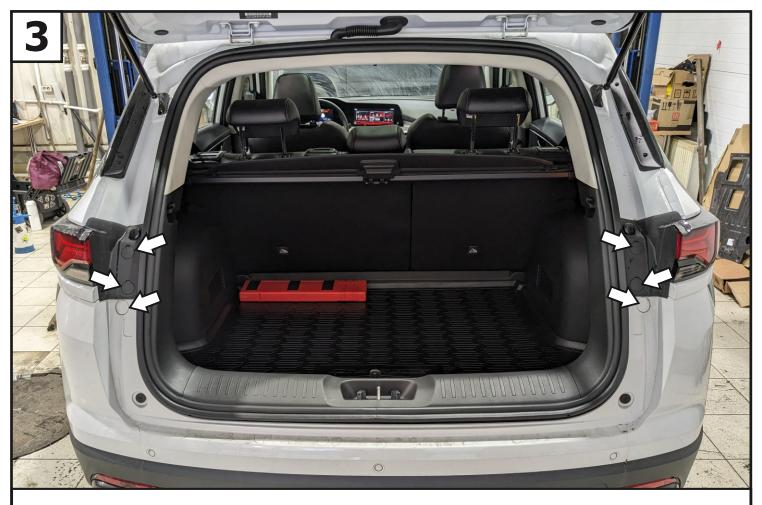
Снять заглушки крепления фонарей и бампера.
