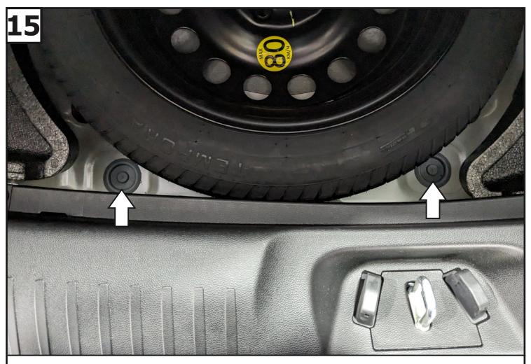
В нише запасного колеса снять заглушки.
