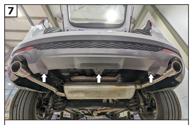
Выкрутить нижние болты крепления бампера и снять бампер.
