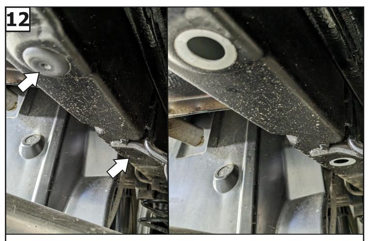
Снять заглушки нижних отверстий лонжерона. С другой стороны аналогично.
