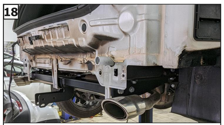
Отрегулировать положение балки относительно центра автомобиля и затянуть все резьбовые соединения: сначала балку с кронштейнами, затем с нишей запасного колеса, после - кронштейны с лонжеронами. Моменты затяжки: M10=47 Hm; M12=81 Hm. Установить усилитель и бампер в обратном порядке.
