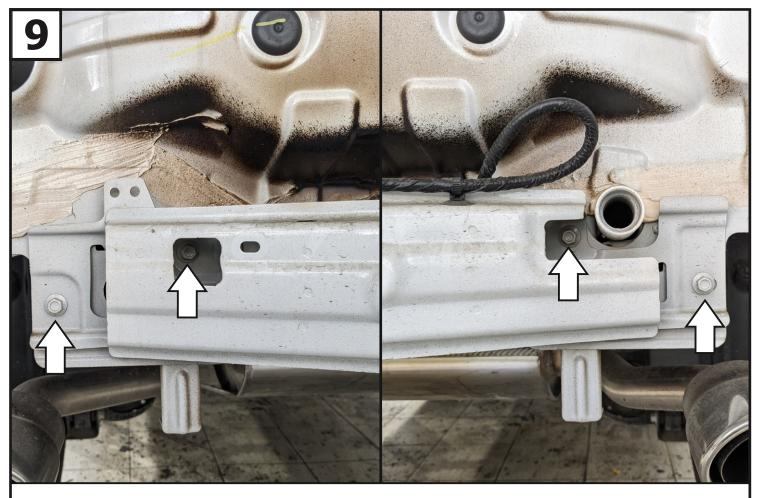
Открутить болты крепления усилителя бампера.
