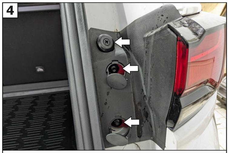
Открутить винты крепления фонарей. Демонтировать задние фонари.
