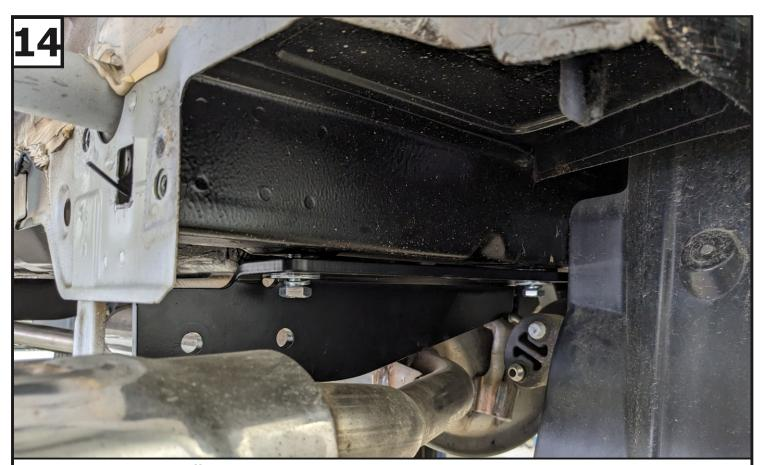
Установить кронштейны (2 и 3), закрепив их к установленным закладным с помощью проставок кронштейна (7), болтов M10x1,25x40 (11), шайб 10 пружинных (16) и шайб 10 увеличенных (17).
