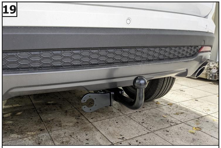
Установить кронштейн под розетку (9) и крюк (10) с помощью проставок (5), болтов M12x1,25x90 (14), шайб 12 (19), шайб 12 пружинных (18) и гаек M12x1,25 (15).
