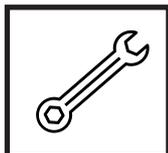
**Затянуть резьбовые соединения балки с кронштейнами, затем кронштейнов с кузовом (M12=81 Nm)**
