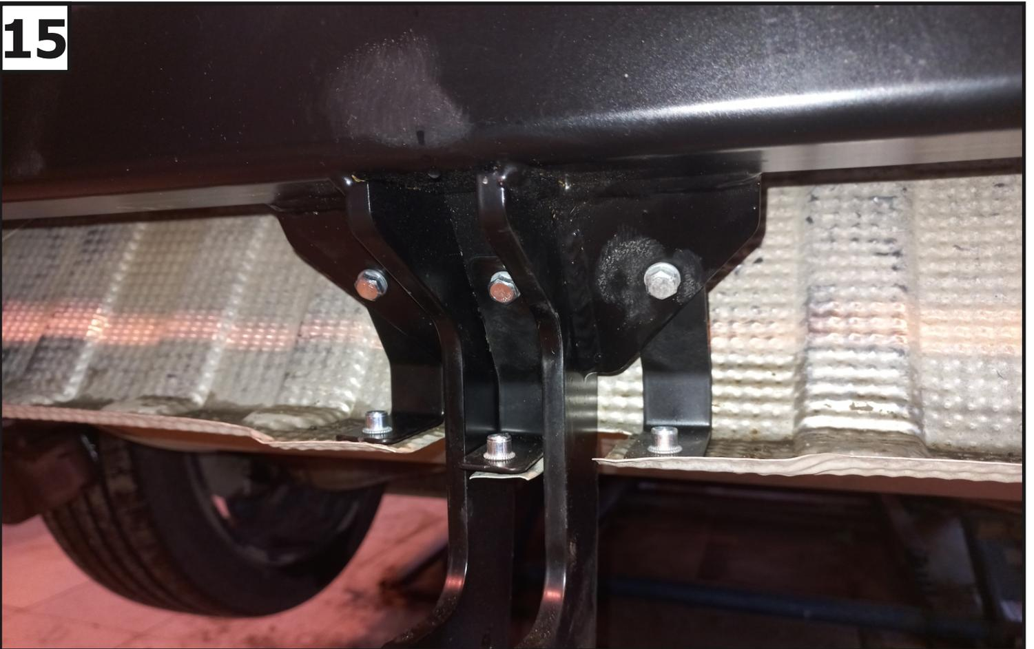
Установить на балку (1) кронштейны бампера (7), закрепив с помощью болтов М6х25 (10), шайбами 6 (17), пружинными шайбами 6 (16), гайками М6 (13). Просверлить отверстия в термоэкране под болты М6 (10) для крепления экрана к крайним кронштейнам (7).
