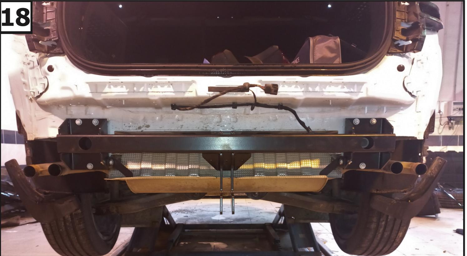
Затянуть все резьбовые соединения, сначала затянуть балку к задней панели, затем усиления и кронштейны бампера, после затянуть усиления к лонжеронам. Моменты затяжки: M6=10 Нм; M10=47 Нм; M12=81 Нм. Установить бампер в обратном порядке, прикрутив нижнюю часть бампера к кронштейну (7, 8 и 9) - с помощью болта M6x25 (10), пружинных шайб 6 (16) и шайб увеличенных 6 (18).
