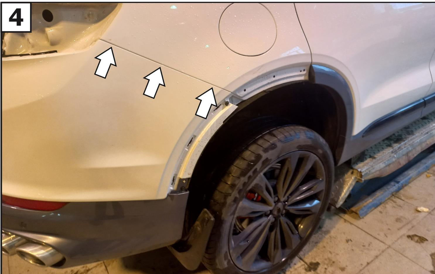
**Отщелкнуть боковые защелки бампера с левой и правой стороны, затем снять задний бампер отсоединив разъем проводки заднего бампера.**
