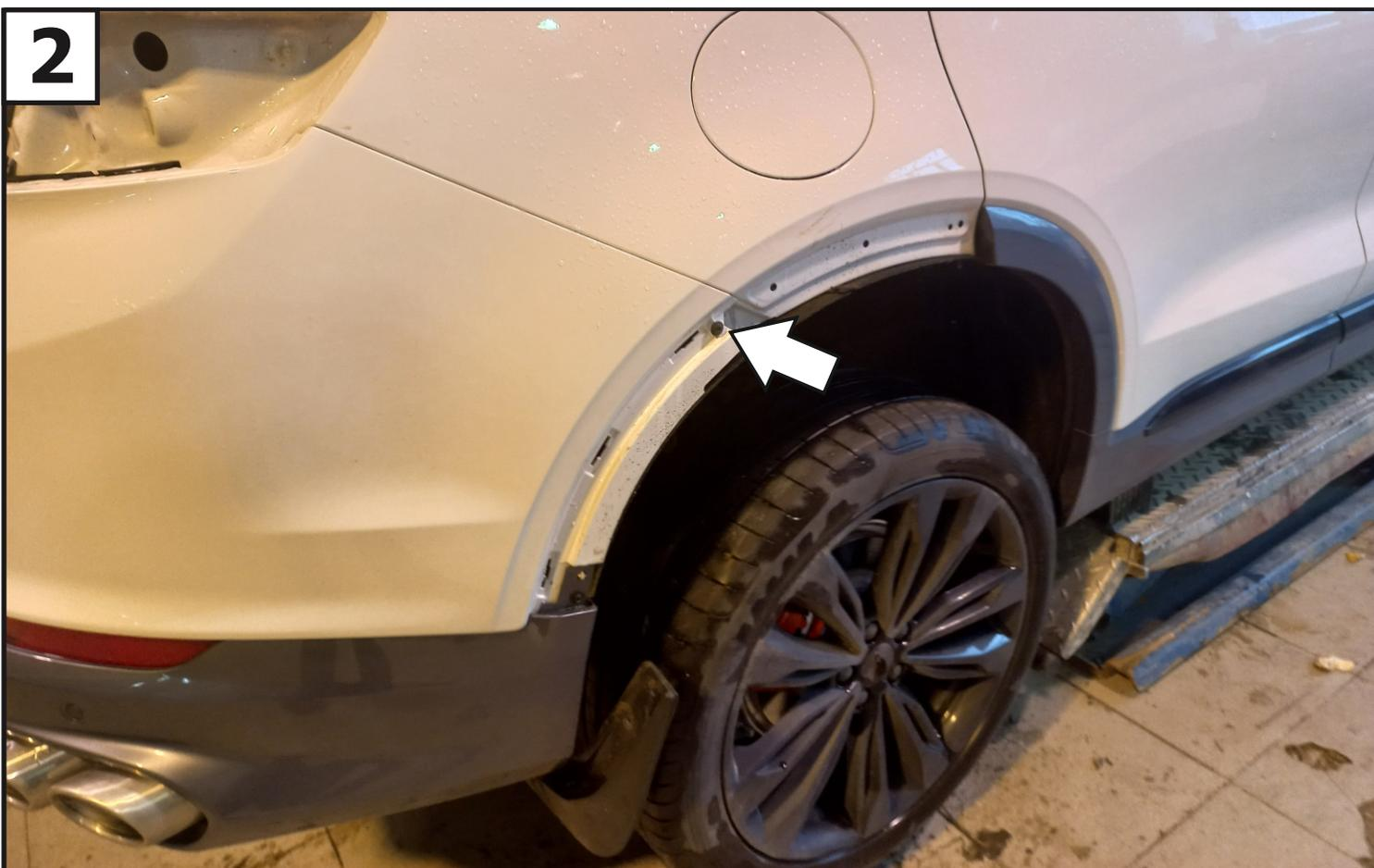
**После демонтажа боковой накладки выкрутить винт крепления бампера. С другой стороны аналогично.**
