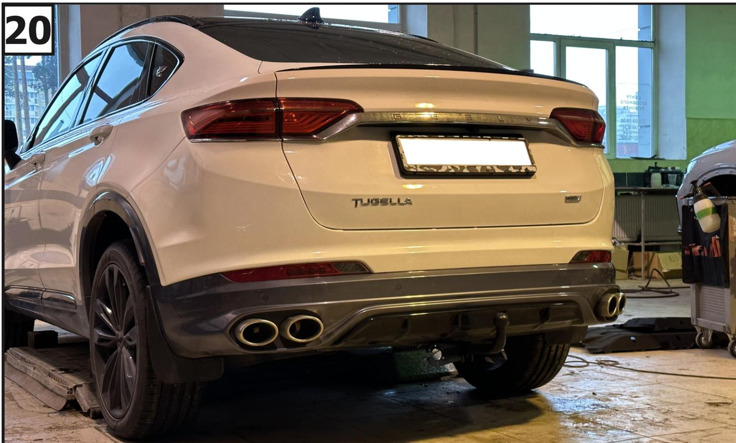
Затянуть все резьбовые соединения. Моменты затяжки: M6=10 Нм; M12=81 Нм.
