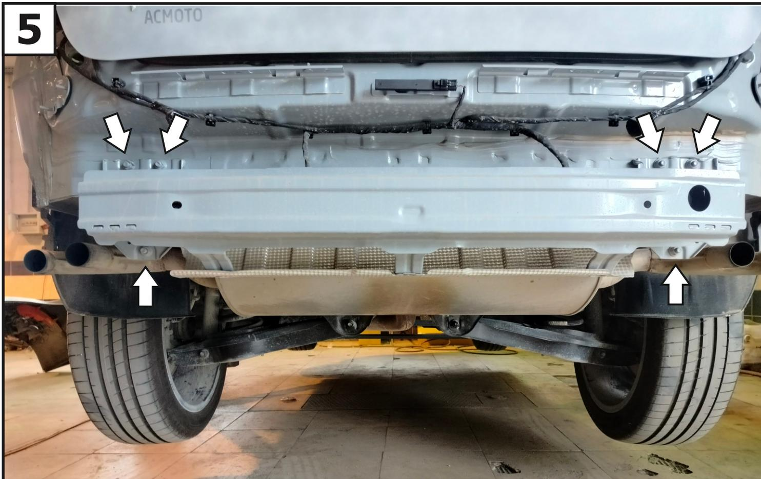
**Открыть гайки крепления усилителя заднего бампера.**
