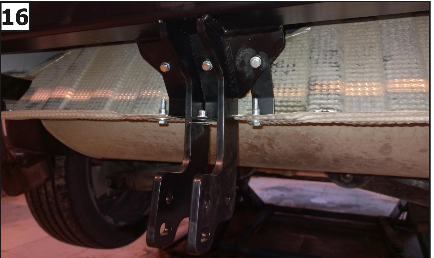
Прикрепить термоэкран к кронштейнам бампера (7) с помощью болтов М6х25 (10), увеличенных шайб 6 (18) и пружинных шайб 6 (16).
