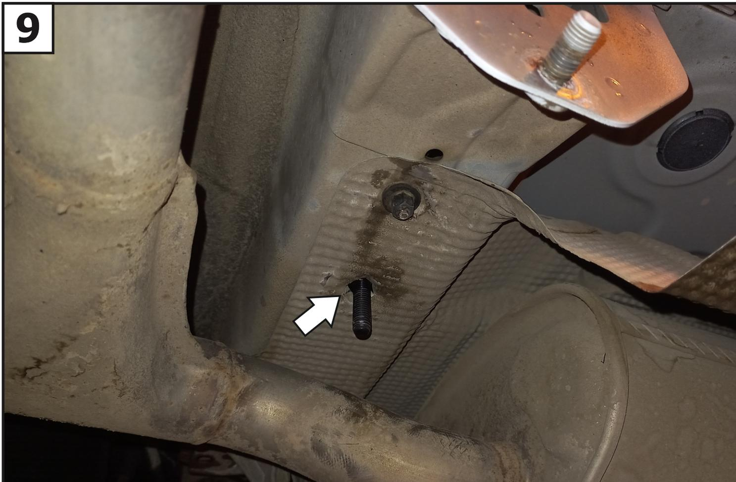
**Под выступающий из лонжерона болт закладной просверлить отверстие в термоэкране. Аналогичную операцию провести с другой стороны.**
