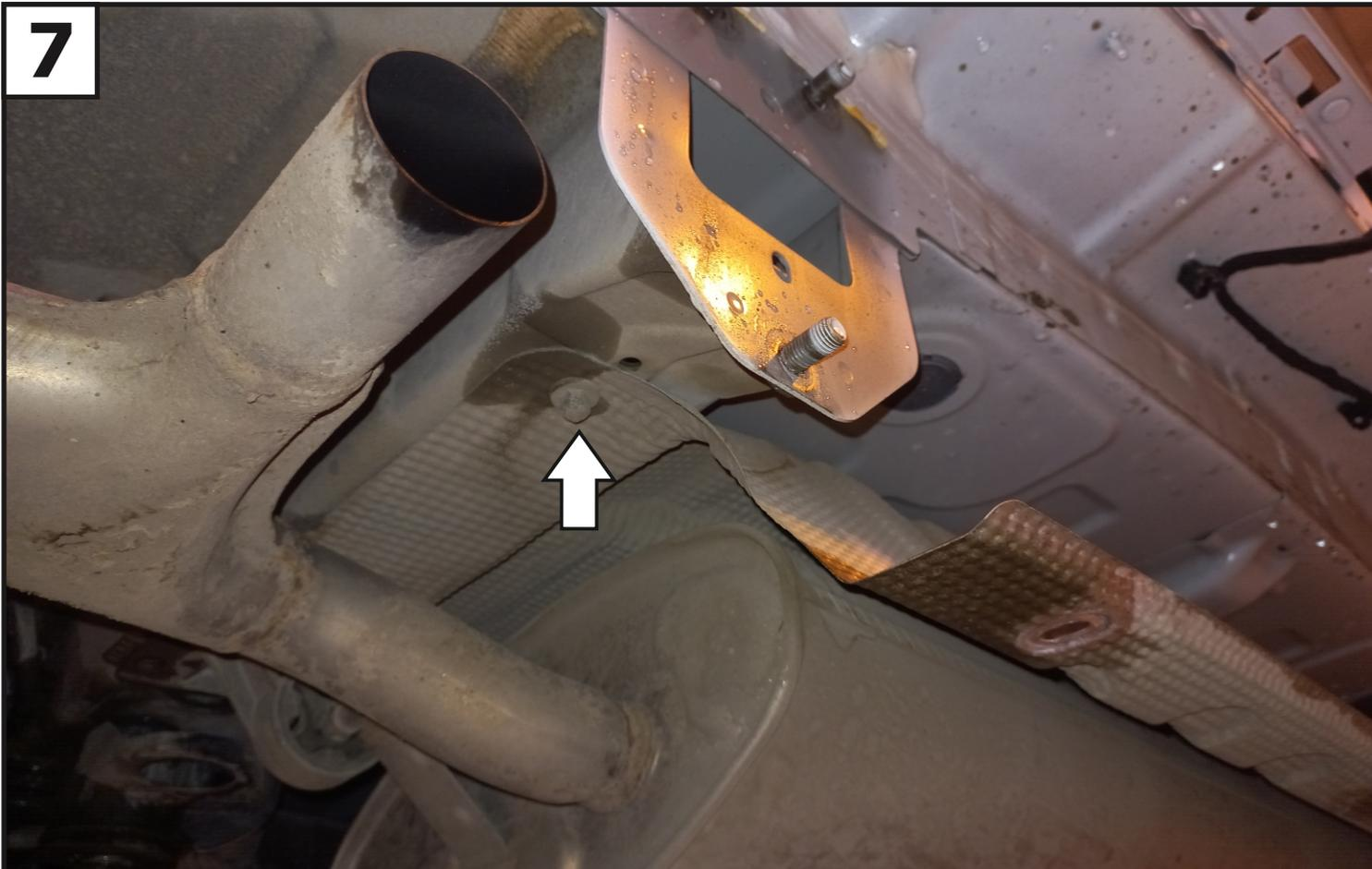
Открутить крепление термоэкрана для определения положения отверстия под установку закладной в лонжероне. Аналогичную операцию провести с другой стороны.
