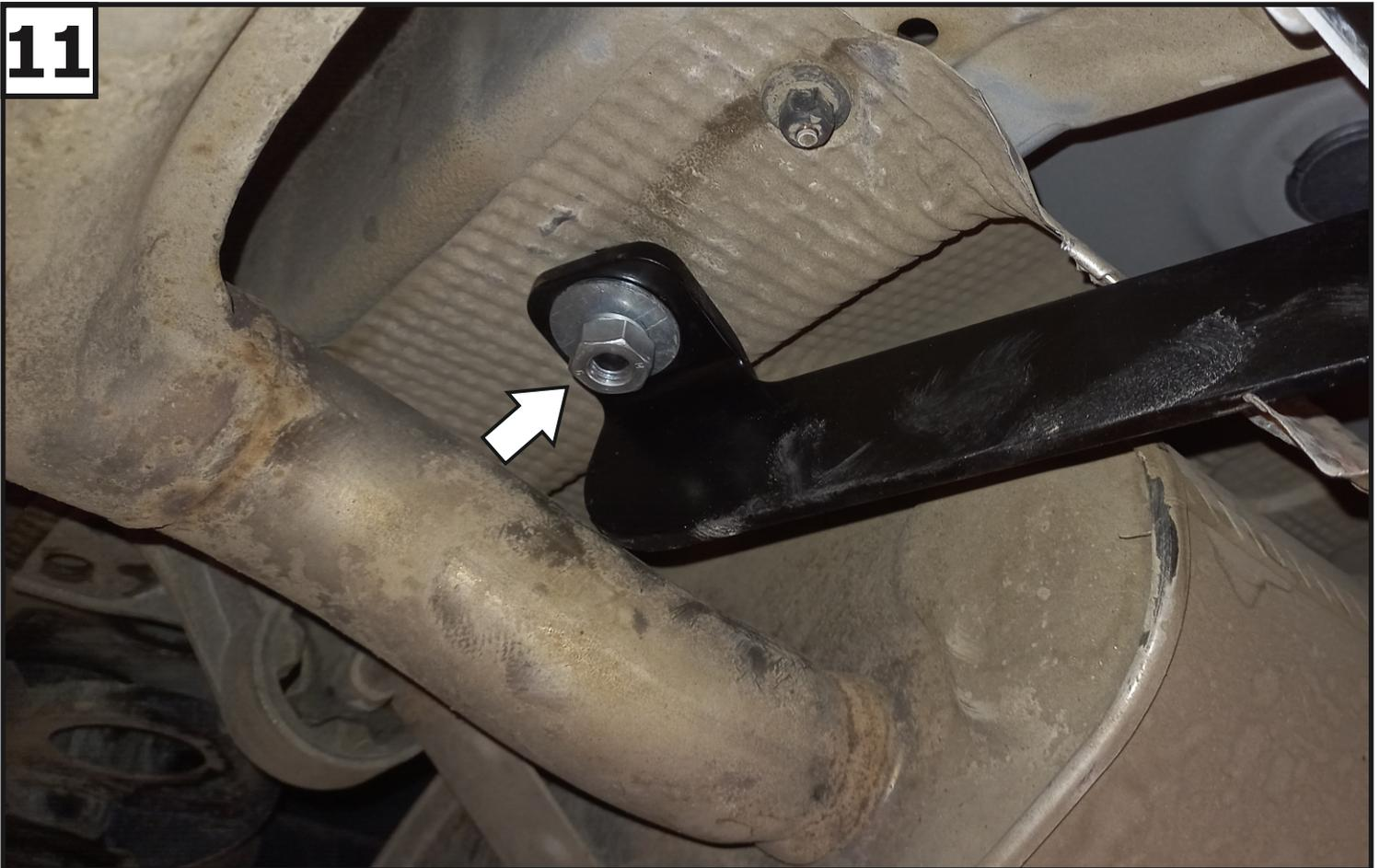
Установить усиление (2) с помощью увеличенной шайбы 12 (23), пружинной шайбы 12 (21) и гайки М12 (15) к закладной М12. После закрепить термоэкран в обратном порядке. С другой стороны аналогично.
