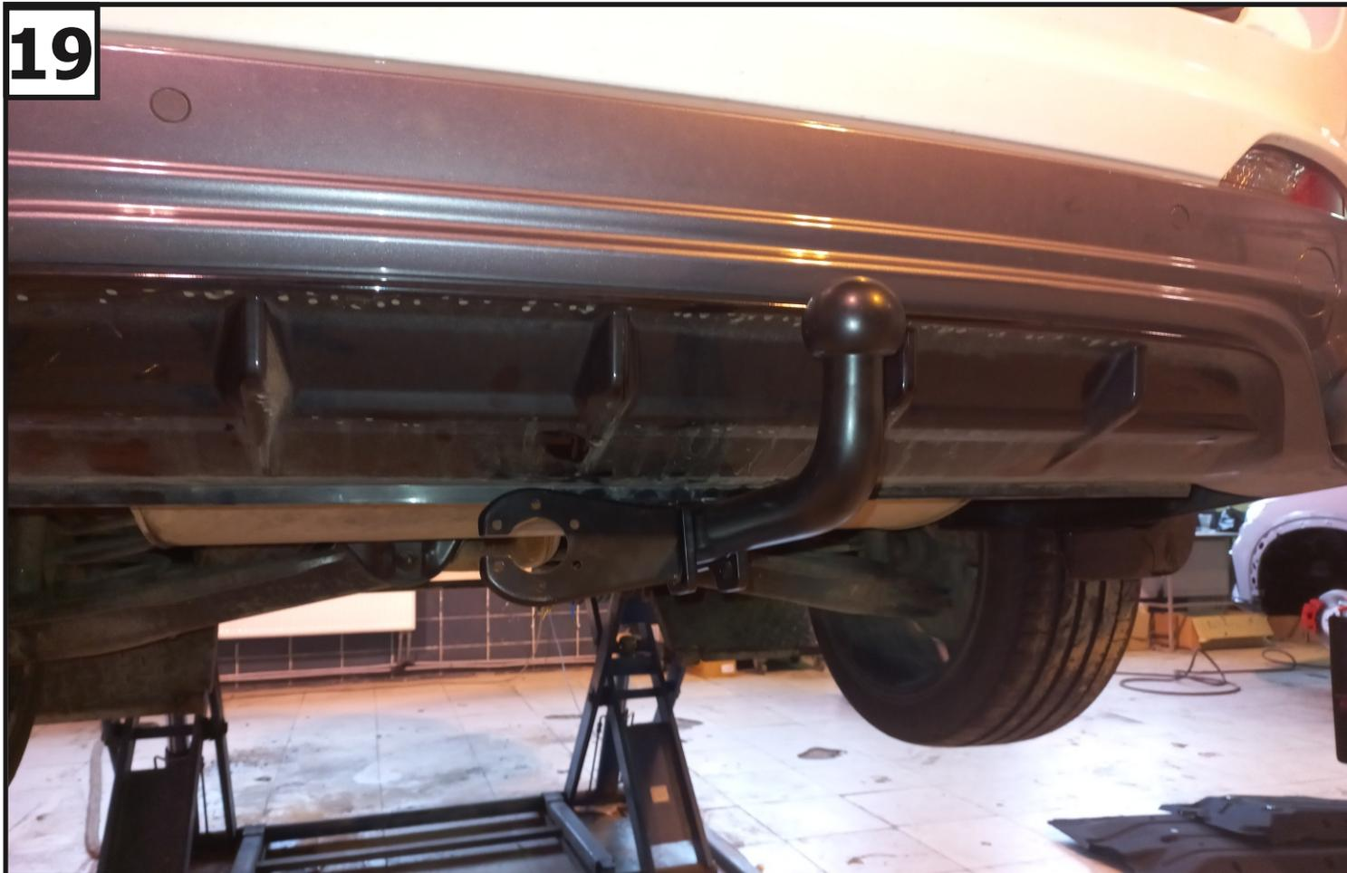
Установить кронштейн под розетку (5), и крюк (4) с помощью болтов M12x70 (12), шайб 12 (22), пружинных шайб 12 (21), и гаек M12 (15).
