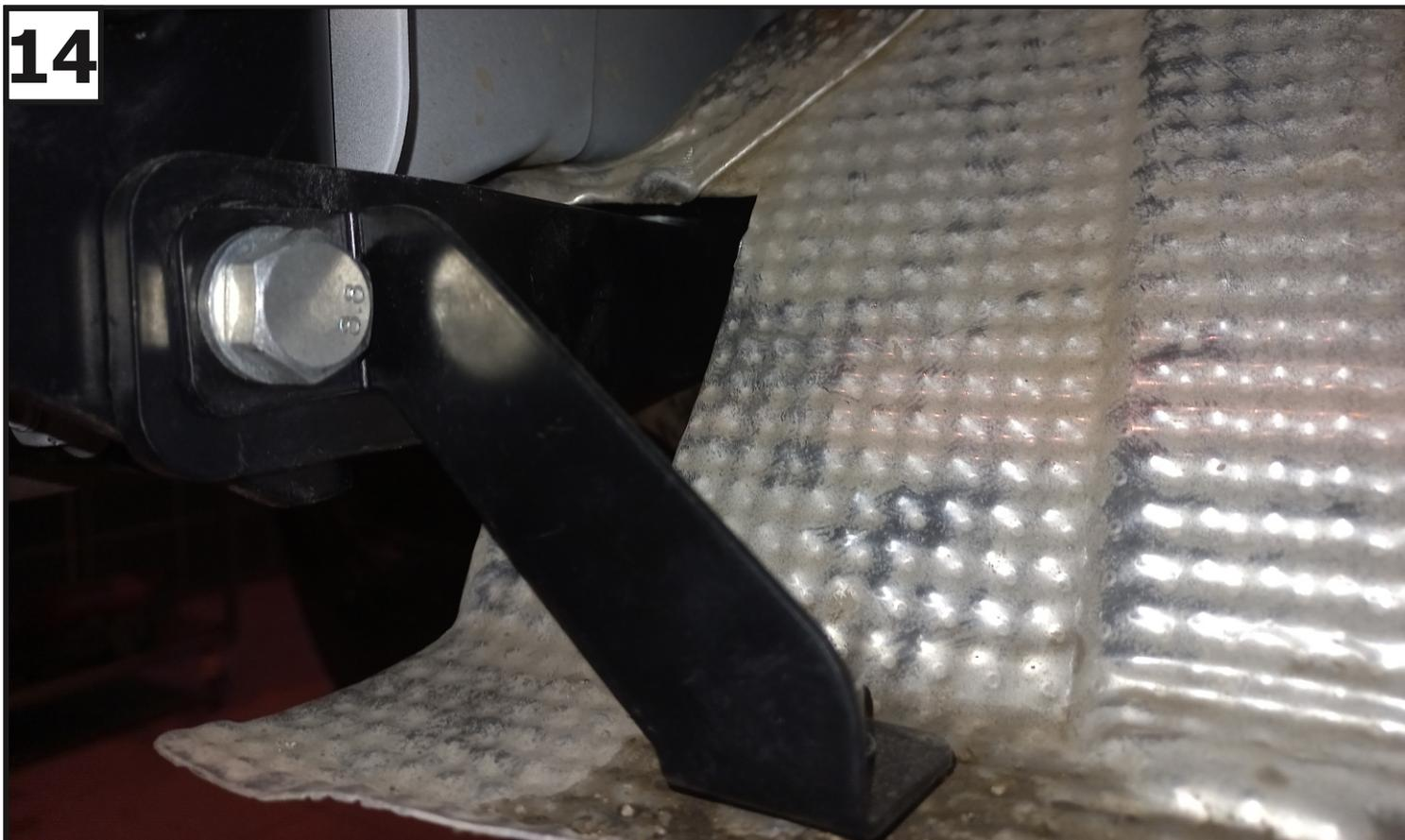
Закрепить усиление (2) и кронштейн бампера (8) к балке (1) с помощью болта М10х35 (11), гайки М10 (14), шайб 10 (20) и пружинной шайбы 10 (19). Аналогичную операцию провести с другой стороны
