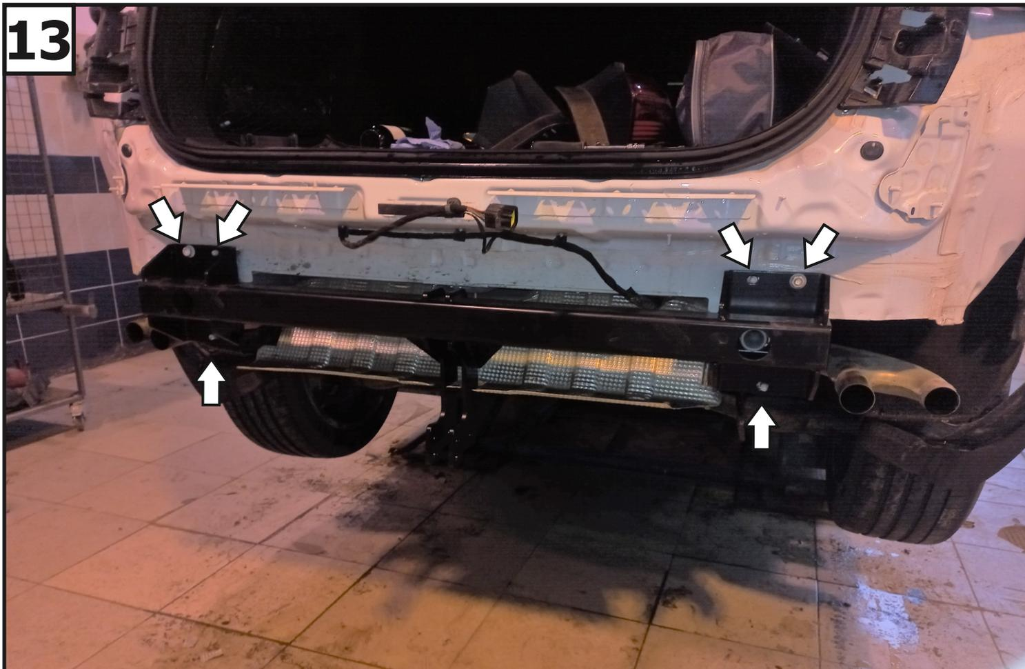
Установить балку (1) вместо усилителя бампера, закрепив штатными гайками.
