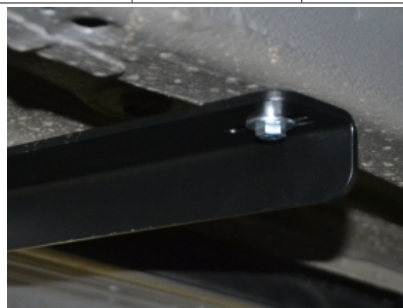
Рис. 2а - Установка передних кронштейнов
