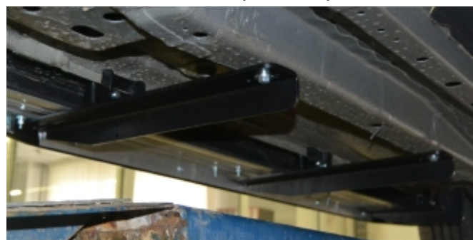
Рис. 2а - Установка передних кронштейнов
