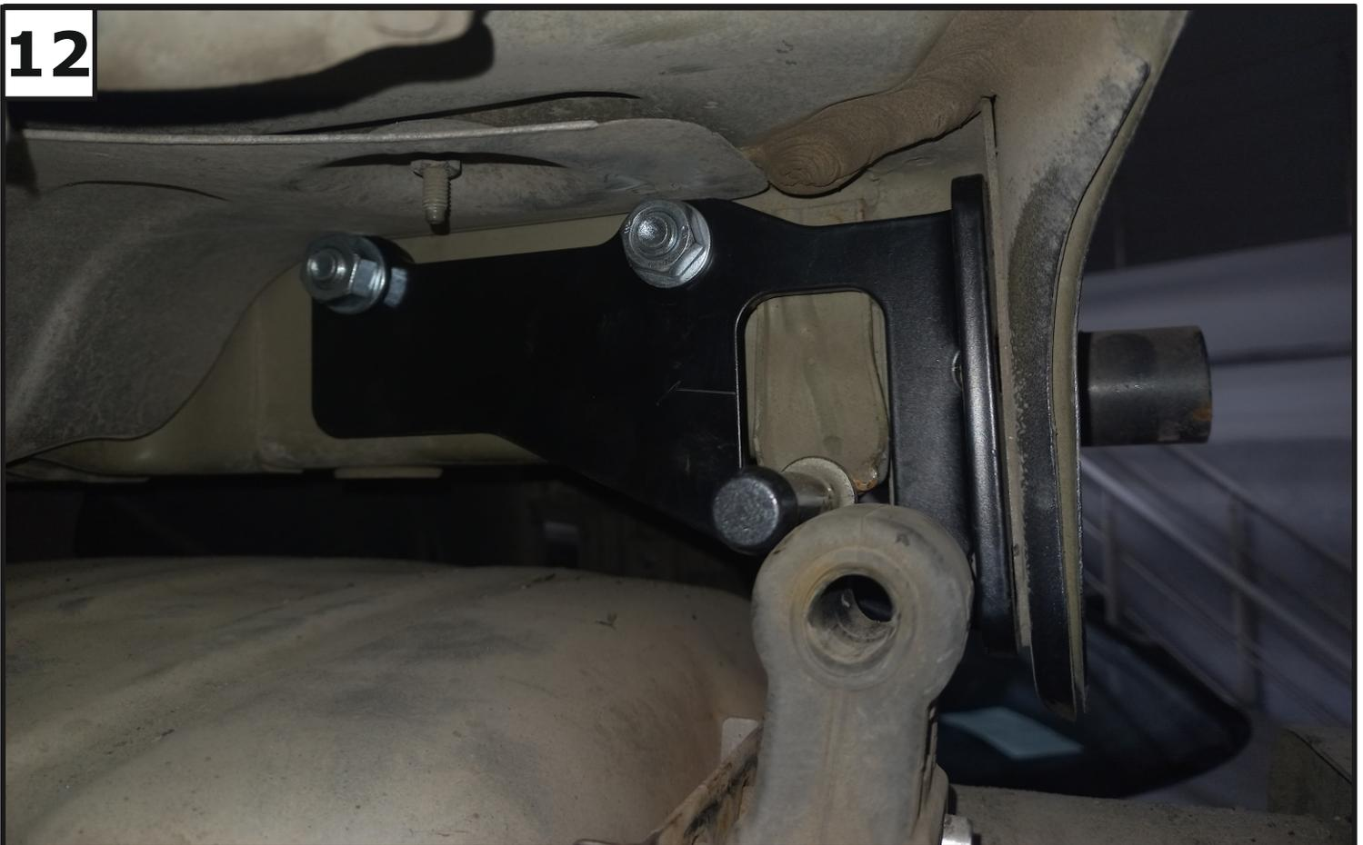
Установить кронштейн лонжерона правый (2), закрепив с помощью гаек М12 (22), шайб 12 пружинных (27) и шайб 12 (28). После установить на место подвес глушителя.
