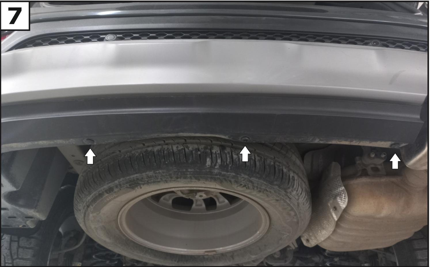
**Снять центральные клипсы крепления бампера.**
