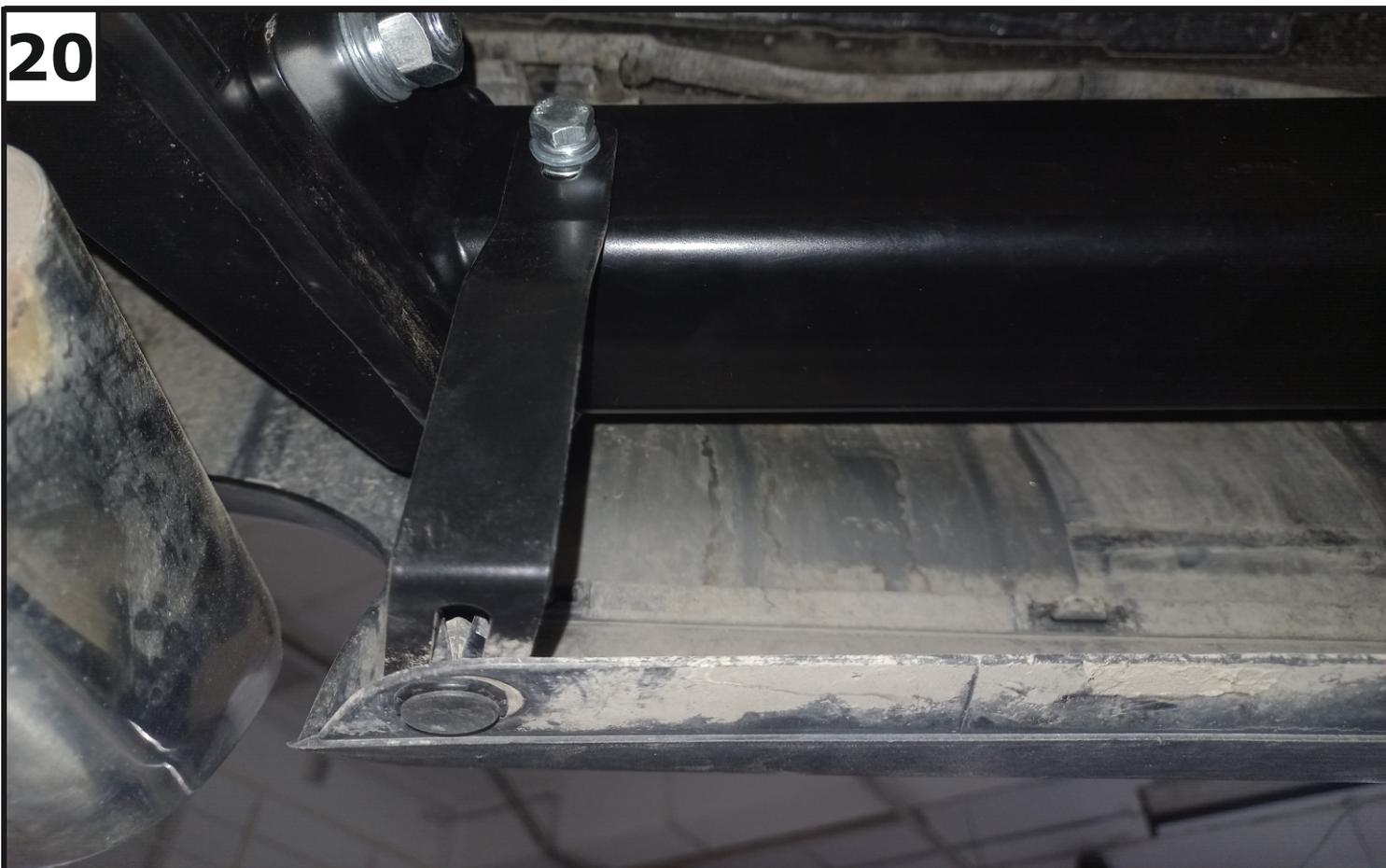
Установить крепления бампера (7 и 8) на балку (1) с помощью болтов М8х20 (14), шайб 8 пружинных (25), шайб 8 (26). Бампер закрепить с помощью заводских клипс или болтов М8х20 (14), шайб 8 пружинных (25), шайб 8 (26) и гаек М8 (20).
