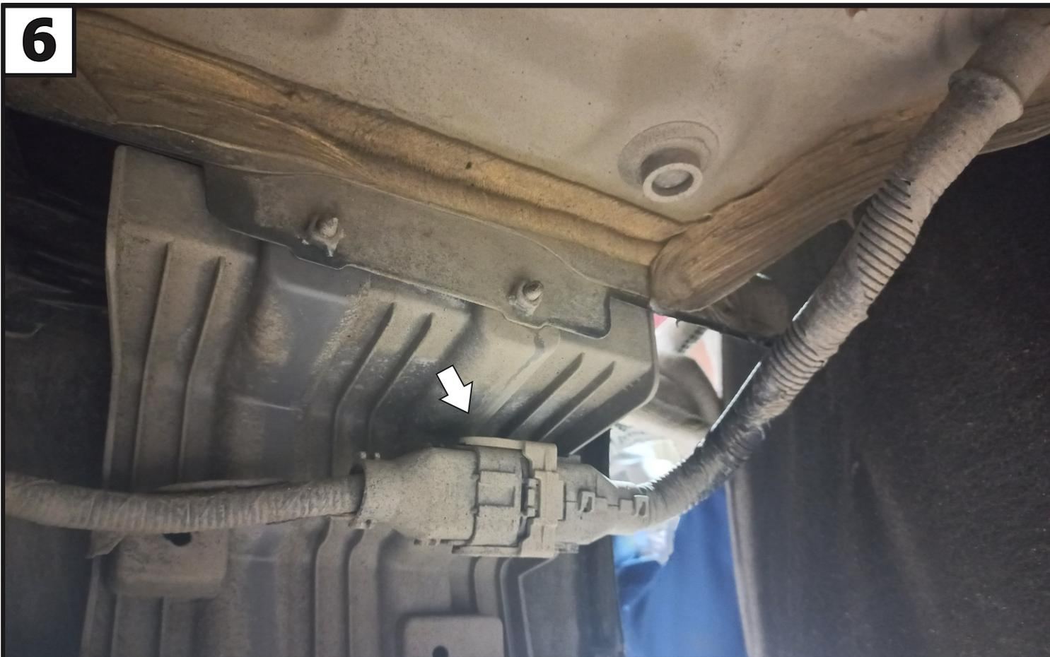
**После демонтажа пыльника разъединить фишку проводки бампера и снять ответную часть фишки с крепления.**
