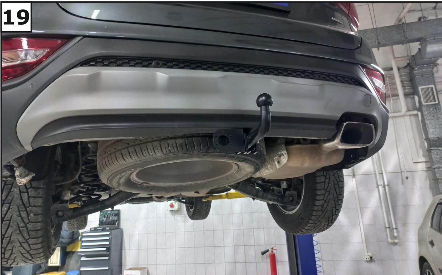
Установить подрозетник (10) и крюк (11) с помощью болтов М12х1.25х70 (17), шайб 12 пружинных (27), шайб 12 (28) и гаек М12х1.25 (21).
