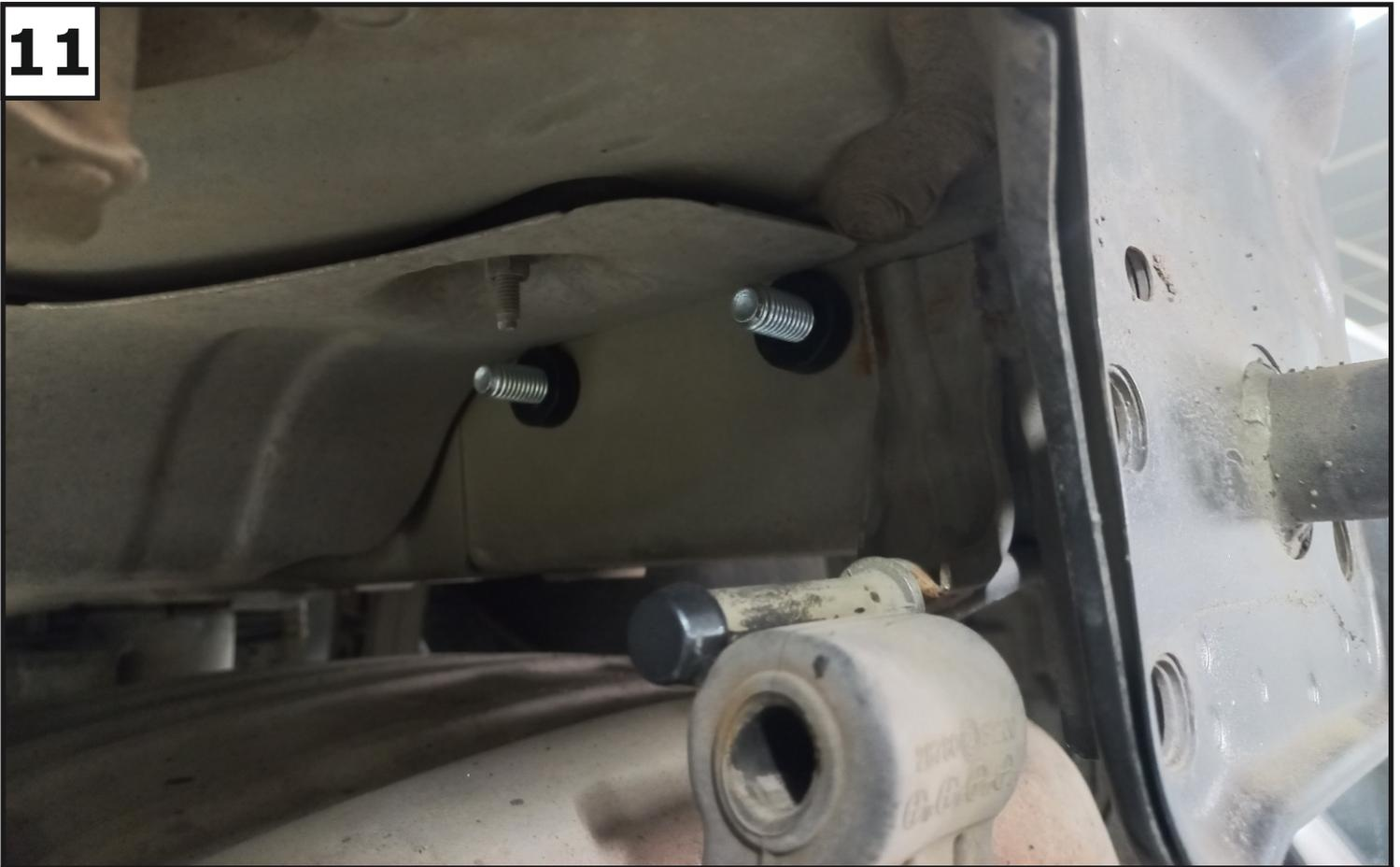
На правый лонжерон установить болты М12х110 (18) с увеличенной шайбой 12 (29) и проставки правого кронштейна лонжерона (6).
