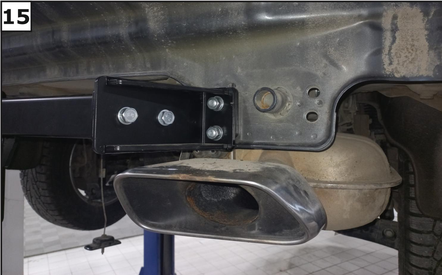
Установить кронштейны (4) и закрепить с помощью гаек М12х1,25 (21), шайб 12 пружинных (27) и шайб 12 (28).
