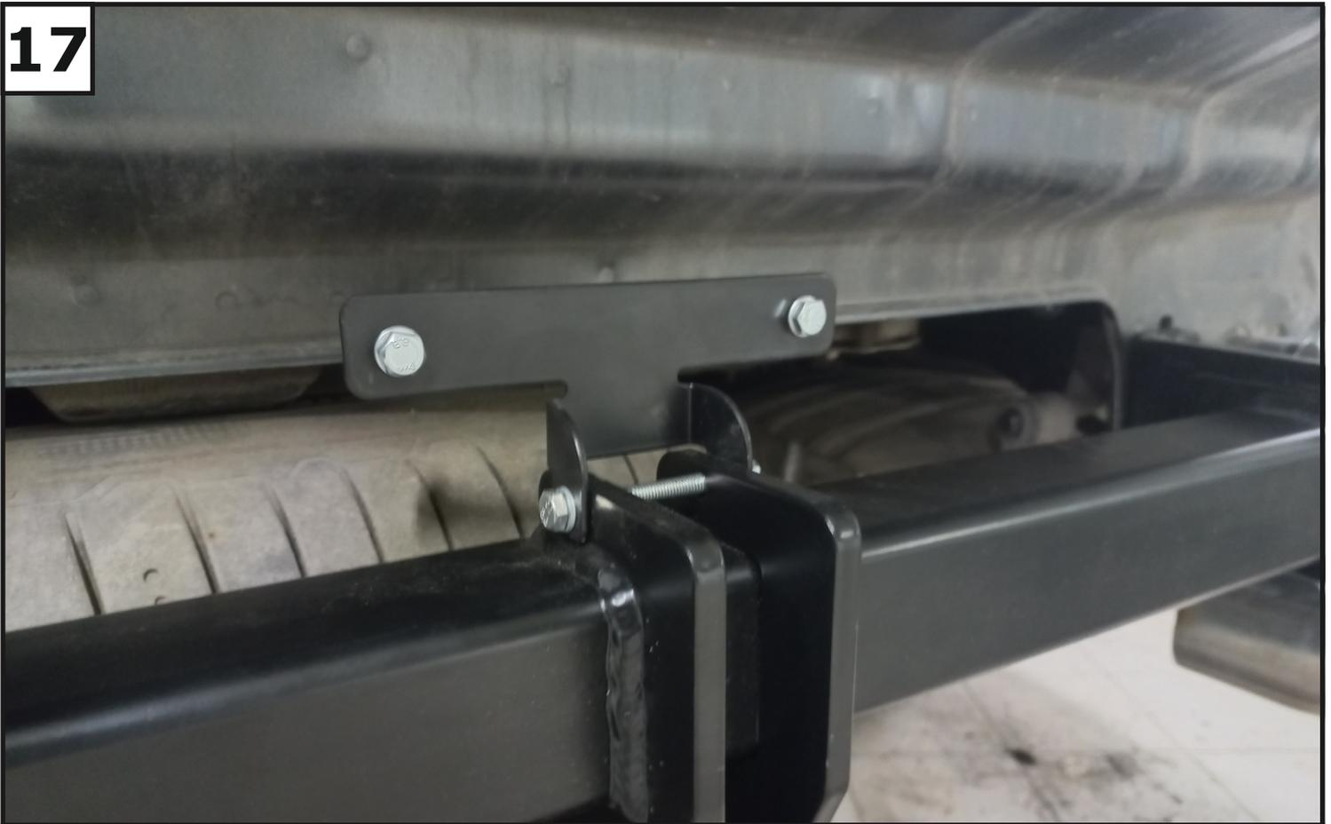
При наличии антенны бесключевого доступа установить кронштейн антенны (9) с помощью болта 6x60 (13), шайбы 6 пружинной (23), шайбы 6 (24) и гайки М6 (19). Антенну закрепить с помощью болтов М6х16 (2), шайб 6 пружинных (23), шайб 6 (24) и гаек М6 (19).
