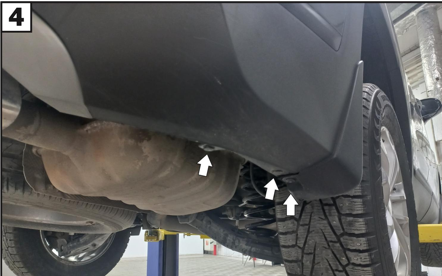
**Снять клипсы крепления бампера и брызговика. После демонтировать брызговик.**
