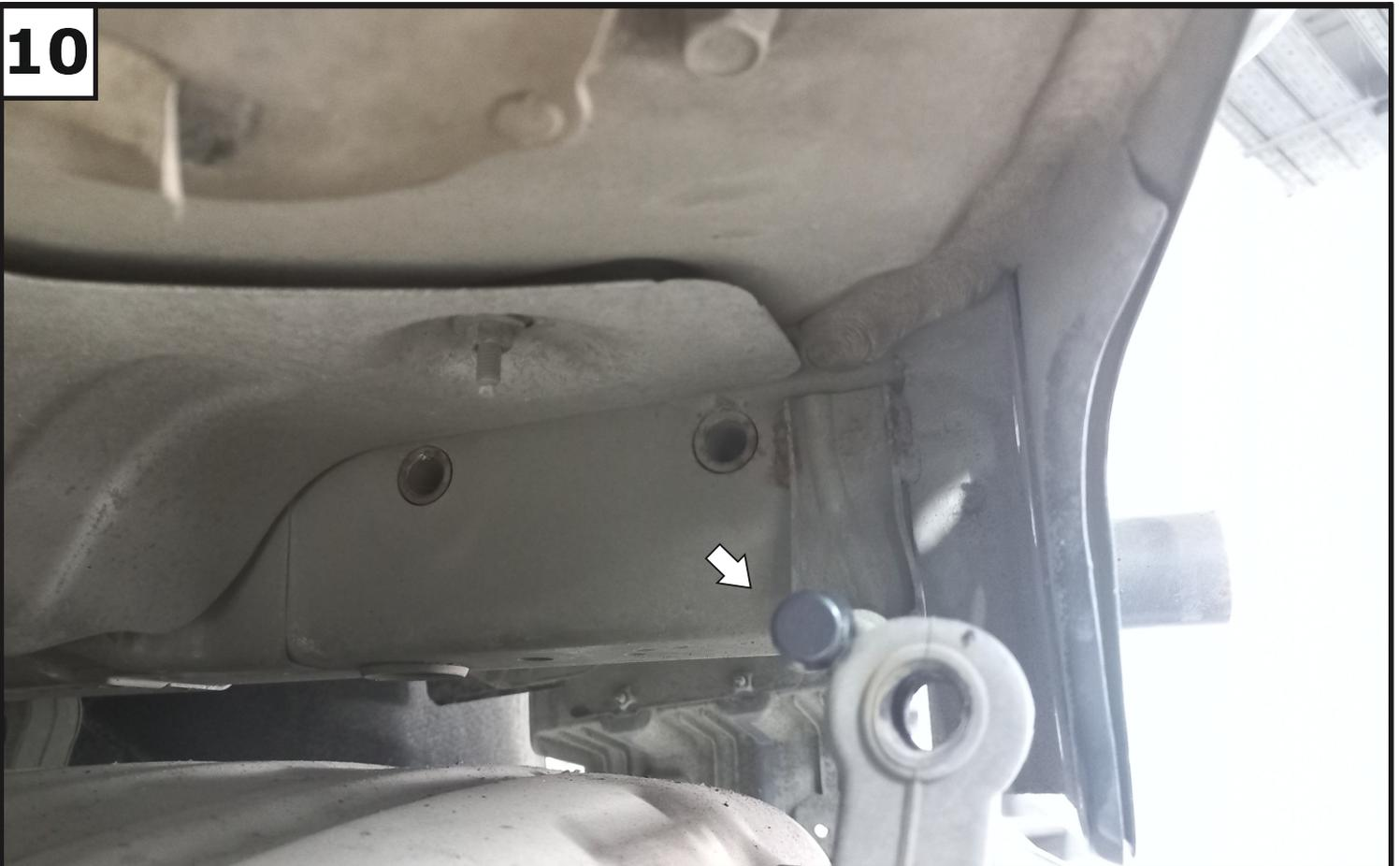
**Снять подвес глушителя с крепления.**
