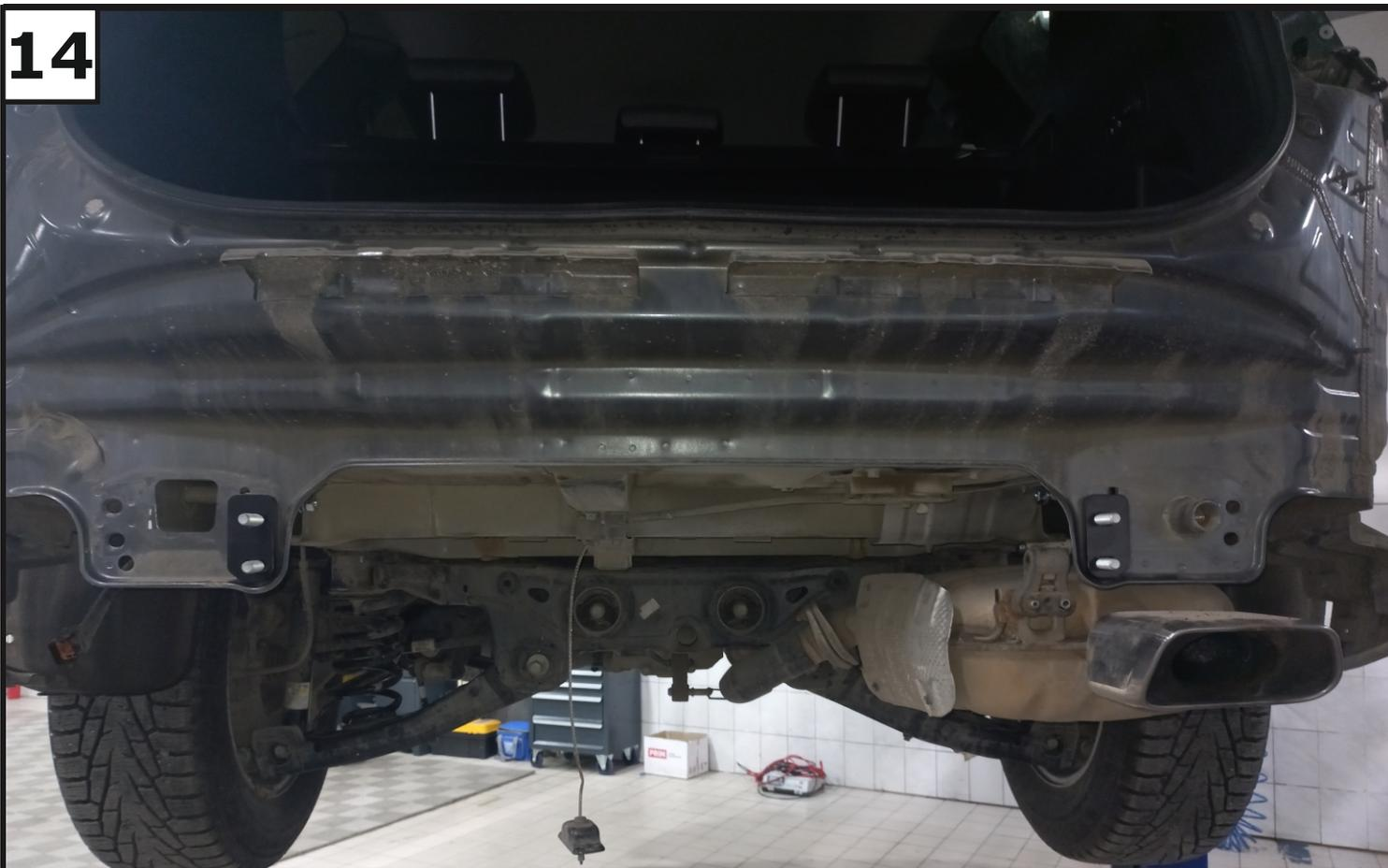
В кронштейны через заднюю панель установить болты 12х1,25х50 (16) с шайбами 12 (28) и на болты установить проставки под балку (5).
