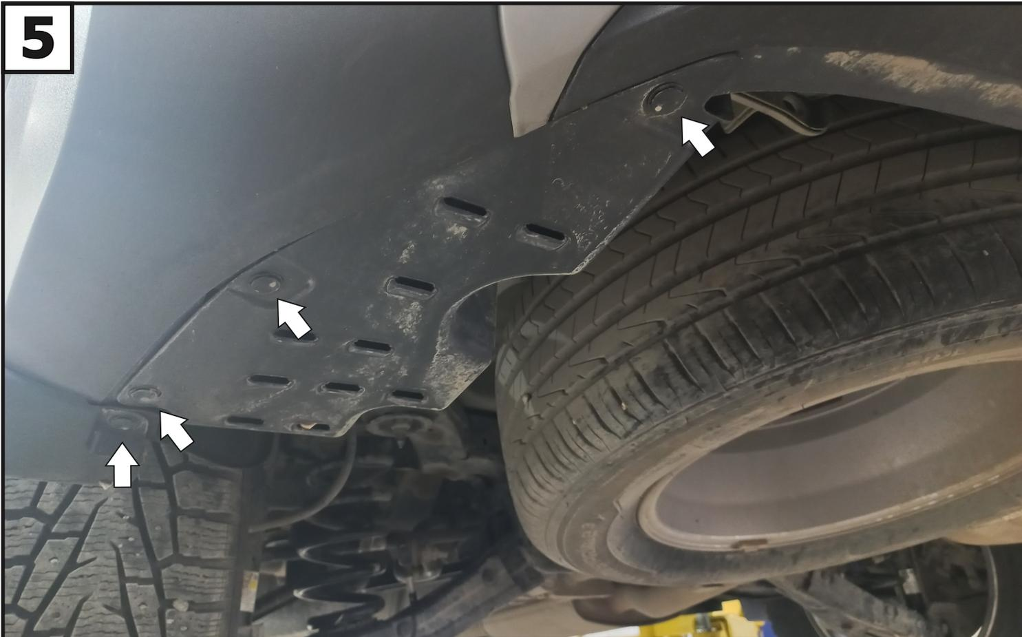
**Снять клипсы крепления бампера, пыльника и брызговика. После демонтировать брызговик и пыльник.**
