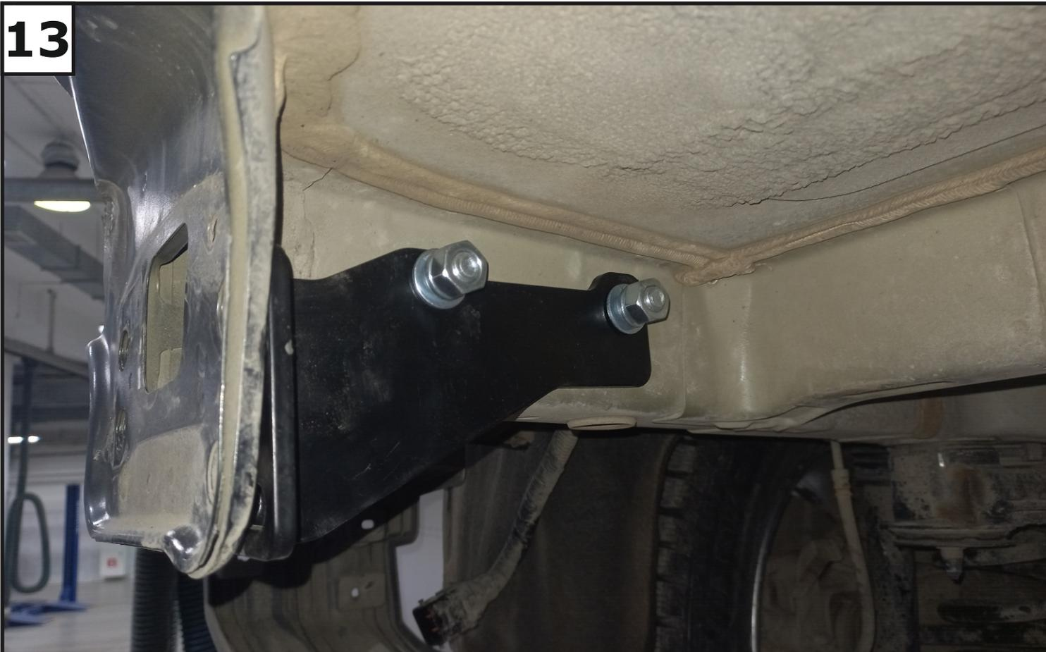
Установить кронштейн лонжерона левый (3), закрепив с помощью болтов М12х110 (18), шайб 12 увел. (29), шайб 12 (28), шайб 12 пружинных (27) и гаек М12 (22).
