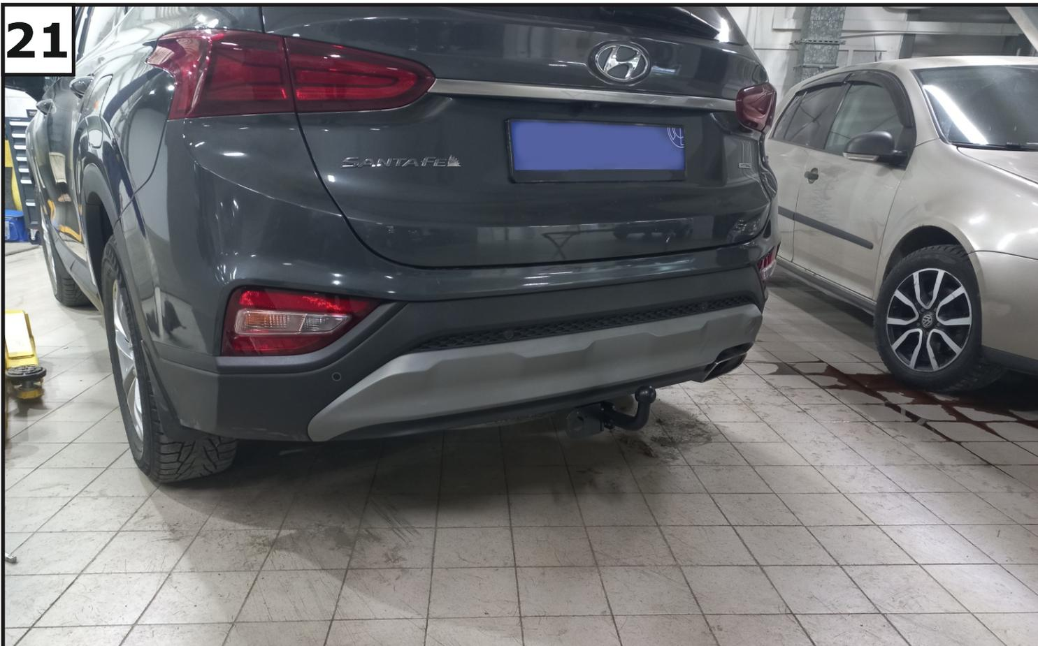
**Затянуть все резьбовые соединения. Моменты затяжки: M8=25 Нм, M12=81 Нм.**
