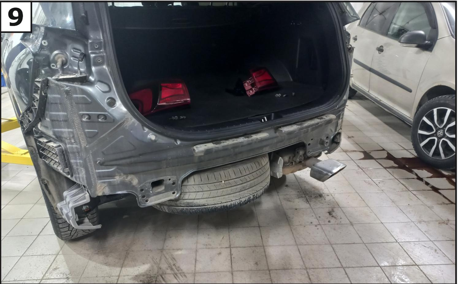
**Снять задний бампер в сборе с усилителем с автомобиля. Усилитель демонтировать, для дальнейшей установки усилитель не требуется. Для удобства установки ТСУ рекомендуется снять запасное колесо.**
