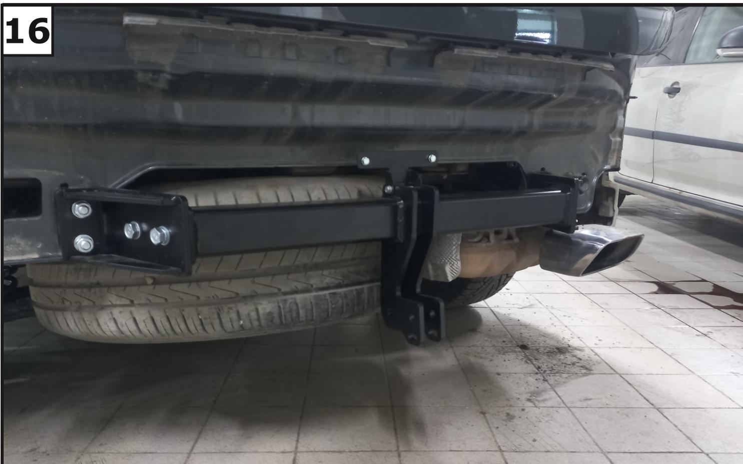
К кронштейнам закрепить балку (1) с помощью болтов 12х1,25х35 (15), шайб 12 пружинных (27), шайб 12 (28) и гаек М120х1,25 (21).
