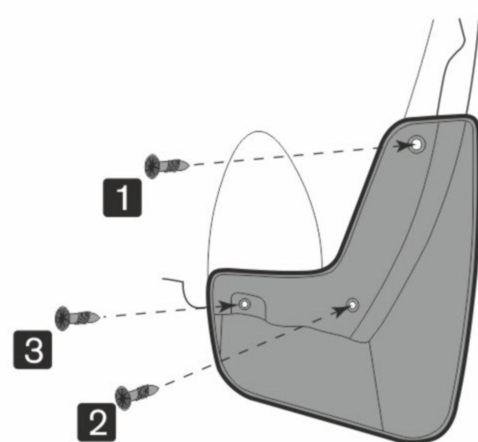
Используя отвертку со шлицем TORX, зафиксируйте брызговик, установив, ранее демонтированные, штатные саморезы.
