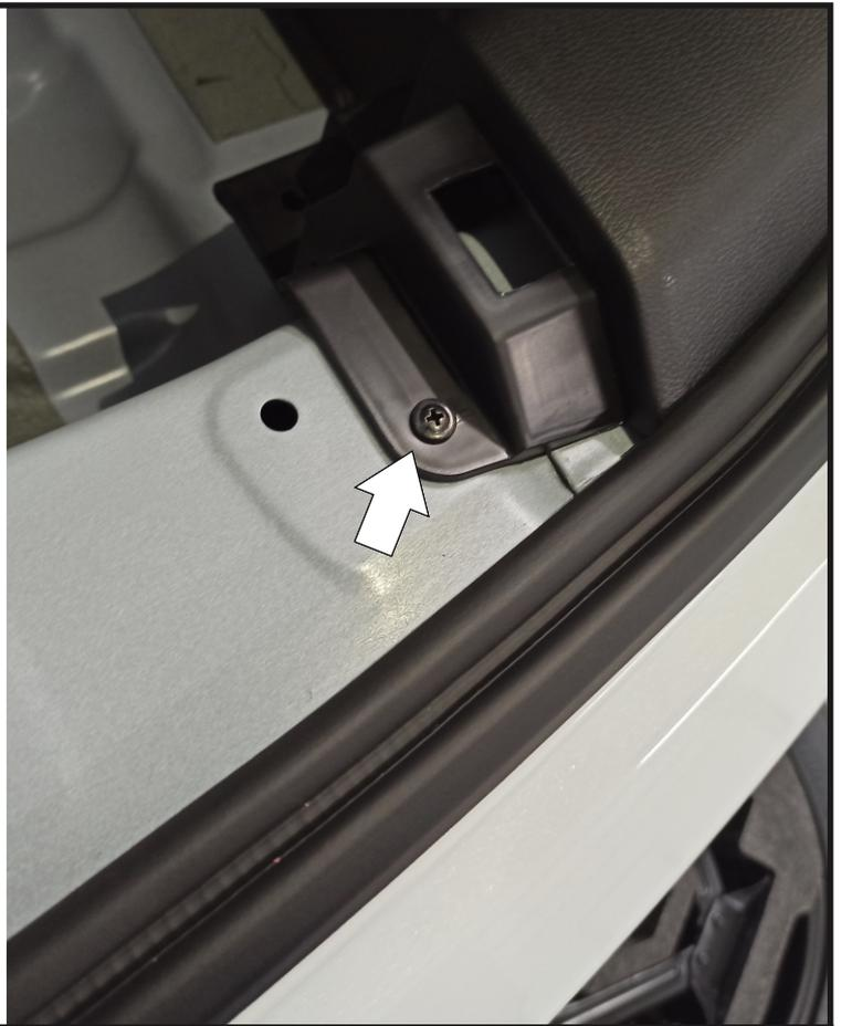
**Выкрутить винты крепления багажника и отогнуть обшивку с двух сторон.**
