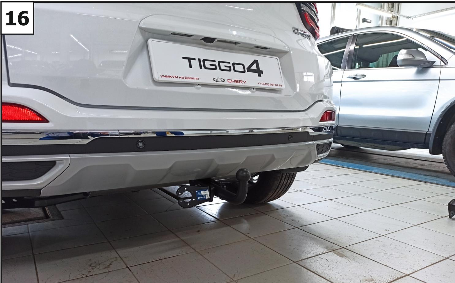
**Установить кронштейн под розетку (4) и крюк (5) с помощью болтов M12x1,25x90 (8), шайб 12 (12), шайб 12 пружинных (14) и гаек M12x1,25 (10).**
