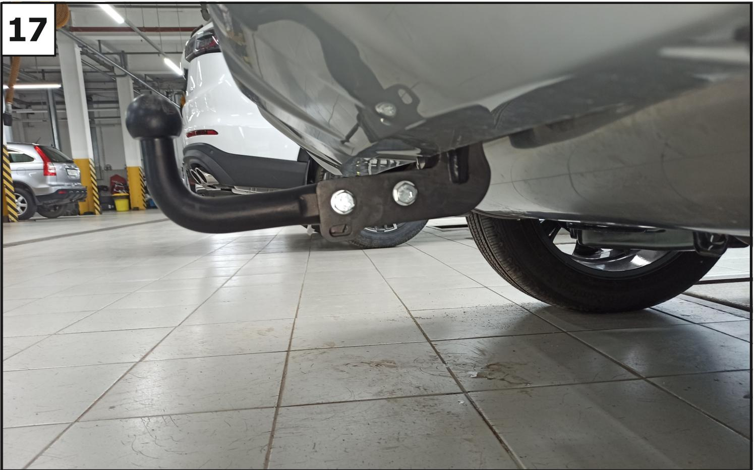
**Затянуть все резьбовые соединения. Моменты затяжки: M12=81Нм**
