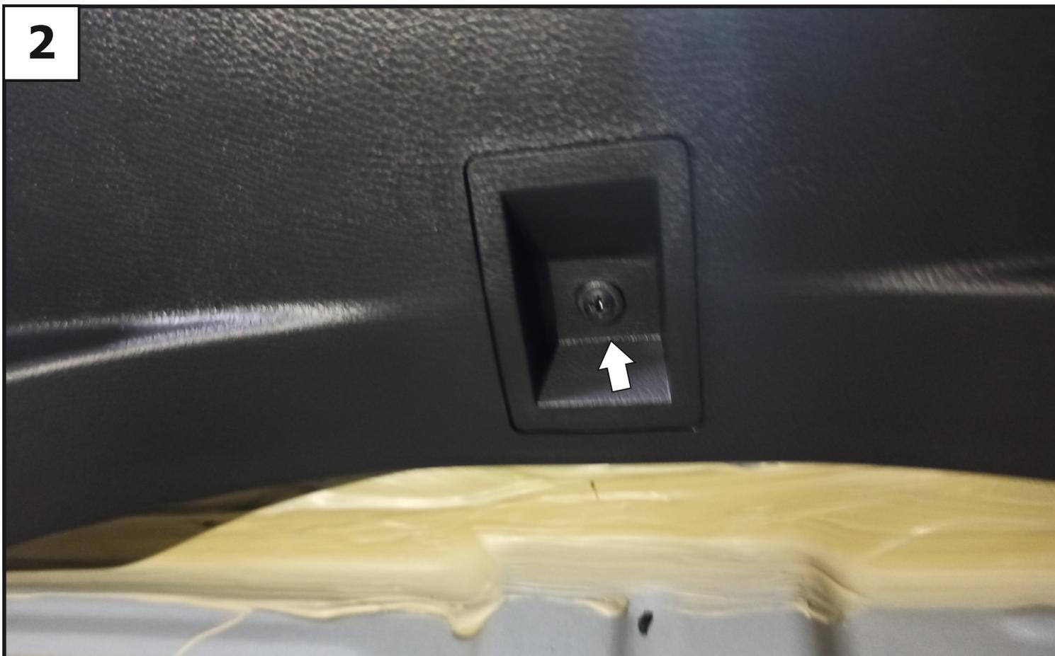
**В центре накладки выкрутить винт обшивки багажника.**
