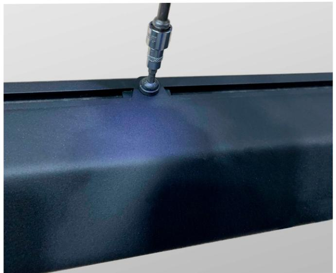
2. Закрепить дефлектор (поз.1) на профиле (поз.11), используя винты 8x16 (поз.Г), шайбы 8 (поз.Л) и шайбы 8 гровер (поз.М) как показано на рис.3.
