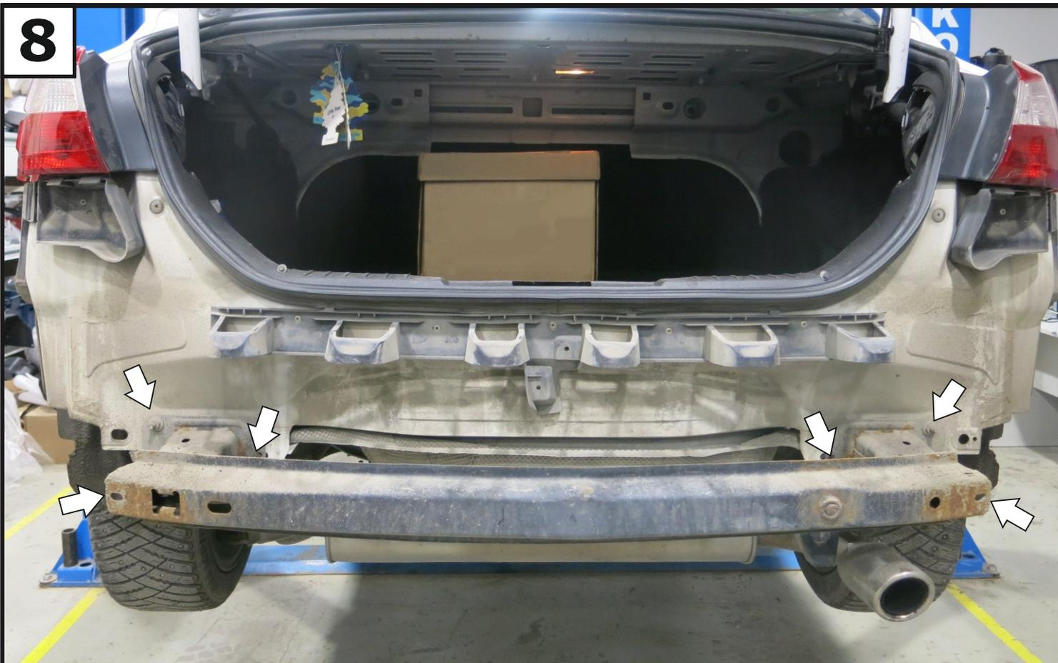
Открутить заводские гайки крепления усилителя бампера.
