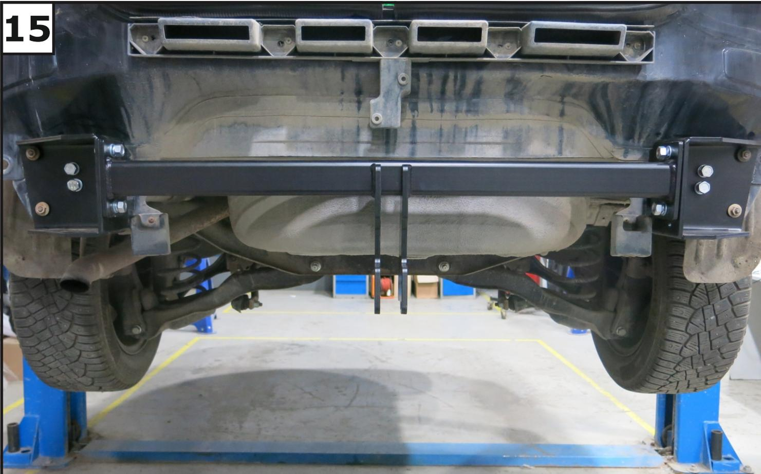
К установленным кронштейнам закрепить балку (1) с помощью болтов М10х1,25х30 (8), шайб 10 пружинных (12), шайб 10 (13) и гаек М10х1.25 (10). Положение балки по моделям: FORD FOCUS 2 верхнее положение, FORD FOCUS 3 нижнее положение.
