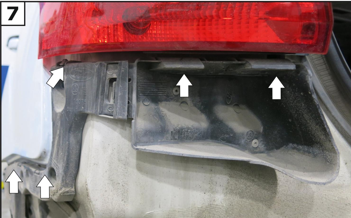
Для FORD FOCUS 3 отщелкнуть защелки крепления бампера с левой и правой стороны. После демонтировать бампер с автомобиля.
