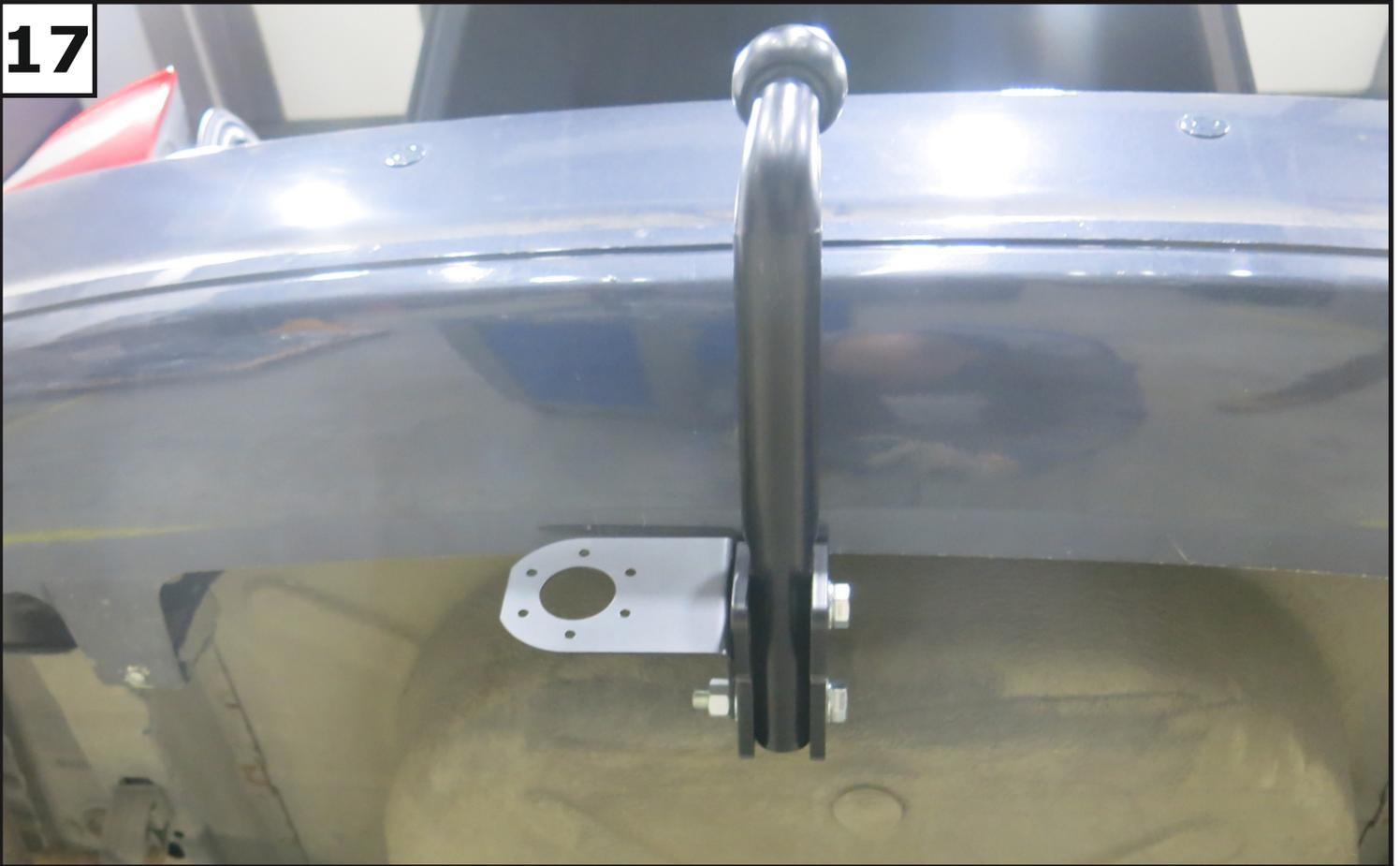
Установить подрозетник (6) и крюк (7) с помощью болтов M12x1.25x70 (9), шайб 12 пружинных (15), шайб 12 (16) и гаек M12x1.25 (11).
