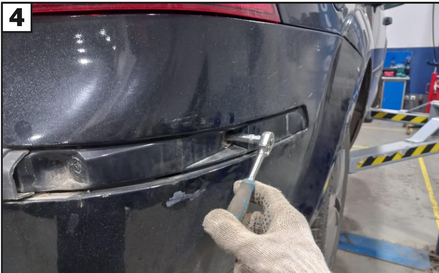
**Для FORD FOCUS 2 (2005-2008) снять молдинг бампера и выкрутить винт. Для другой стороны аналогично.**
