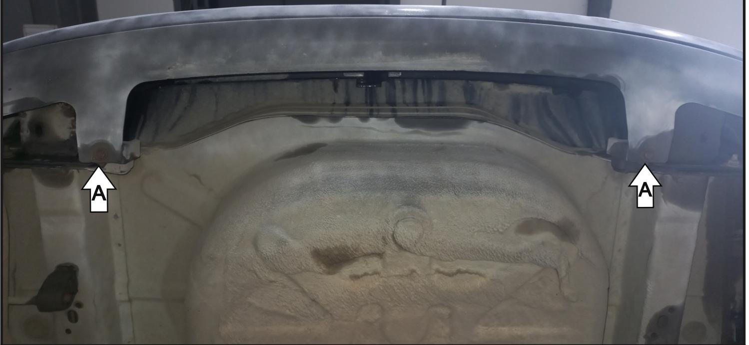
Снять нижние клипсы А заднего бампера.
