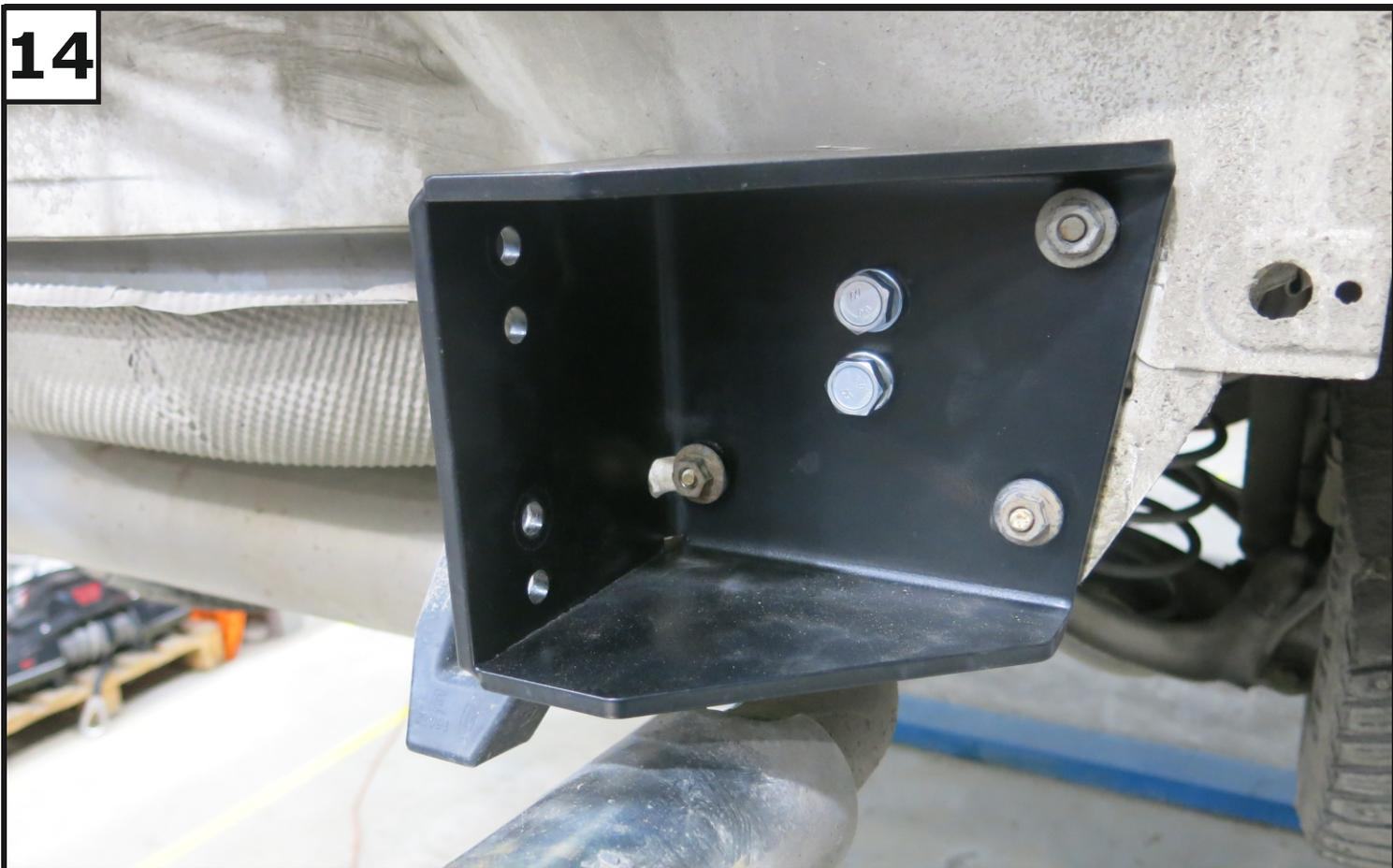
Установить кронштейн правый (5), закрепив к усилению кронштейна с помощью болтов M10x1.25x30 (8), шайб 10 пружинных (12) и шайб 10 (13). Затем прикрутить заводские гайки.
