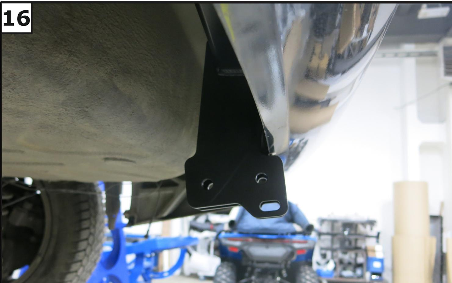
Затянуть все резьбовые соединения. Моменты затяжки: М8=25 Нм, М10=47 Нм.
