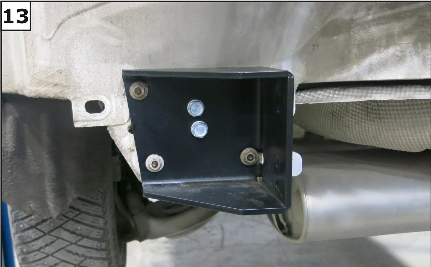
Установить кронштейн левый (4), закрепив к усилению кронштейна с помощью болтов M10x1.25x30 (8), шайб 10 пружинных (12) и шайб 10 (13). Затем прикрутить заводские гайки.
