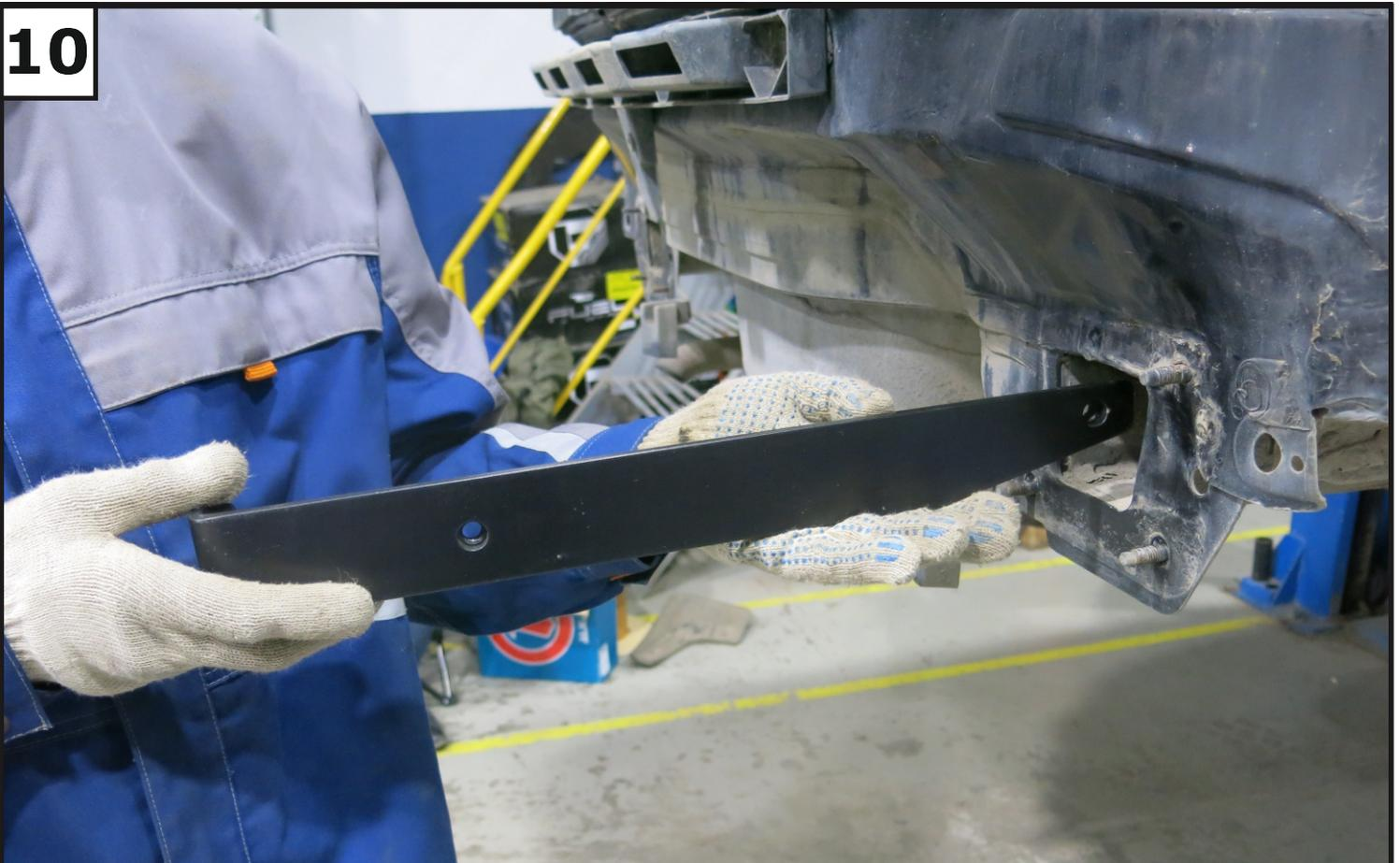
**Установить усиление кронштейна в лонжерон автомобиля. Для другой стороны аналогично.**
