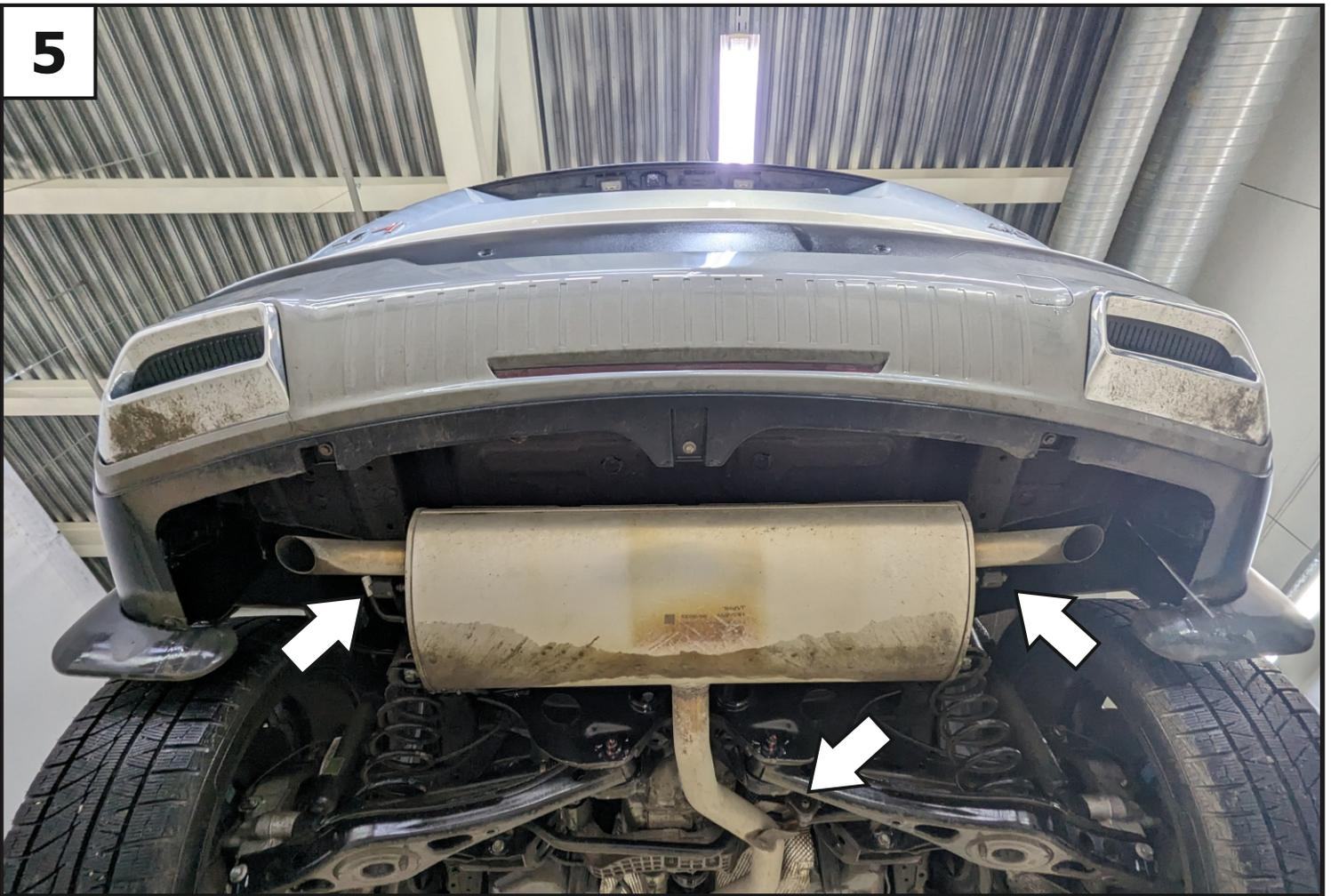
Для удобства установки ТСУ снять глушитель с подвесов.
