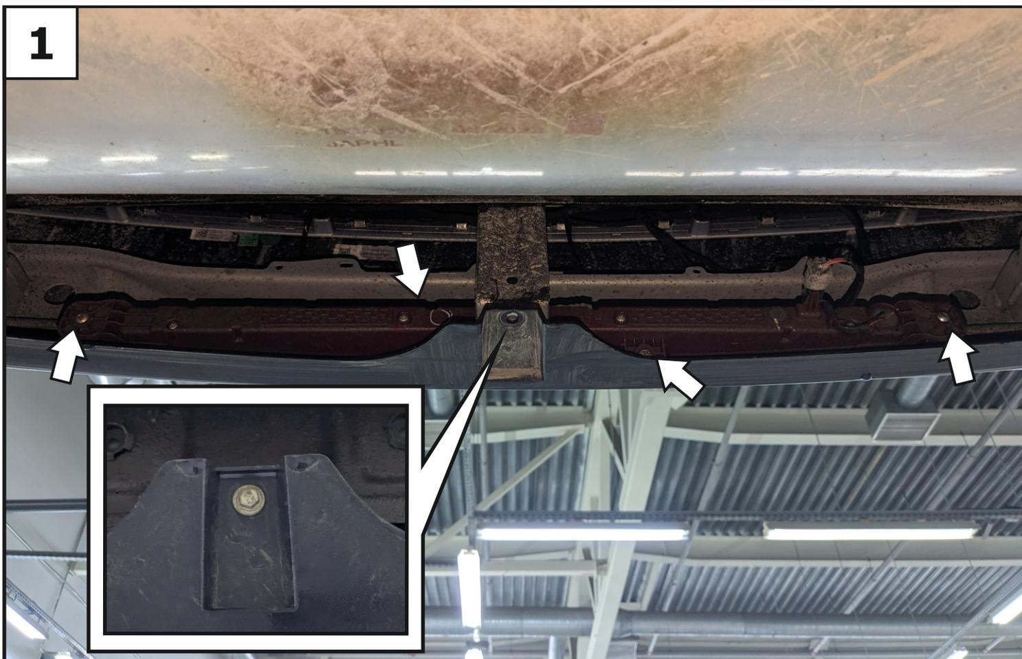
**Выкрутить нижний болт крепления бампера. Снять противотуманный фонарь, открыв штатные винты.**
