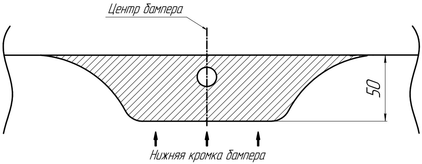
Выполнить подрезку бампера согласно схеме.
