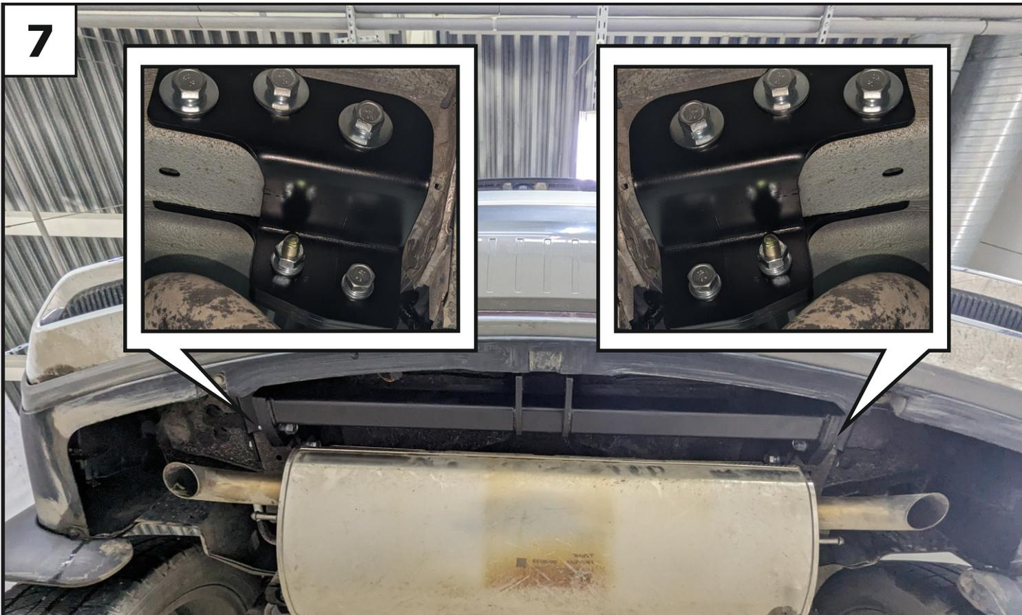
Прогнать резьбовые отверстия балки (1) с помощью метчика М12х1,25. Установить балку (1), закрепив ее к кронштейнам и усилениям кронштейнов с помощью болтов М12х1,25х40 (13), М12х1,25х50 (14), гаек М12х1,25 (21), шайб 12 пружинных (25) и шайб 12 (26).
