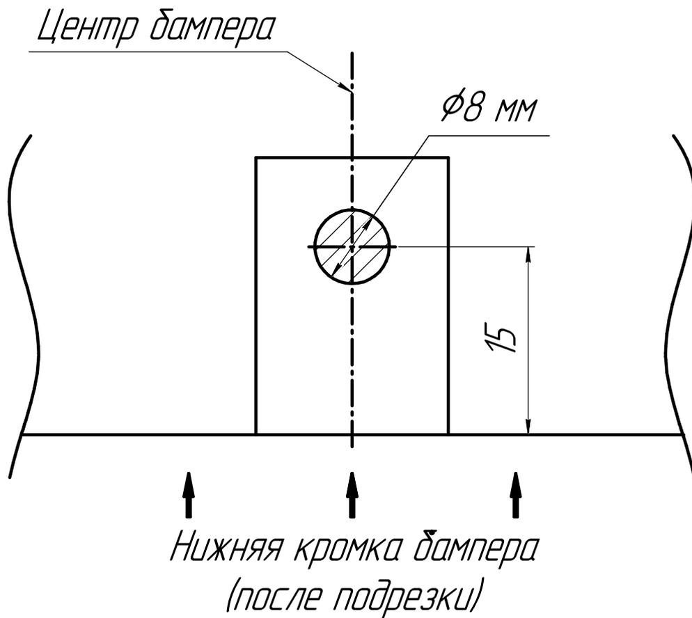
Просверлить отверстие в бампере согласно схеме.
