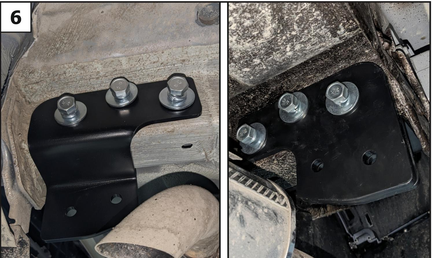
Установить кронштейн правый (3) и усиление кронштейна правое (5), закрепив их к лонжерону с помощью болтов М12х1,25х35 (12), шайб 12 пружинных (25) и шайб 12 увелич. (27). Кронштейн левый (2) и усиление кронштейна левое (4) установить аналогично.
