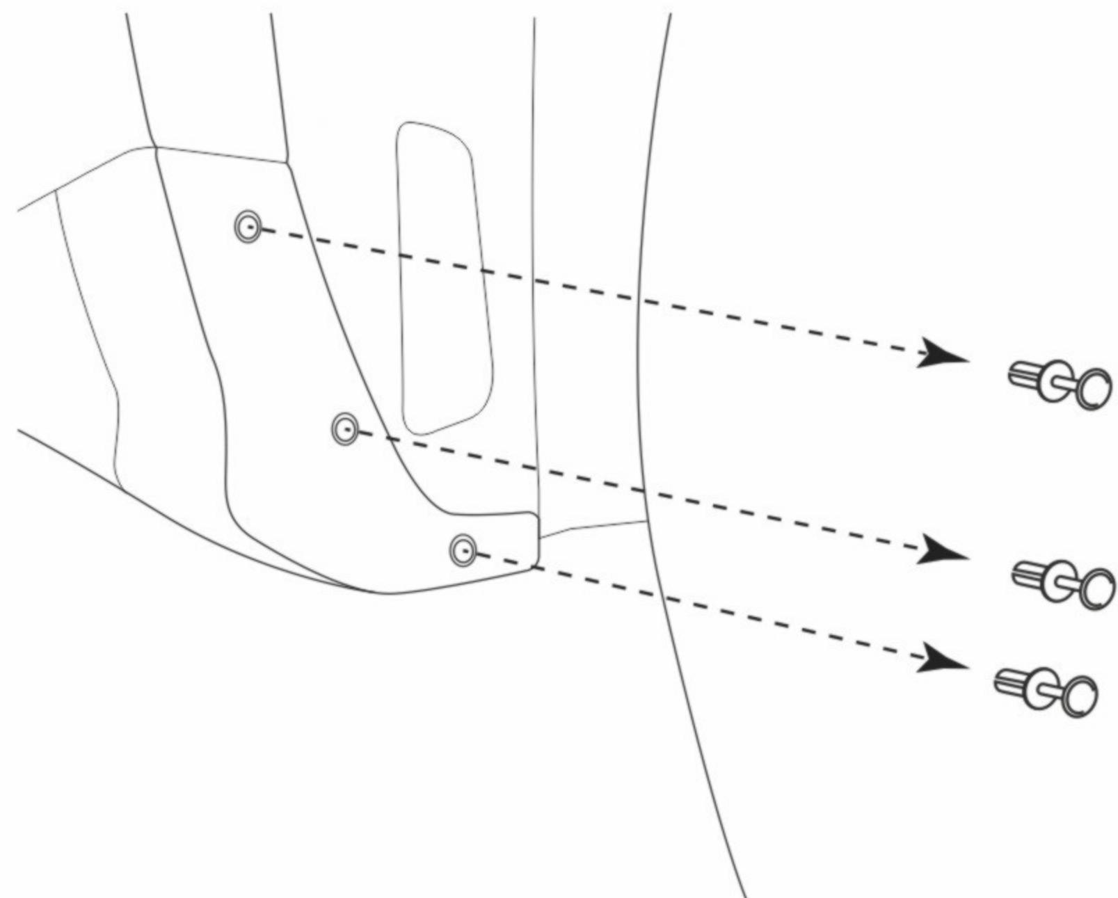
Произведите демонтаж 3-х штатных пластиковых фиксаторов.
