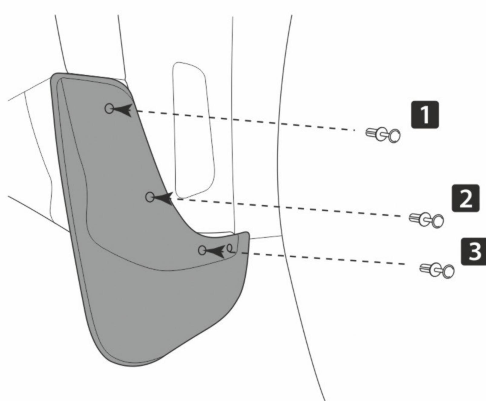
В точках 1, 2 и 3 установите пластиковые фиксаторы 8x28x15 из комплекта поставки.
