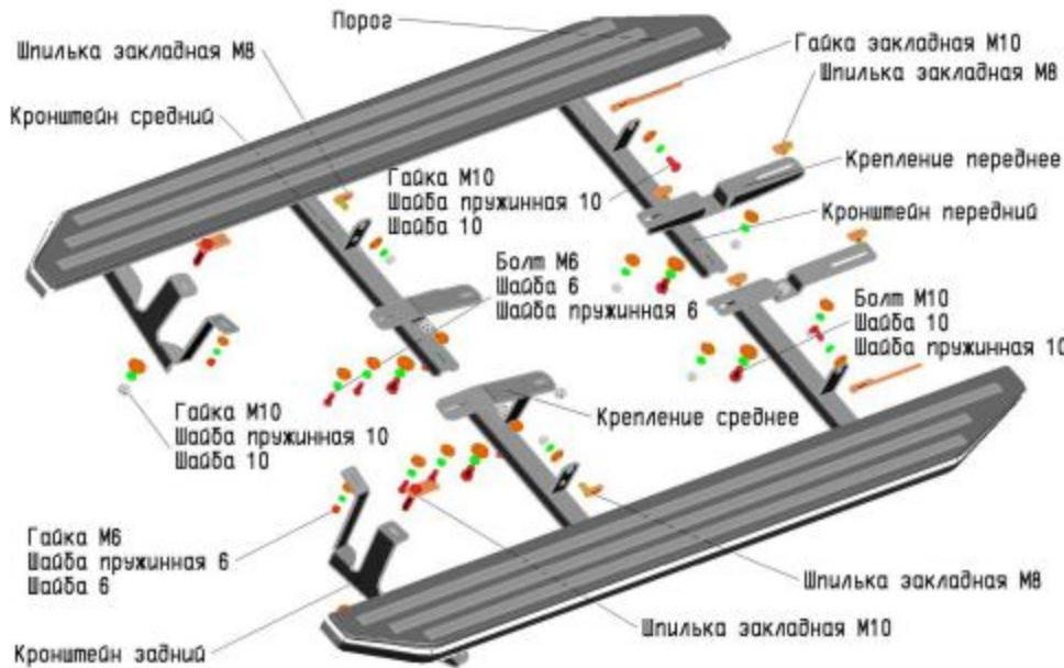
в него шпильку закладную M8(рис. 6). Закрепить заднюю часть среднего кронштейна болтом M10x20 к установленному креплению среднему (рис. 7). Переднюю часть закрепить на установленную шпильку закладную M8.
