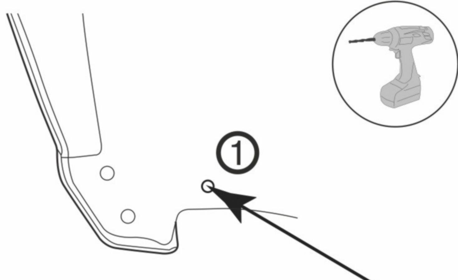
Используя сверло Ø 8 мм, просверлить
