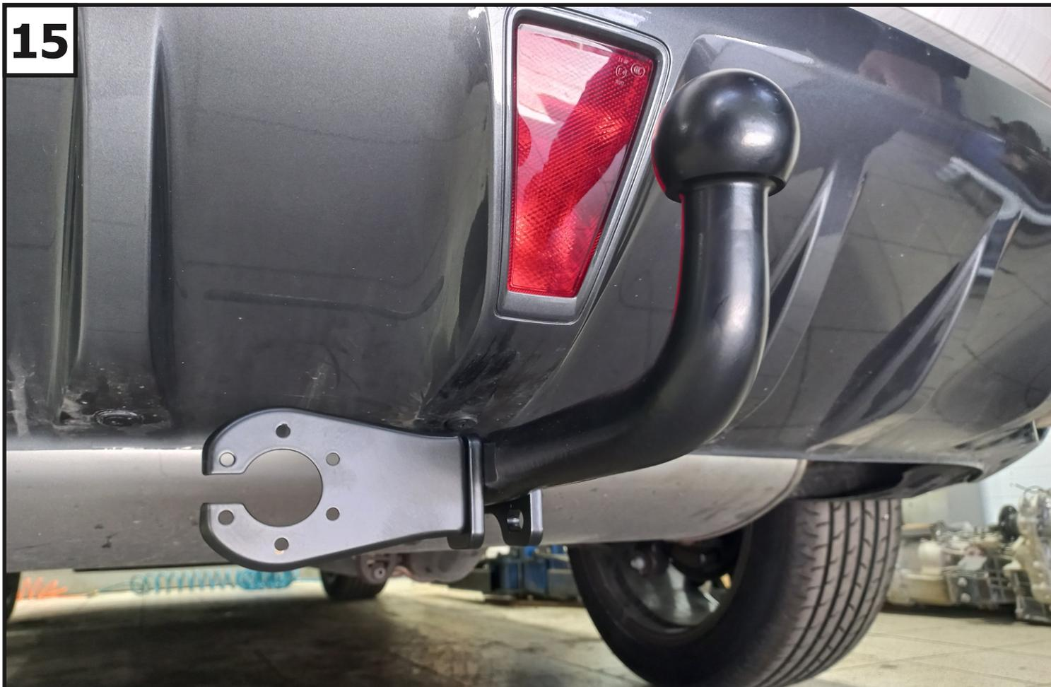
Установить кронштейн под розетку (9) и крюк (10) с помощью болтов М12х1,25х70 (13), шайб 12 (18), шайб 12 пружинных (17) и гаек М12х1,25 (14).
