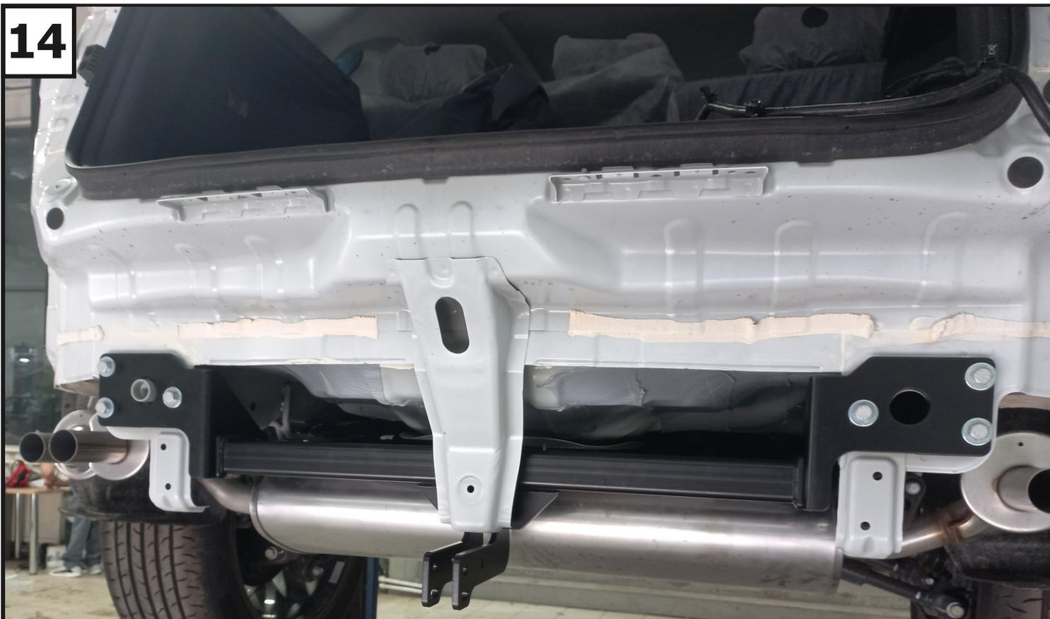
Затянуть все резьбовые соединения: сначала балку с кронштейнами, затем кронштейны к задней панели, потом кронштейны к лонжеронам. Моменты затяжки: M10=47 Нм; M12=81 Нм. Установить бампер в обратном порядке.
