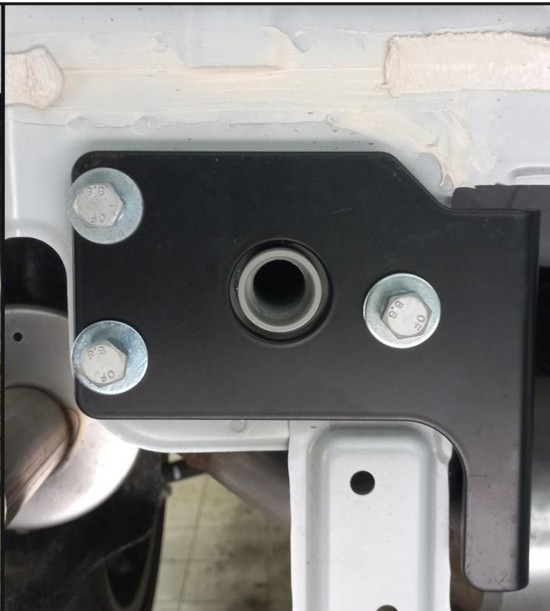
Установить кронштейн левый (4) и проставку (6) к задней панели с помощью болтов М10х1,25х35 (11), шайб 10 пружинных (15) и шайб 10 увел. (16). Кронштейн правый (5) установить аналогично.
