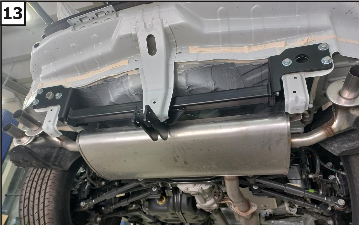
Прогнать резьбовые отверстия балки (1) при помощи метчика M12x1,25. Затем установить балку (1), закрепив к кронштейнам с помощью болтов M12x1,25x40 (12), гаек M12x1,25 (14), шайб 12 пружинных (17) и шайб 12 (18).
