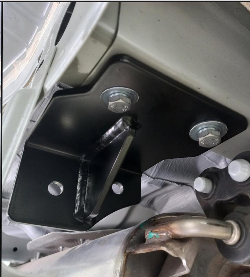
Установить кронштейны (2 и 3), закрепив их к установленным закладным с помощью болтов М10х1,25х35 (11), шайб 10 пружинных (15) и шайб 10 увеличенных (16).
