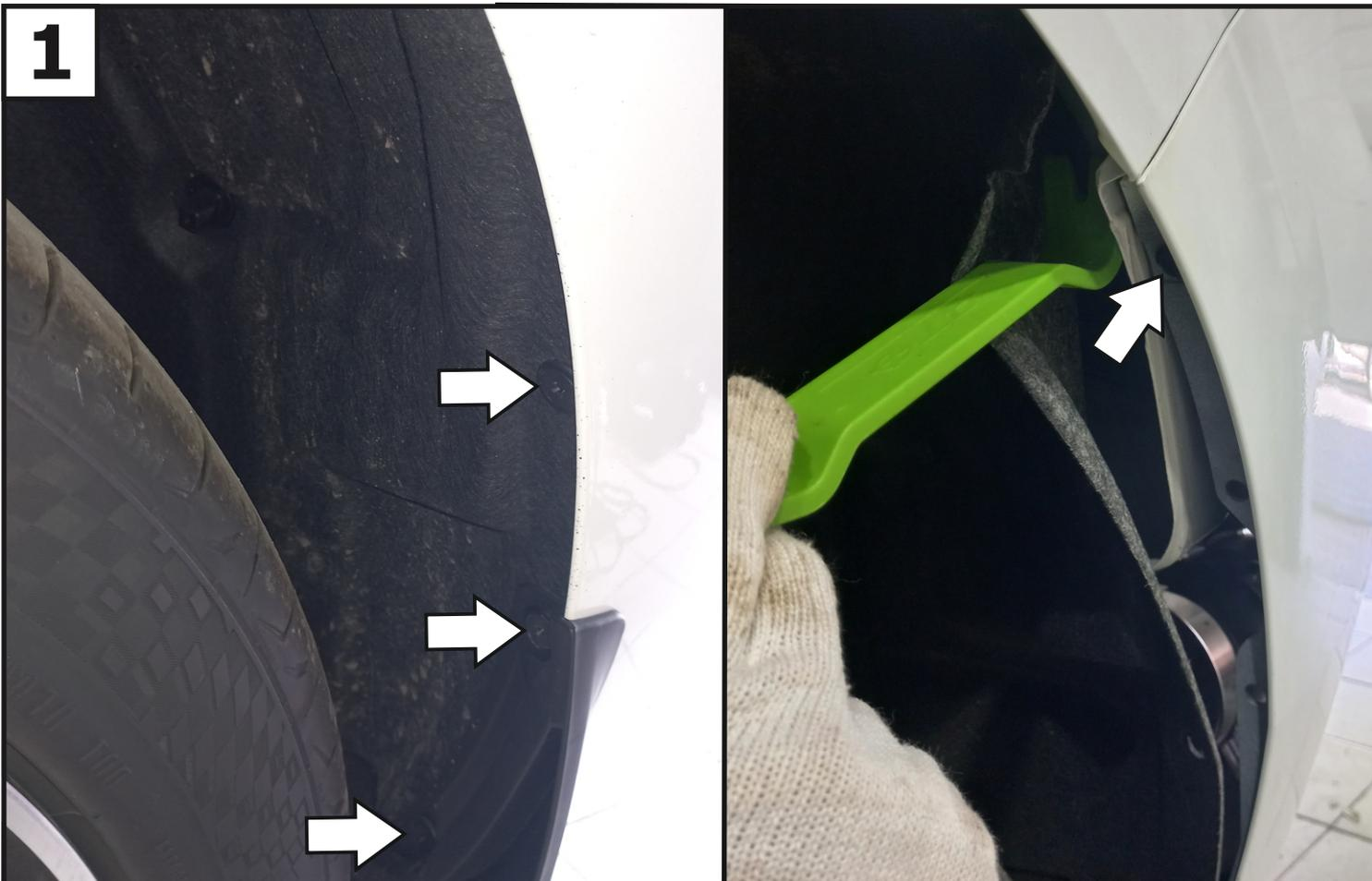
**Демонтировать клипсы крепления брызговика и подкрылка, отогнуть подкрылок и открутить винт крепления бампера. С другой стороны аналогично.**
