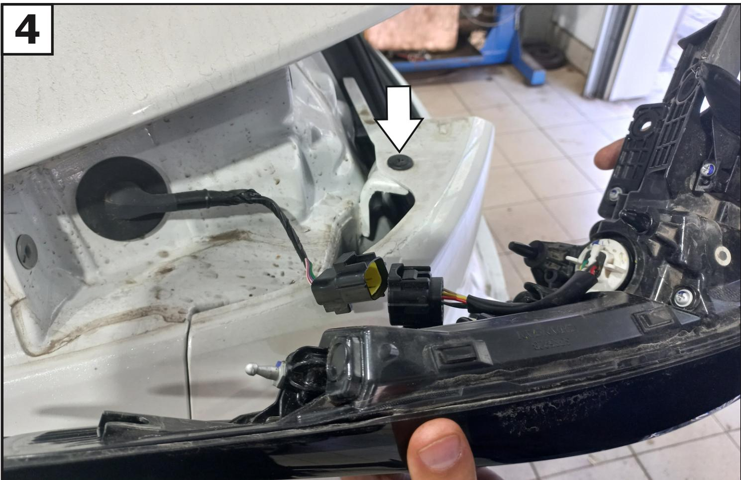
**Снять задний фонарь и демонтировать клипсу заднего бампера. С другой стороны аналогично.**
