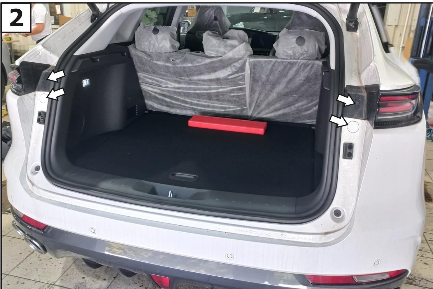
**Снять заглушки крепления фонарей и бампера.**
