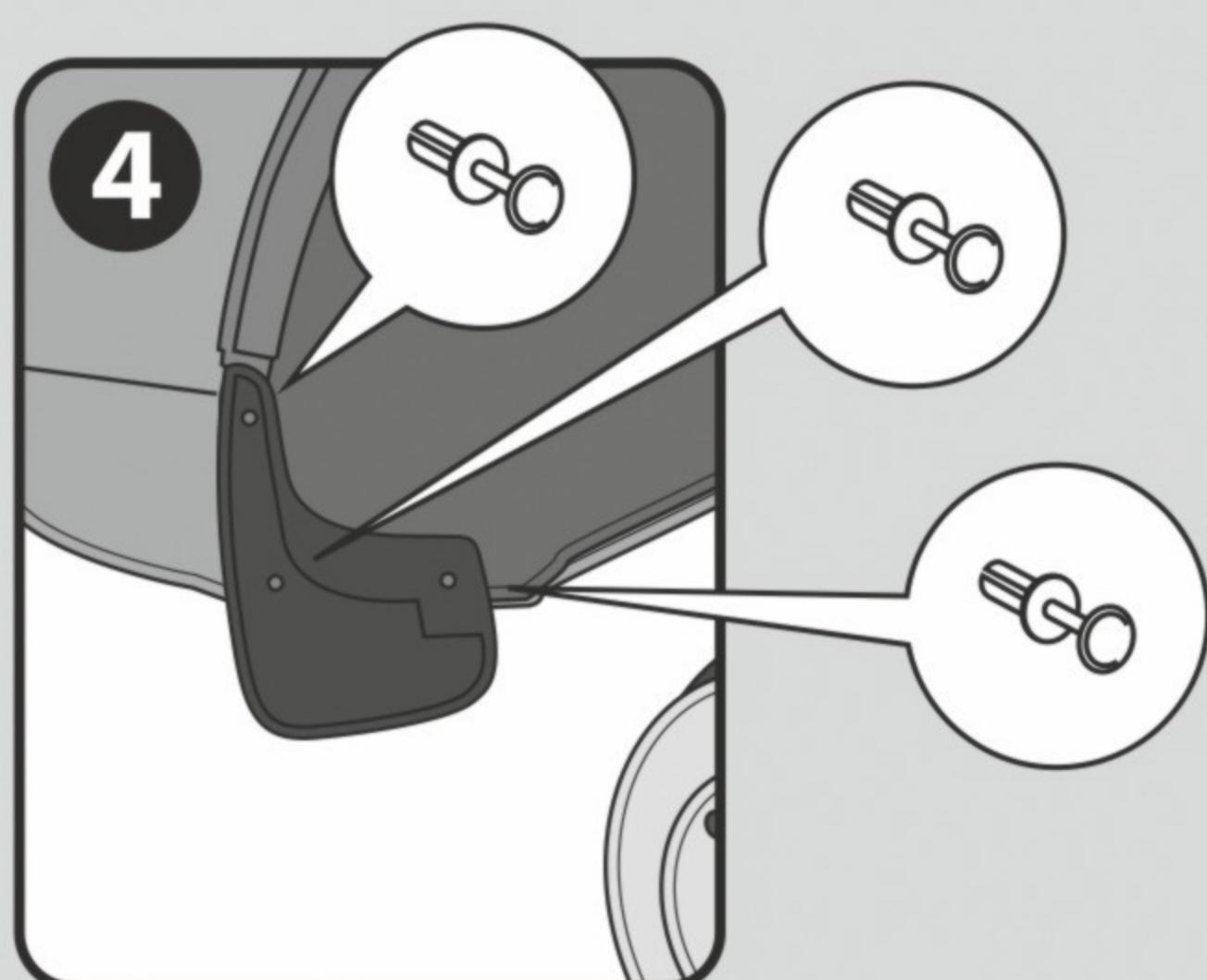
Установите крепежные элементы, согласно рисунку и надежно зафиксируйте их.
